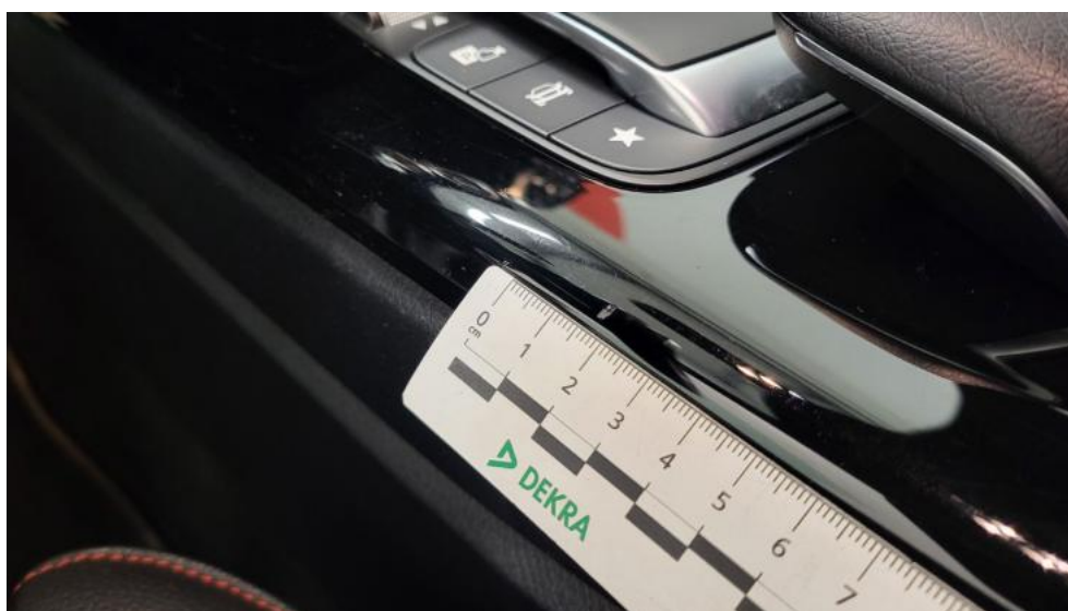
Photo 60. Konsola tunelu śr. - Rysa/odprysk 1
