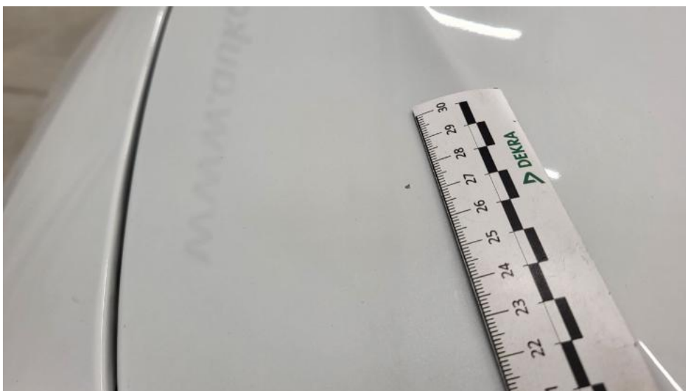
Photo 42. Pokrywa komory silnika - Rysa/odprysk 1
