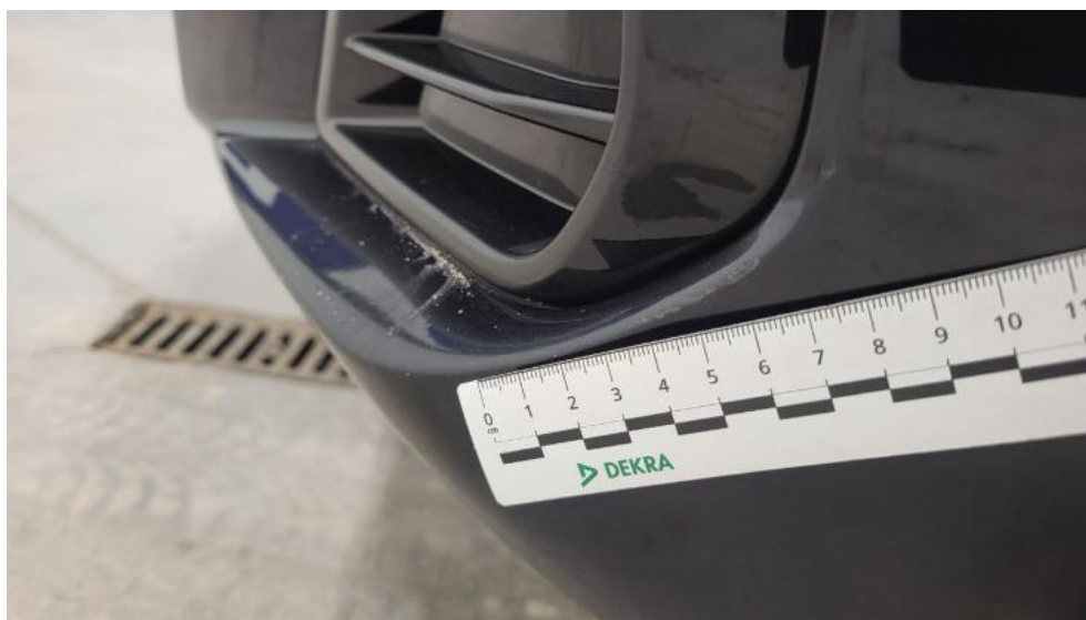
Fot. 41. Zderzak - Rysa/odprysk 1
