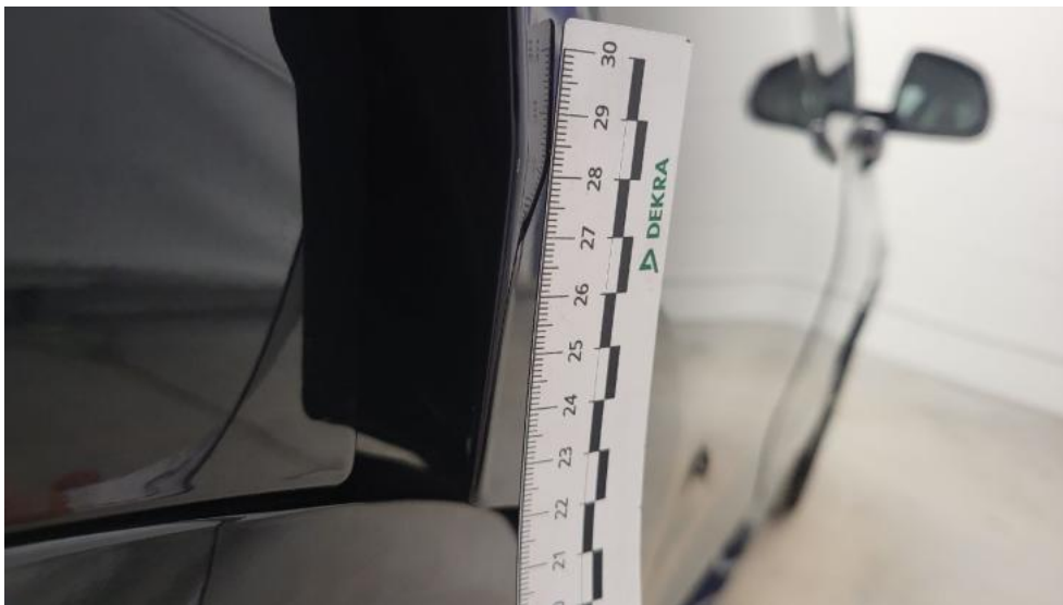
Fot. 45. Drzwi tylne P - Rysa/odprysk 1
