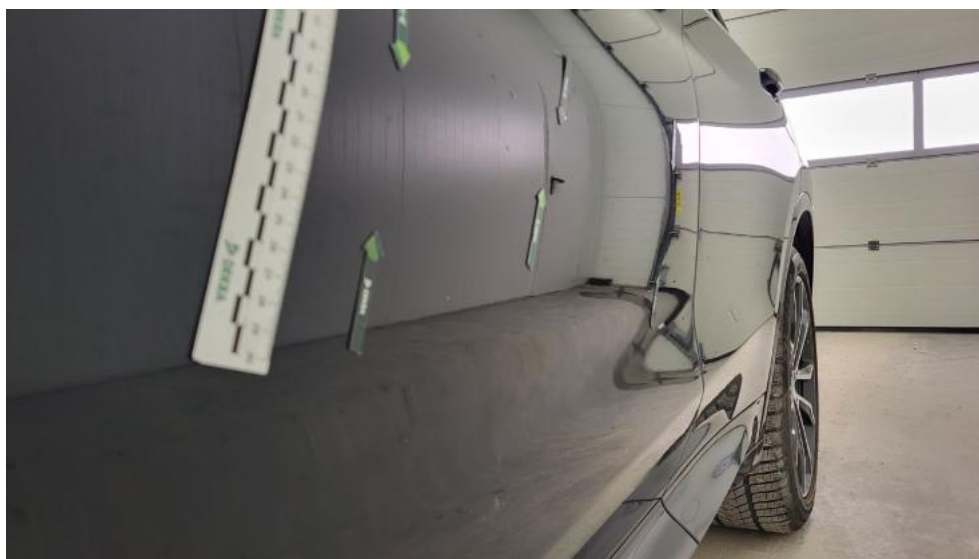
Fot. 55. Drzwi przed L - Wgniecenie/odkształcenie 1
