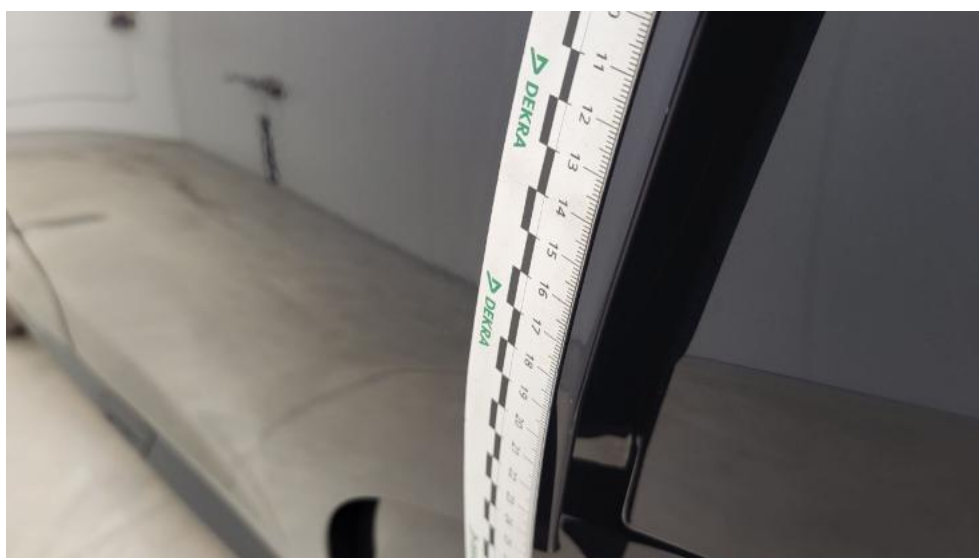
Fot. 56. Drzwi tylne L - Rysa/odprysk 1
