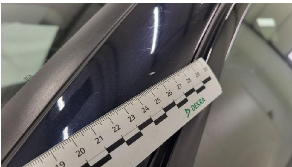
Fot. 58. Słupek przedni L - Rysa/odprysk 1
