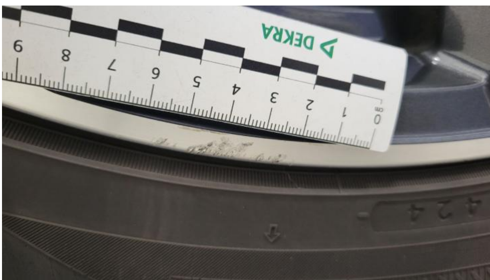
Photo 50. Felga aluminiowa przednia P - Rysa/odprysk 1
