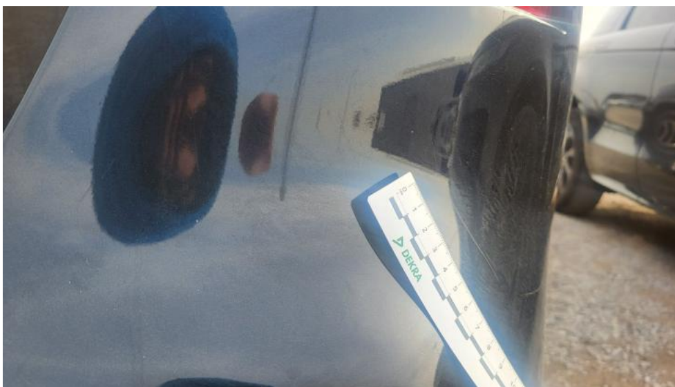
Photo 65. Zderzak tylny - Rysa/odprysk 1
