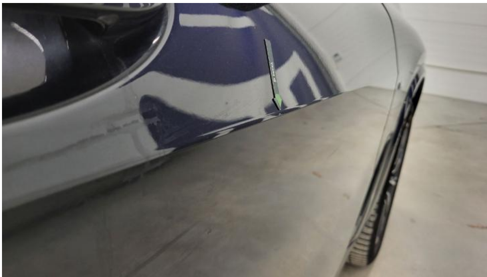
Photo 55. Drzwi przednie P - Wgniecenie/odkształcenie 1
