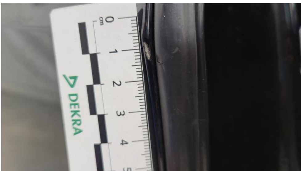
Photo 78. Uszczelka drzwi tylnych P - Rysa/odprysk 1
