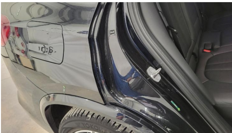
Photo 59. Błotnik tylny P / Ściana boczna P - Wgniecenie/odkształcenie 1
