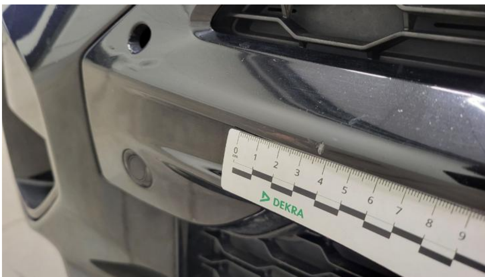
Photo 42. Kratka/zaślepka halogenu L - Rysa/odprysk 1
