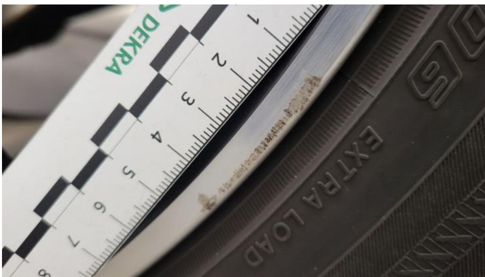
Photo 60. Felga aluminiowa tylna P - Rysa/odprysk 1
