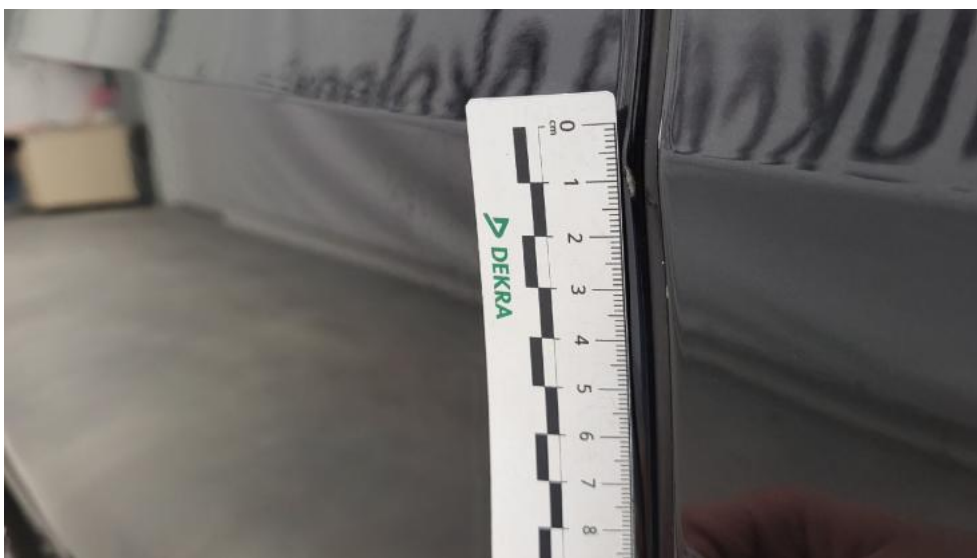
Photo 56. Drzwi tylne P - Rysa/odprysk 1
