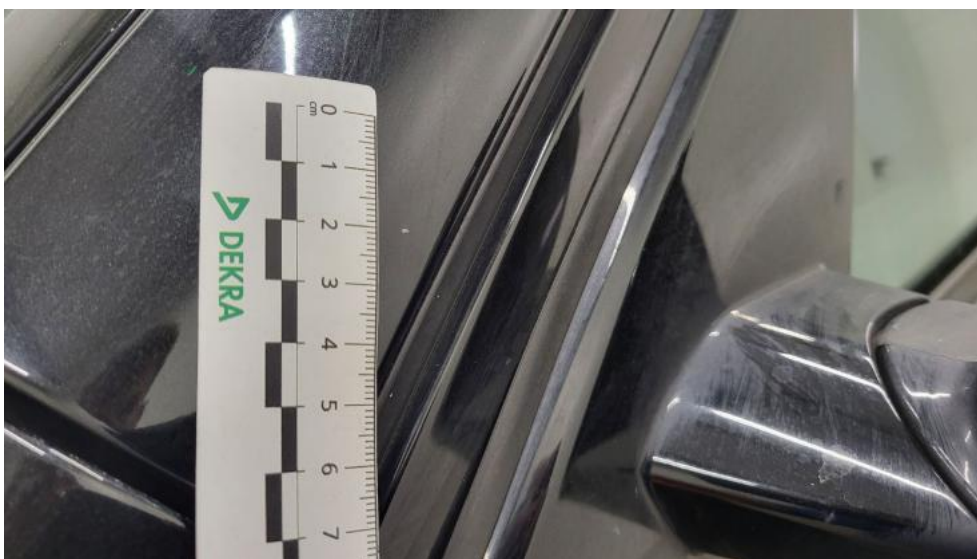
Photo 73. Stupek przedni L - Rysa/odprysk 1
