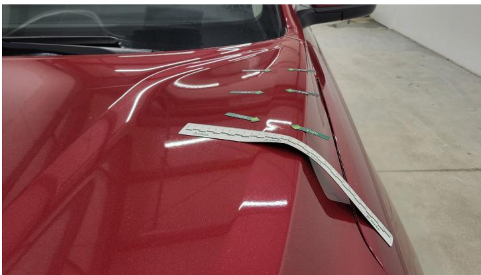
Photo 39. Pokrywa komory silnika - Wgniecenie/odkształcenie 2
