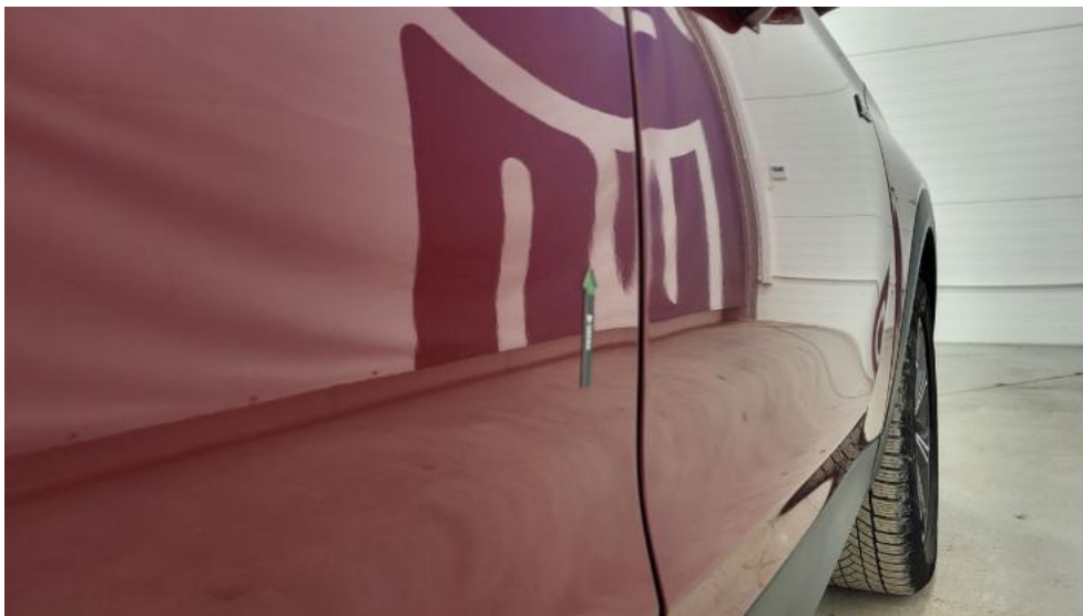
Photo 43. Drzwi tylne P - Wgniecenie/odkształcenie 1
