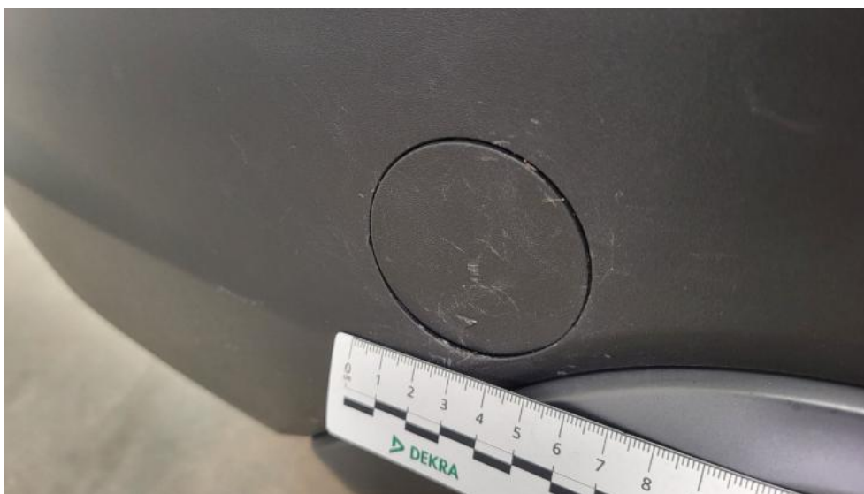
Photo 53. Zaślepka tyl haka hol. - Rysa/odprysk 1
