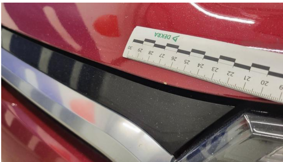
Photo 37. Pokrywa komory silnika - Rysa/odprysk 1
