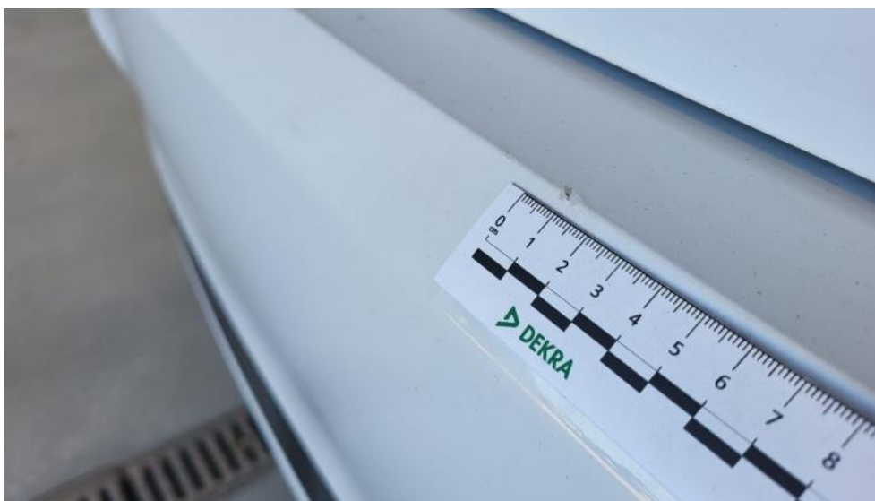
Photo 51. Zderzak tylny - Rysa/odprysk 1
