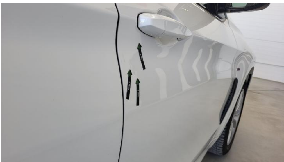
Photo 45. Drzwi przednie P - Wgniecenie/odkształcenie 1
