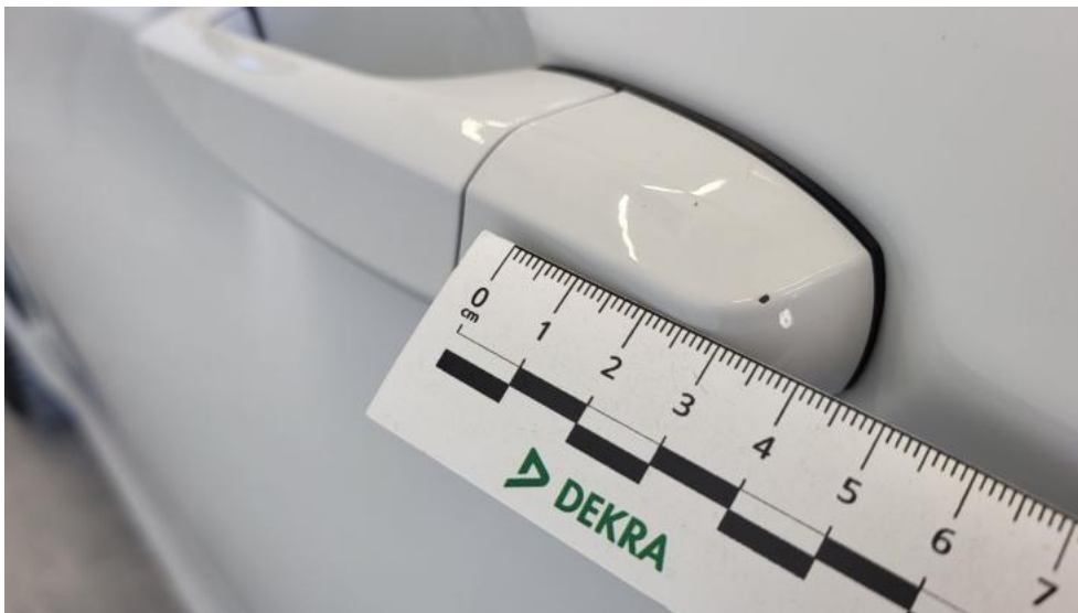
Photo 57. Klamka drzwi prz L - Rysa/odprysk 1
