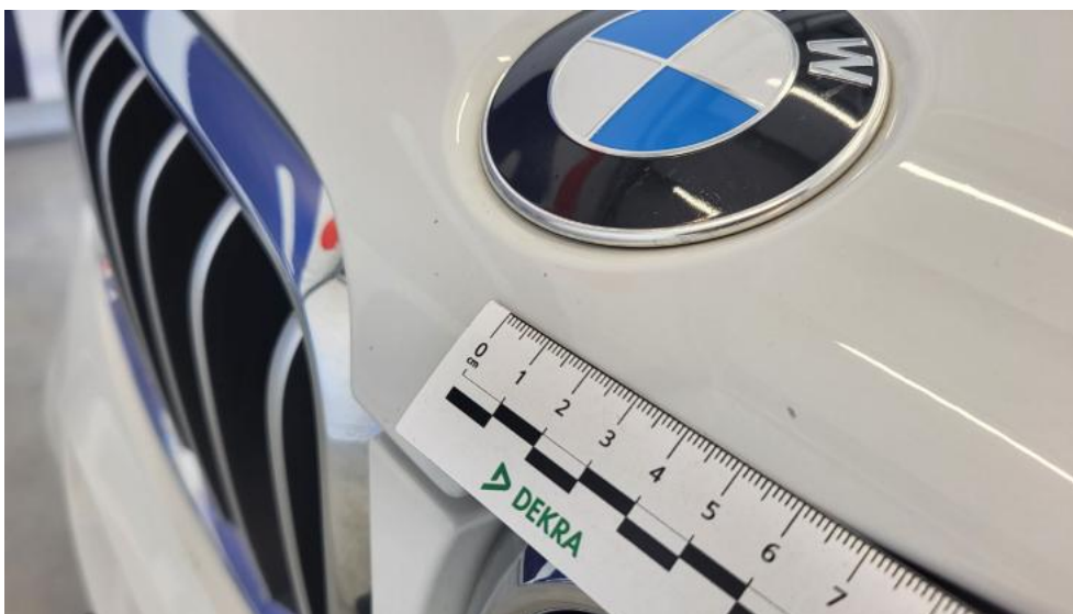
Photo 41. Pokrywa komory silnika - Rysa/odprysk 1
