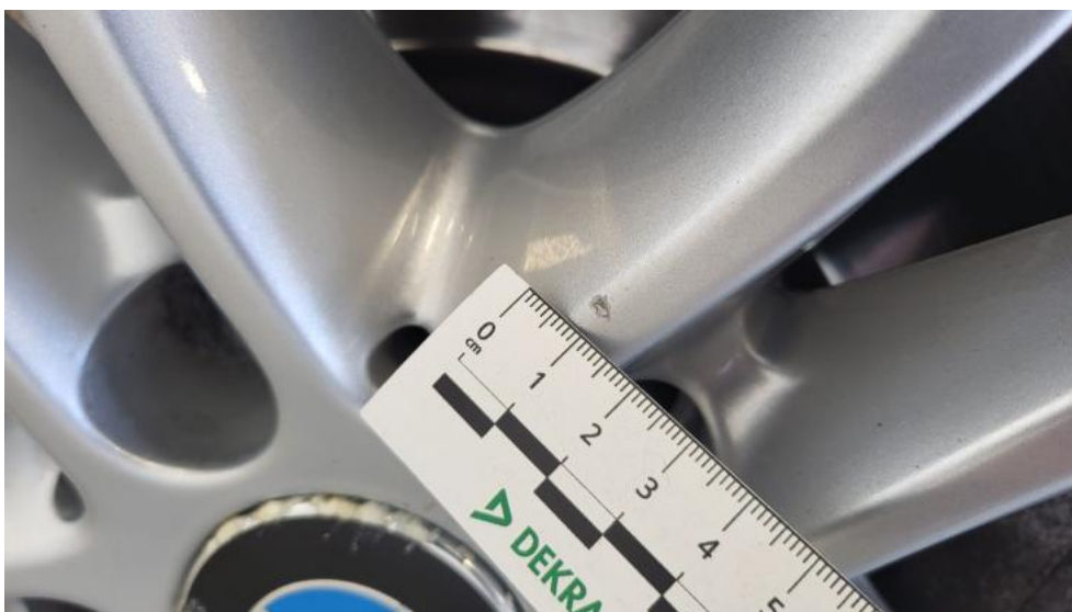
Photo 58. Felga Aluminiowa przednia L - Rysa/odprysk 1
