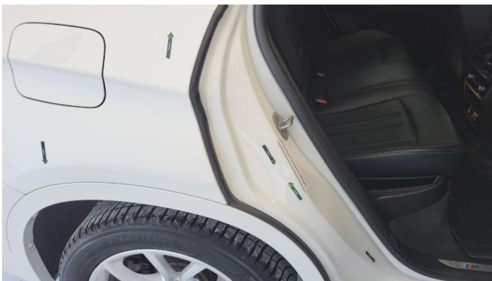
Photo 50. Błotnik tylny P / Ściana boczna P - Wgniecenie/odkształcenie 1
