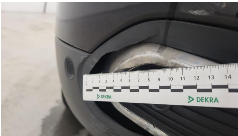
Fot. 72. Zderzak tylny cz dolna - Pęknięcie/rozerwanie 1
