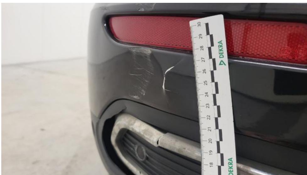
Fot. 70. Zderzak tylny - Pęknięcie/rozerwanie 2
