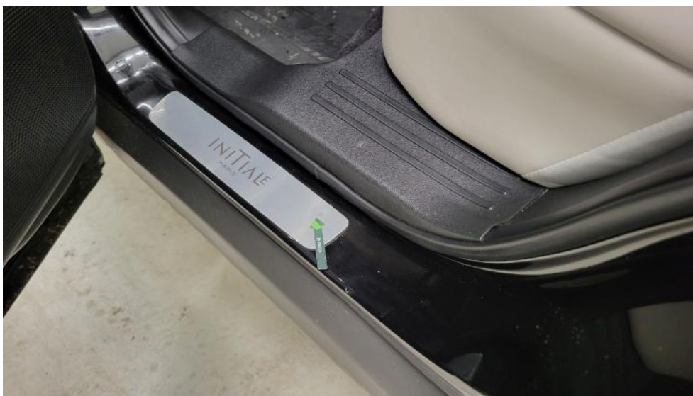
Fot. 79. Próg L - Wgniecenie/odkształcenie 1
