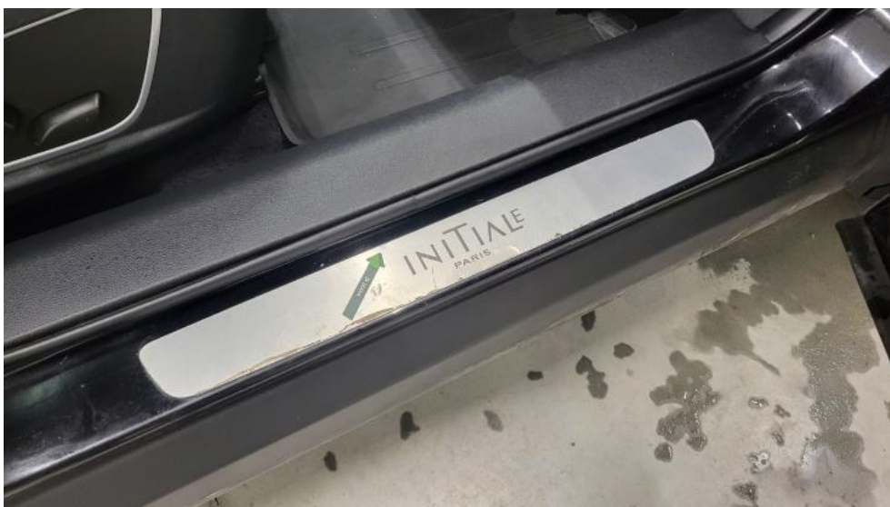
Fot. 56. Próg P - Wgniecenie/odkształcenie 1
