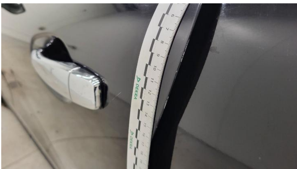
Fot. 76. Drzwi tylne L - Rysa/odprysk 1
