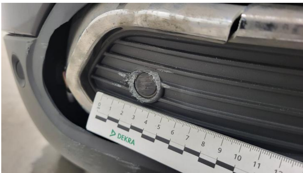
Fot. 62. Czujniki parkowania tył - Rysa/odprysk 1
