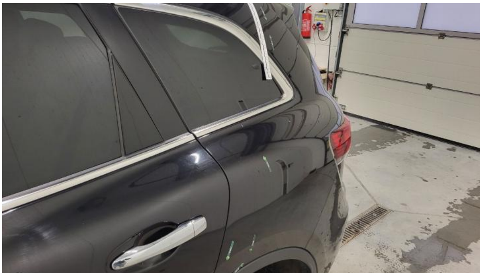
Fot. 73. Błotnik tylny L / Ściana boczna L - Wgniecenie/odkształcenie 1
