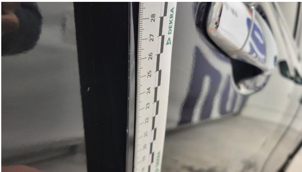
Fot. 53. Drzwi tylne P - Rysa/odprysk 1
