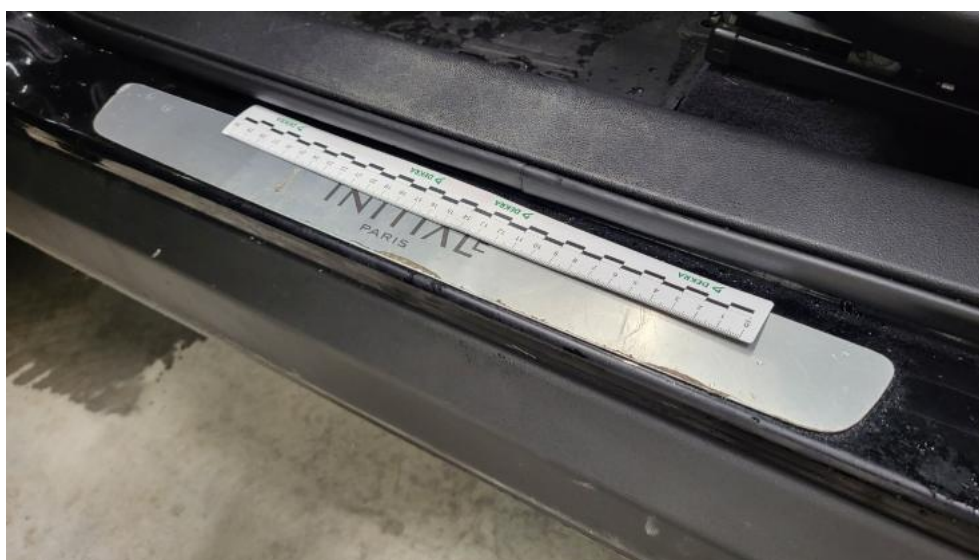
Fot. 78. Próg L - Rysa/odprysk 1
