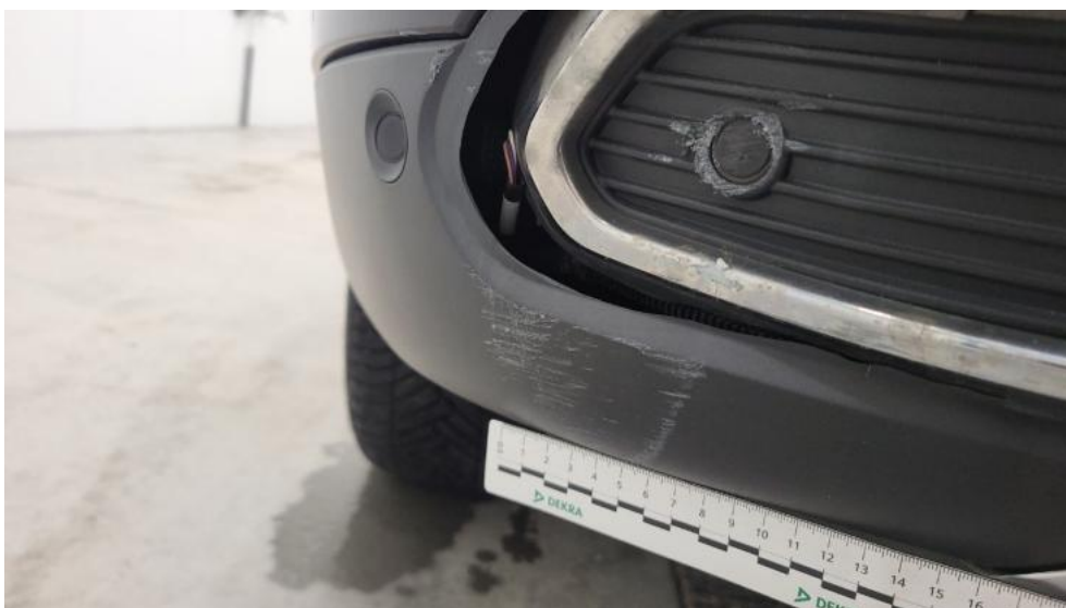
Fot. 71. Zderzak tylny cz dolna - Rysa/odprysk 1
