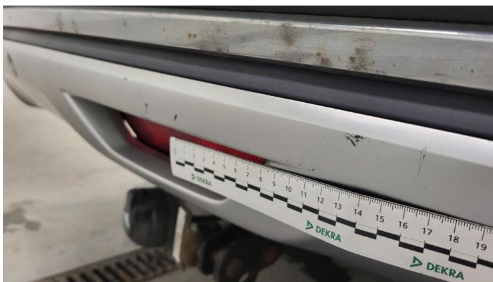
Fot. 66. Spojler zderzaka tylnego - Rysa/odprysk 1
