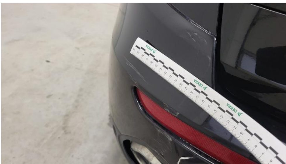
Fot. 67. Zderzak tylny - Rysa/odprysk 1
