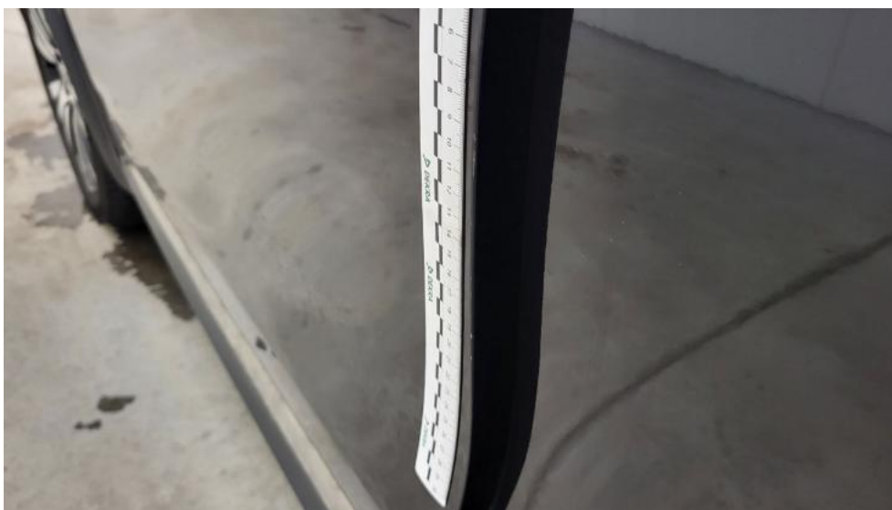
Fot. 75. Drzwi przed L - Rysa/odprysk 1
