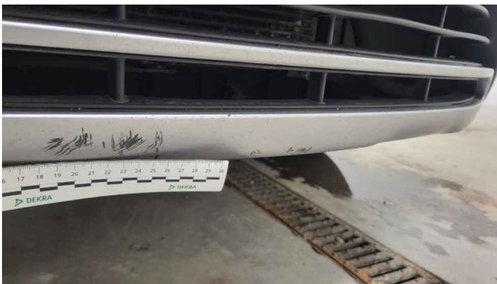
Fot. 47. Spoiler zderzaka przedniego - Rysa/odprysk 1
