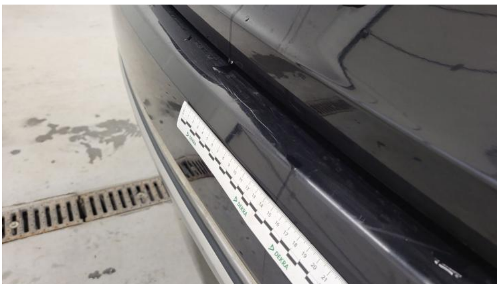
Fot. 68. Zderzak tylny - Wgniecenie/odkształcenie 1
