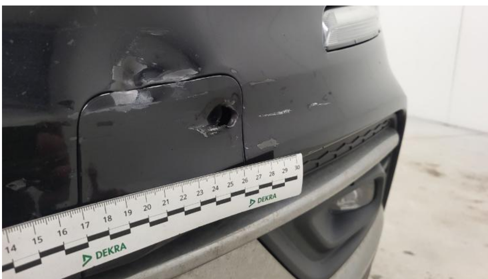
Fot. 48. Zaślepka prz haka hol. - Pęknięcie/rozerwanie 1
