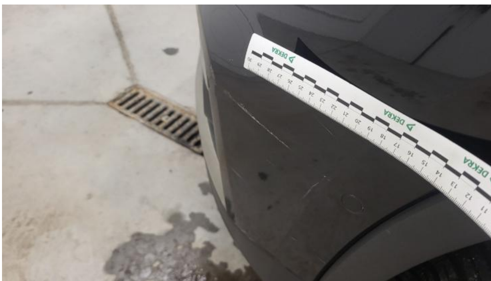
Fot. 49. Zderzak - Rysa/odprysk 1
