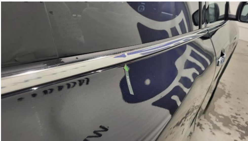
Fot. 55. Listwa drzwi tylnych P - Wgniecenie/odkształcenie 1
