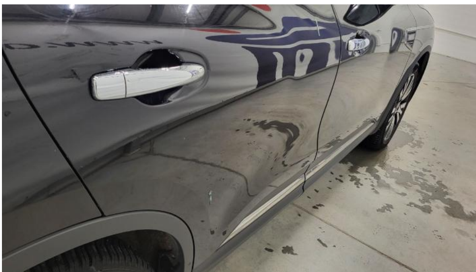
Fot. 54. Drzwi tylne P - Wgniecenie/odkształcenie 1
