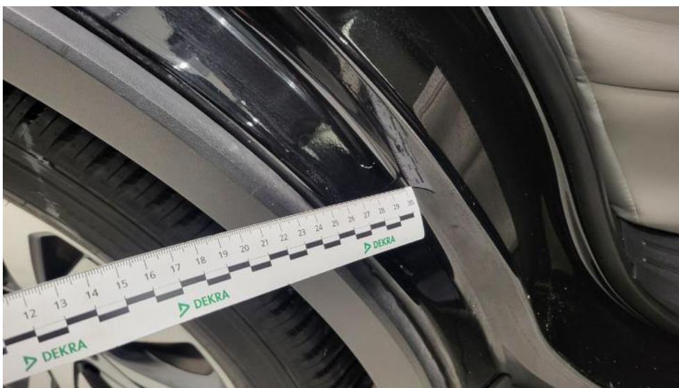
Fot. 58. Błotnik tylny P / Ściana boczna P - Rysa/odprysk 1
