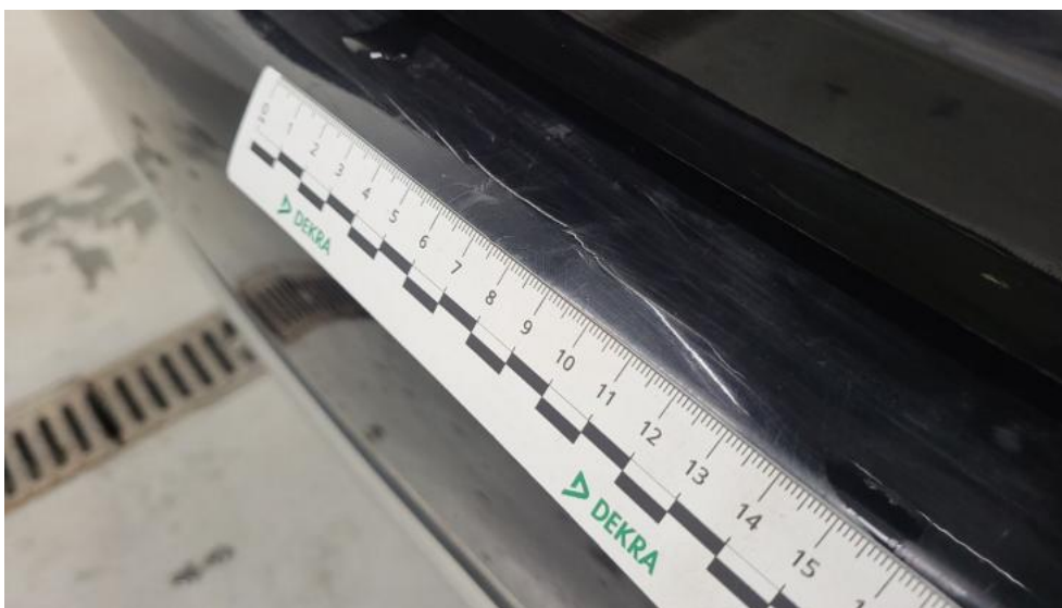
Fot. 69. Zderzak tylny - Pęknięcie/rozerwanie 1
