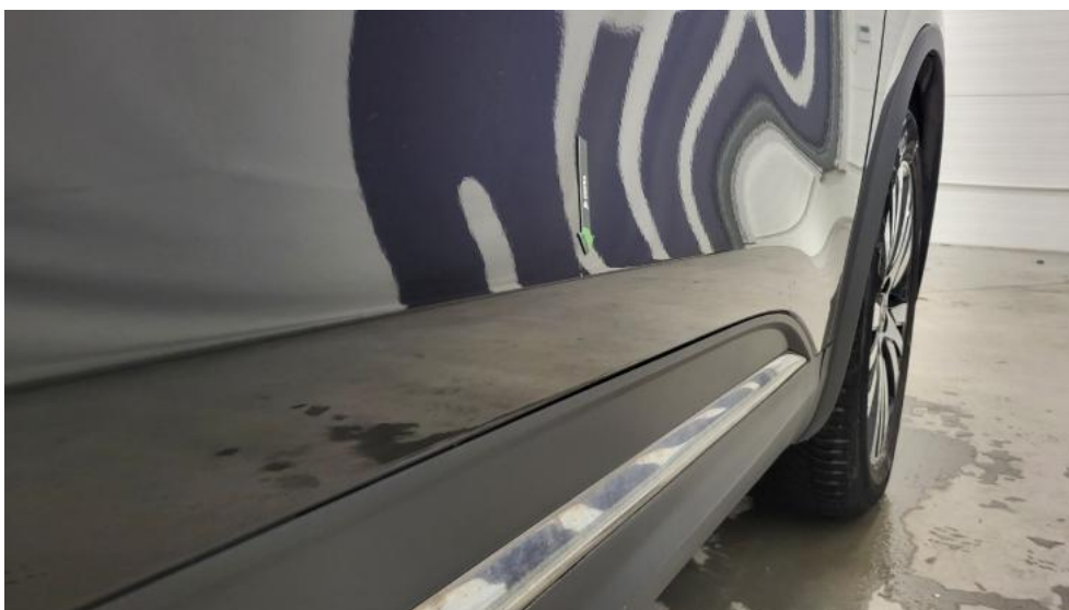
Fot. 52. Drzwi przednie P - Wgniecenie/odkształcenie 1
