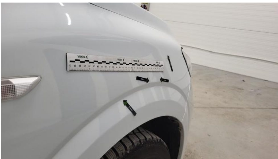
Photo 41. Błotnik przedni P - Wgniecenie/odkształcenie 1
