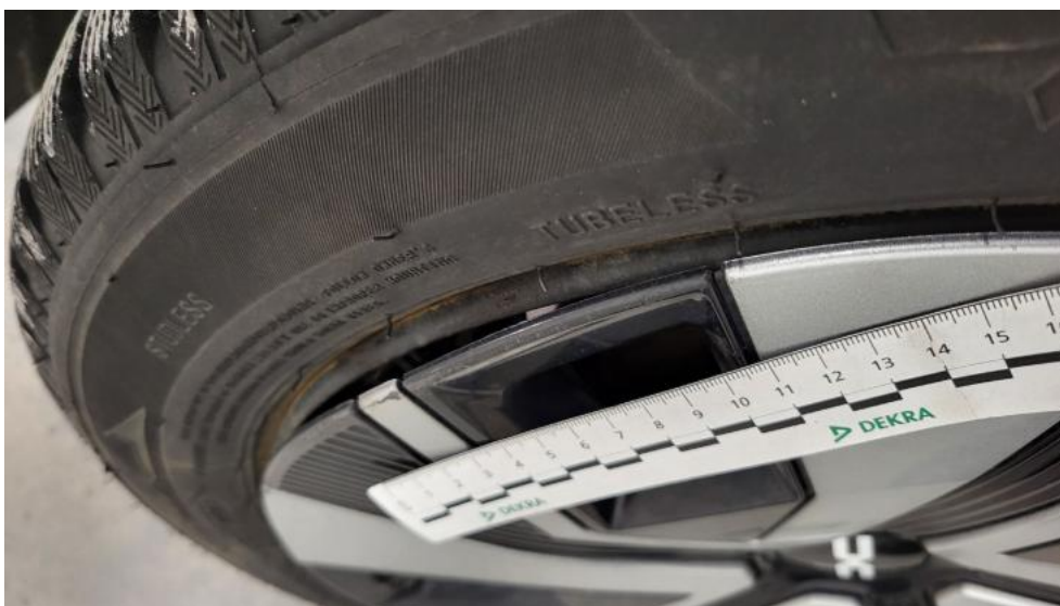
Photo 47. Kołpak tylny P - Wgniecenie/odkształcenie 1
