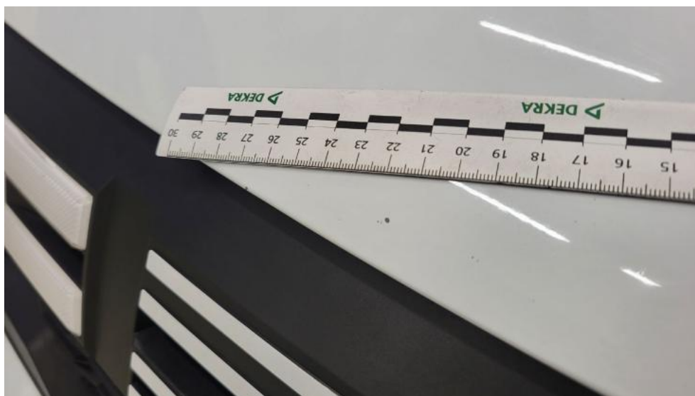
Photo 40. Pokrywa komory silnika - Rysa/odprysk 1
