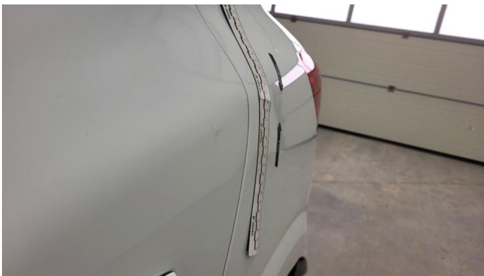
Photo 51. Błotnik tylny L / Ściana boczna L - Wgniecenie/odkształcenie 1
