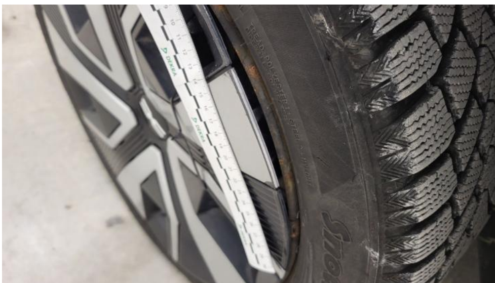
Photo 59. Kołpak przedni L - Wgniecenie/odkształcenie 1
