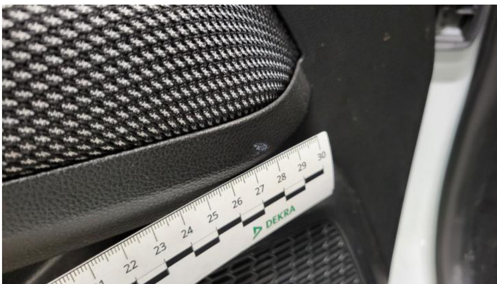
Photo 66. Tapicerka drzwi przednich L - Rysa/odprysk 1
