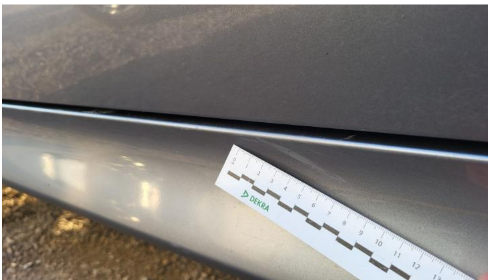
Fot. 73. Próg L - Rysa/odprysk 1
