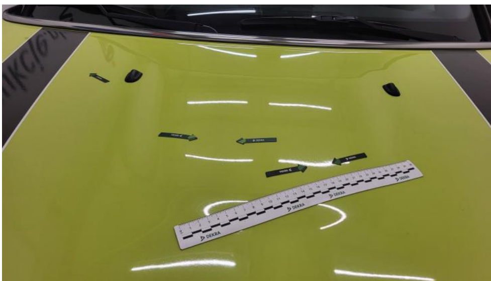
Photo 49. Pokrywa komory silnika - Wgniecenie/odkształcenie 2
