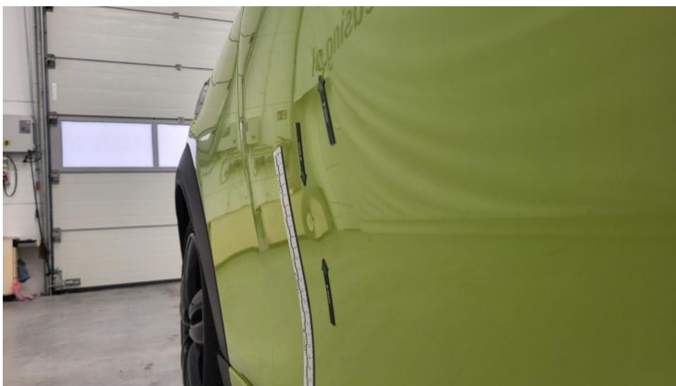
Photo 59. Drzwi przednie P - Wgniecenie/odkształcenie 1
