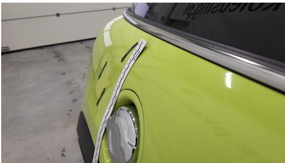
Photo 62. Błotnik tylny P / Ściana boczna P - Wgniecenie/odkształcenie 2
