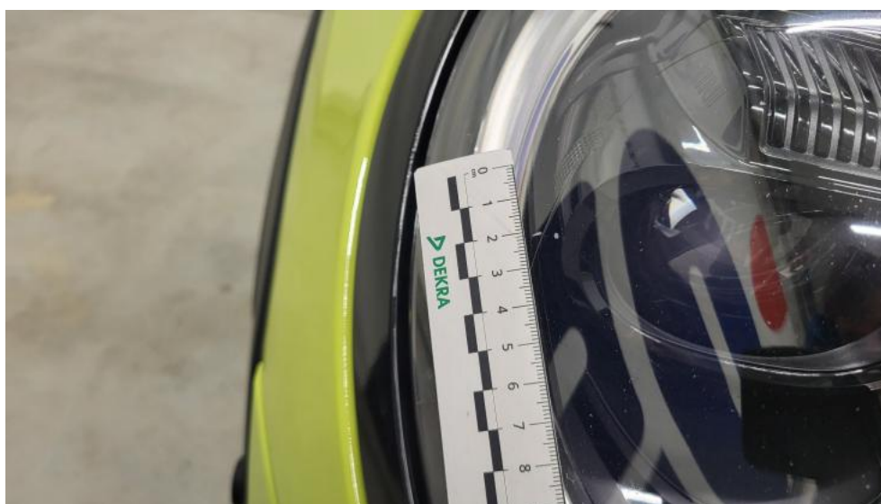
Photo 56. Reflektor P - Rysa/odprysk 1
