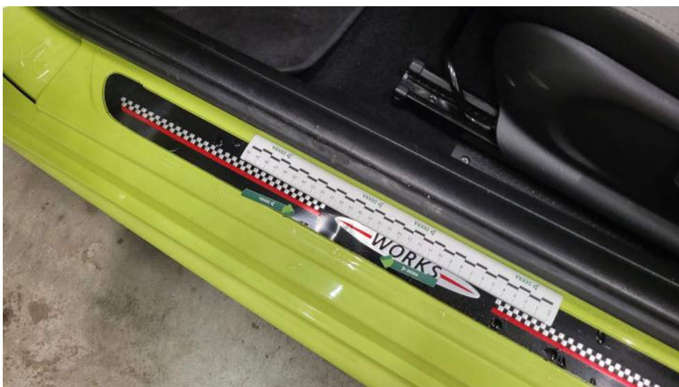
Photo 76. Próg L - Wgniecenie/odkształcenie 1
