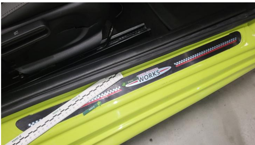
Photo 60. Próg P - Wgniecenie/odkształcenie 1
