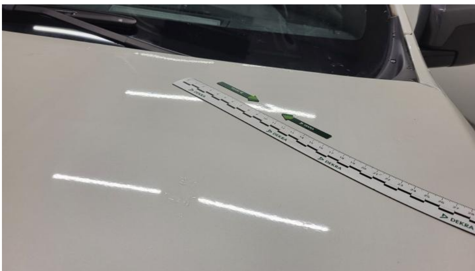
Photo 40. Pokrywa komory silnika - Wgniecenie/odkształcenie 1
