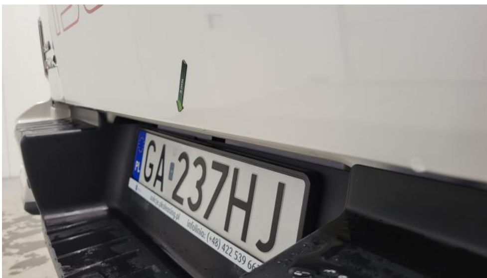
Photo 50. Pokrywy bagażnika - Wgniecenie/odkształcenie 1
