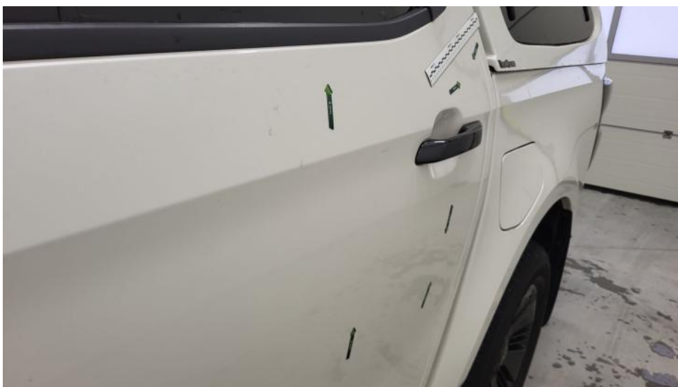
Photo 56. Drzwi tylne L - Wgniecenie/odkształcenie 1
