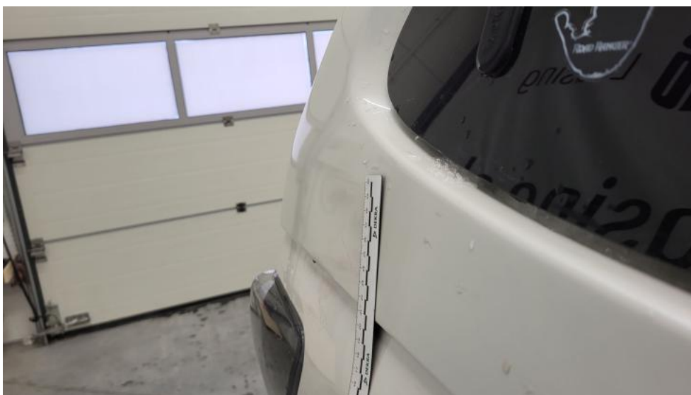
Photo 47. Błotnik tylny P / Ściana boczna P - Wgniecenie/odkształcenie 1
