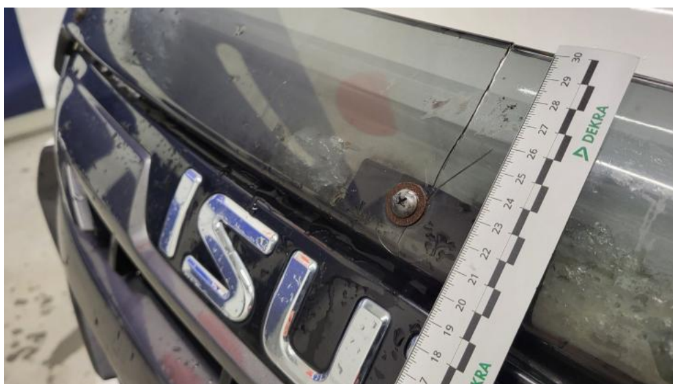
Photo 38. Listwa śr zderzaka przedniego - Pęknięcie/rozerwanie 1
