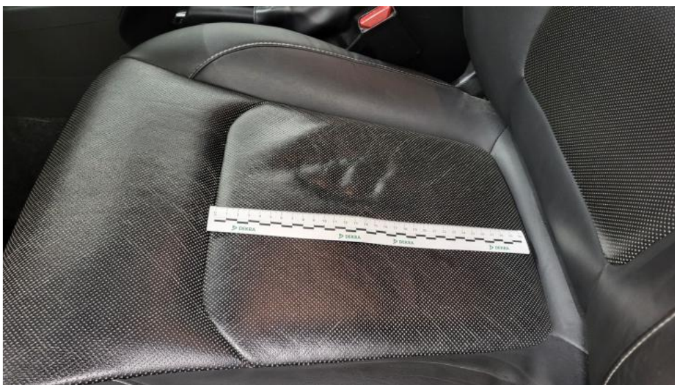
Photo 58. Fotel prz. lew. - Wgniecenie/odkształcenie 1
