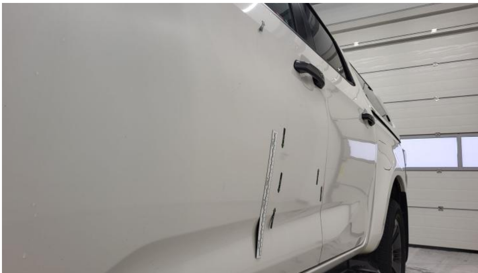
Photo 55. Drzwi przed L - Wgniecenie/odkształcenie 1
