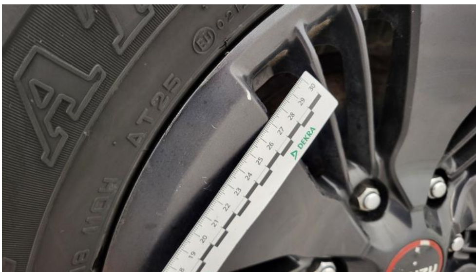
Photo 53. Felga aluminiowa tylna L - Rysa/odprysk 1
