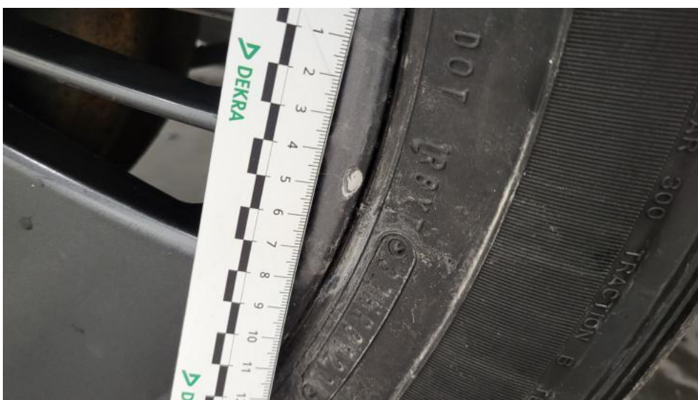
Photo 48. Felga aluminiowa tylna P - Rysa/odprysk 1
