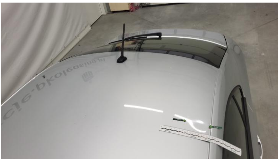
Fot. 62. Dach - Wgniecenie/odkształcenie 1
