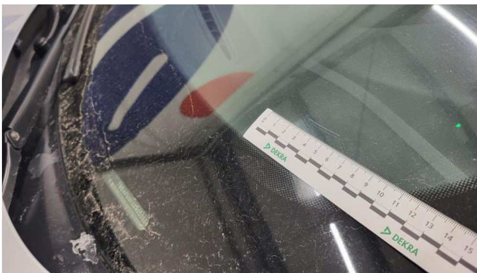
Fot. 41. Szyba czołowa - Rysa/odprysk 1
