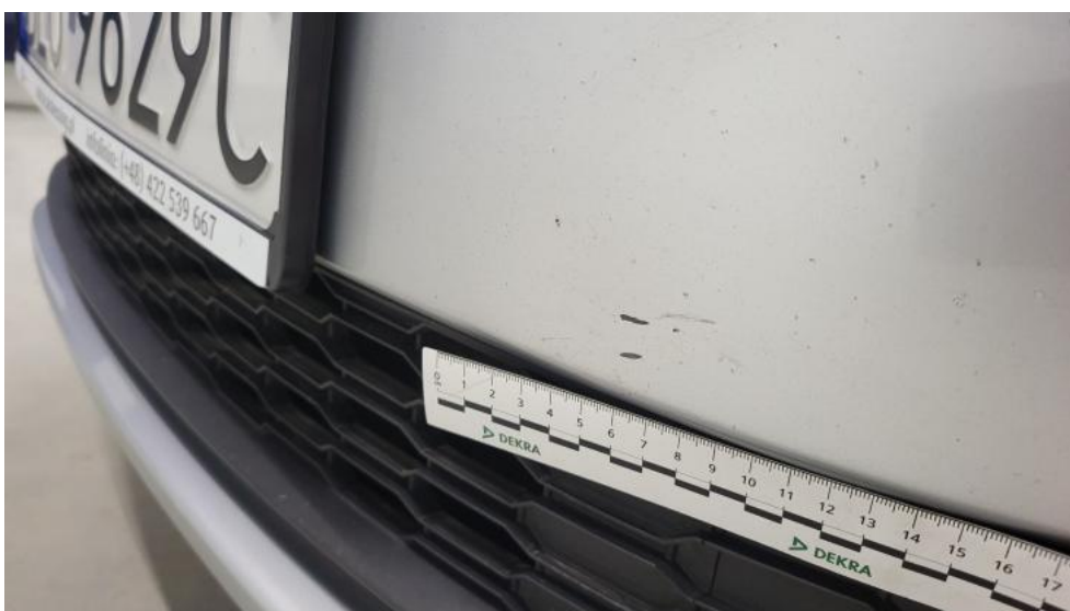
Fot. 42. Zderzak - Rysa/odprysk 1
