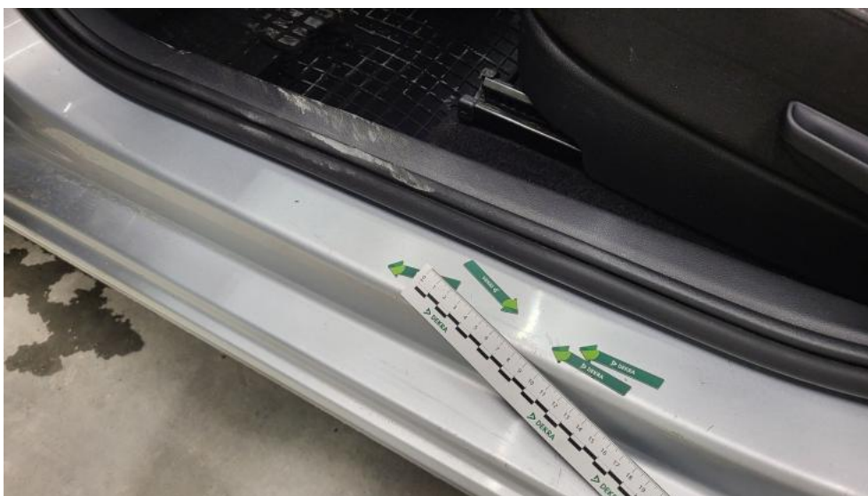
Fot. 75. Próg L - Wgniecenie/odkształcenie 1
