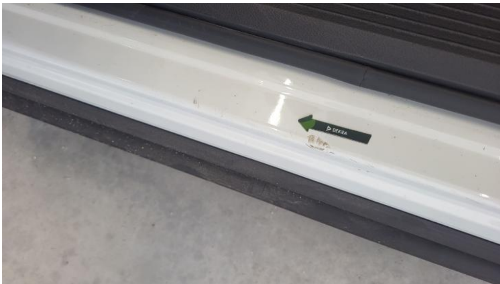
Photo 45. Próg L - Wgniecenie/odkształcenie 1
