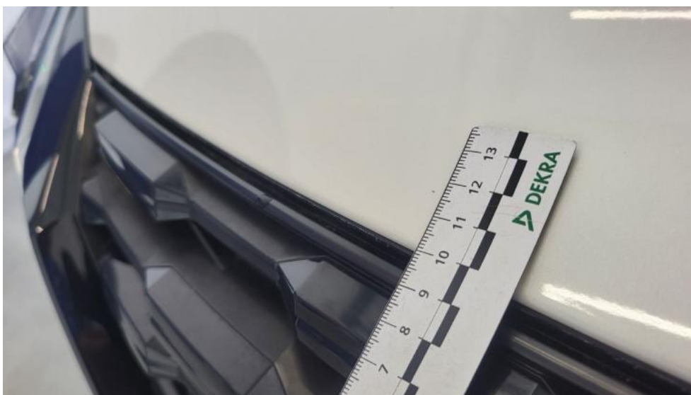
Photo 42. Pokrywa komory silnika - Rysa/odprysk 1
