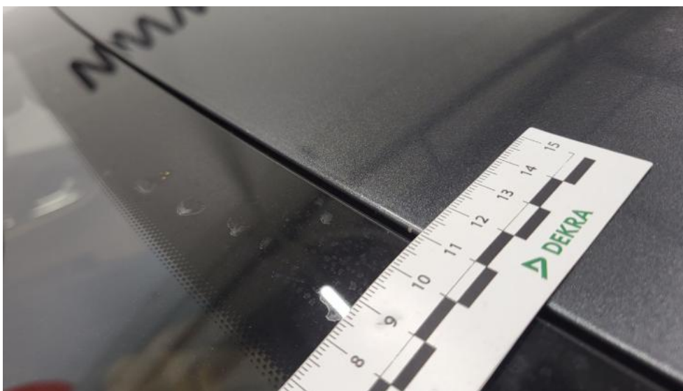
Fot. 57. Dach - Rysa/odprysk 1
