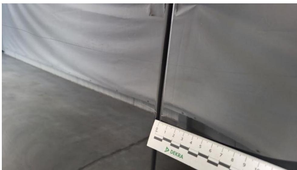
Fot. 54. Błotnik przedni P - Rysa/odprysk 2
