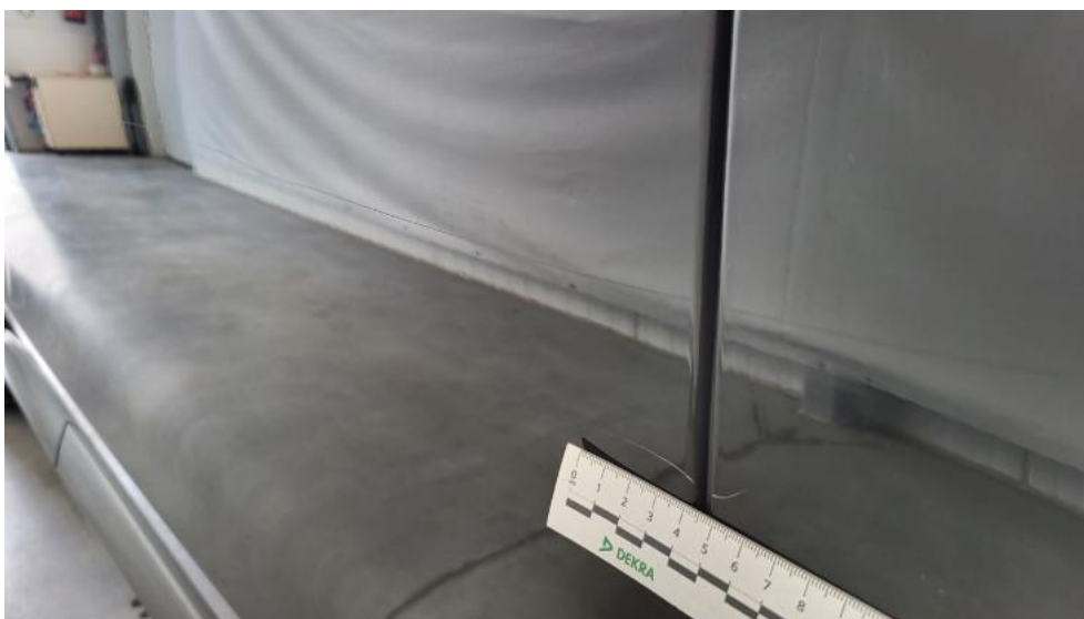
Fot. 56. Drzwi przednie P - Rysa/odprysk 1
