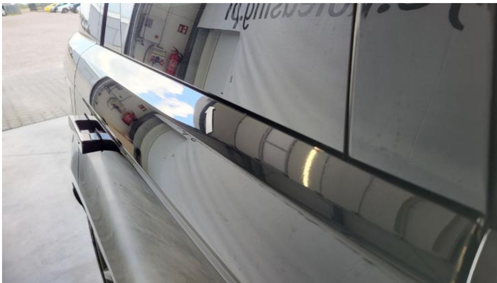
Fot. 59. Drzwi tylne P - Wgniecenie/odkształcenie 1
