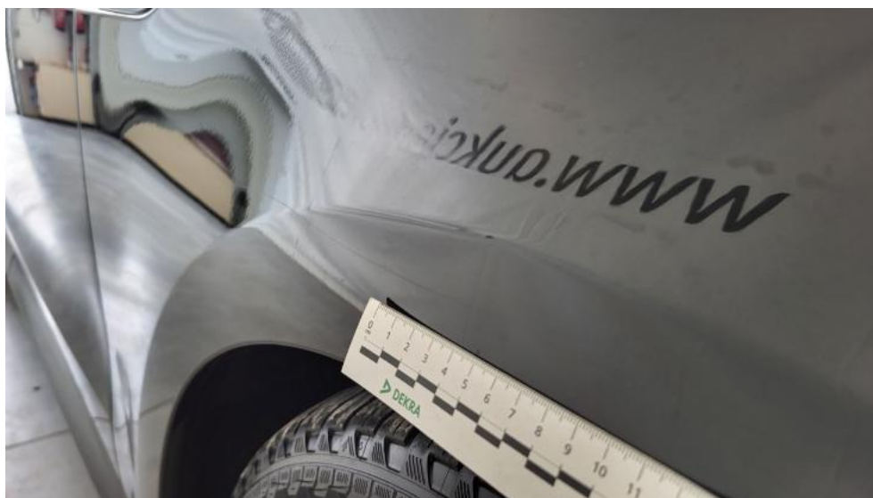
Fot. 53. Błotnik przedni P - Rysa/odprysk 1
