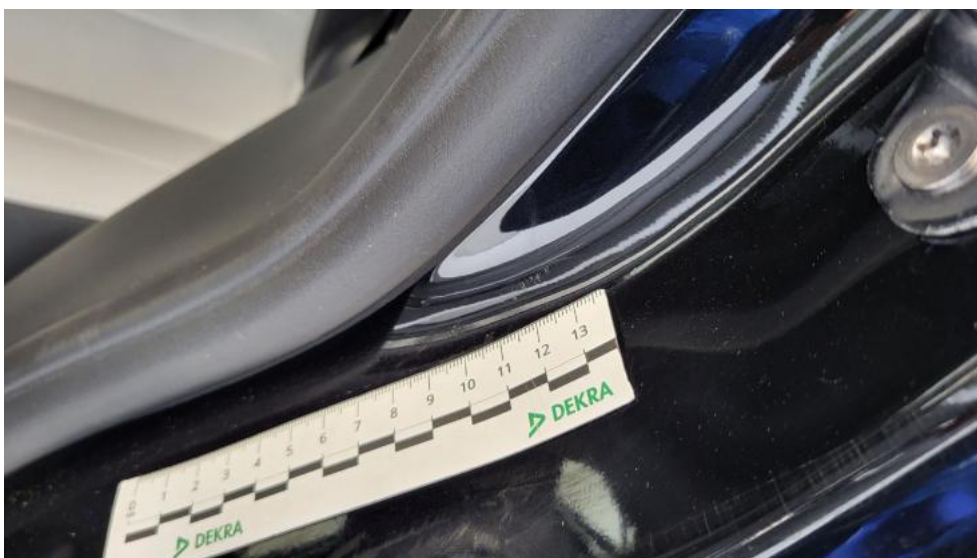
Fot. 60. Błotnik tylny L / Ściana boczna L - Rysa/odprysk 1
