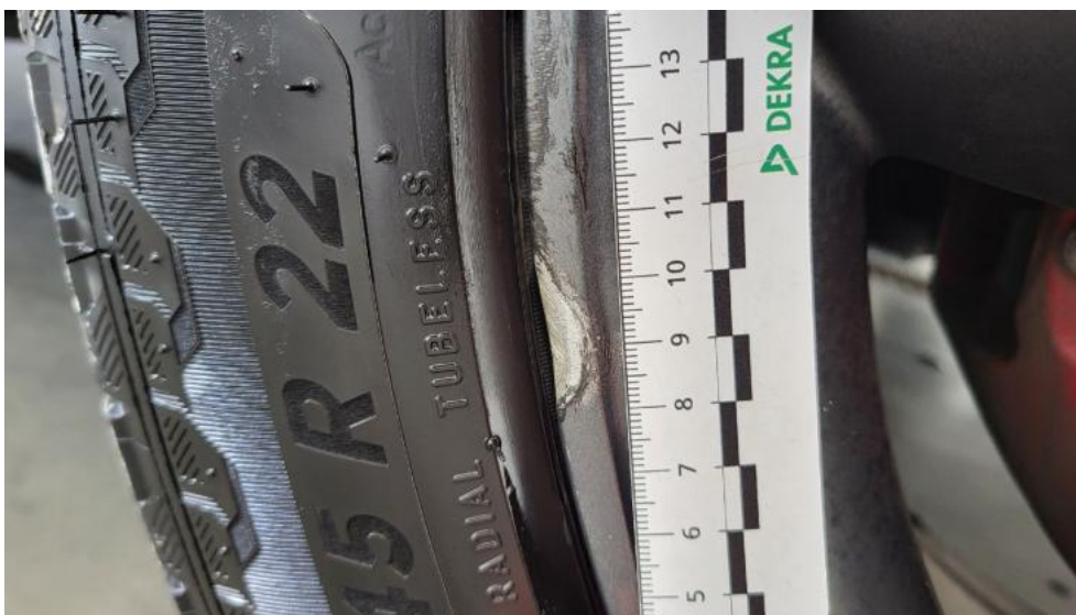
Fot. 55. Felga aluminiowa przednia P - Rysa/odprysk 1
