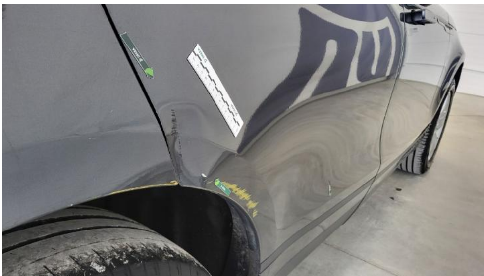
Photo 50. Drzwi tylne P - Wgniecenie/odkształcenie 1
