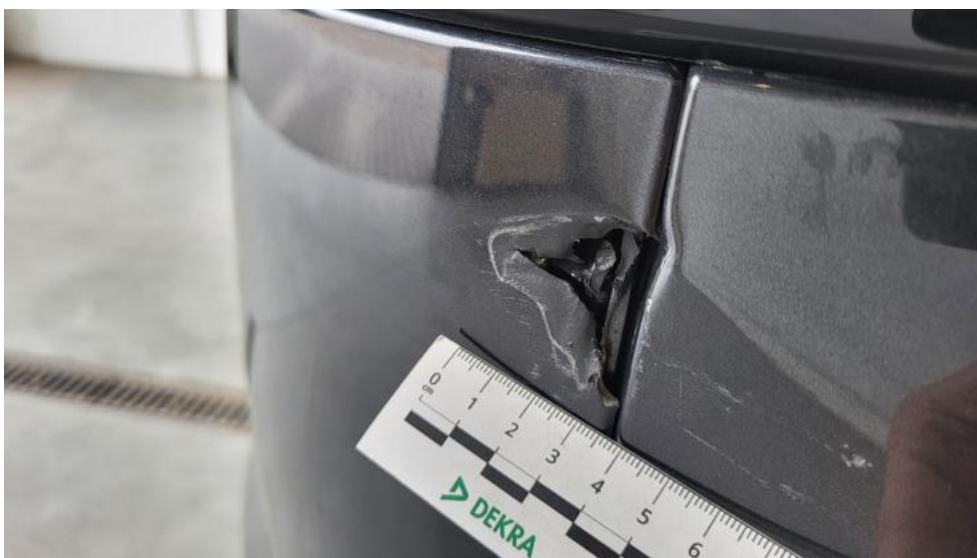
Photo 64. Zderzak tylny cz P - Pęknięcie/rozerwanie 1
