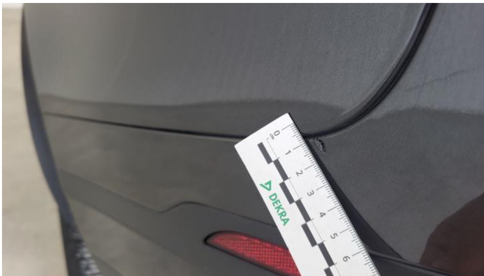
Photo 63. Zderzak tylny cz L - Pęknięcie/rozerwanie 1
