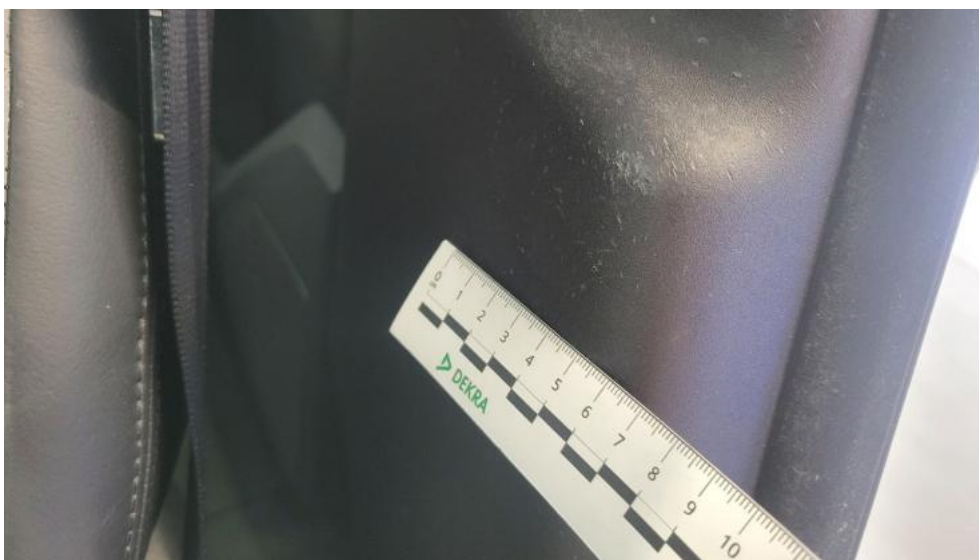
Photo 78. Wykładzina(y) słupka środkowego L - Rysa/odprysk 1
