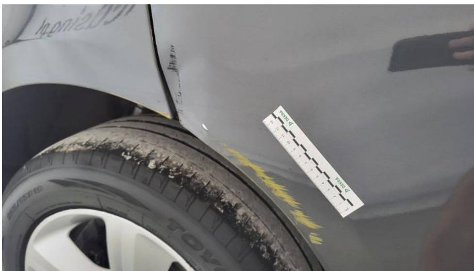
Photo 49. Drzwi tylne P - Rysa/odprysk 1
