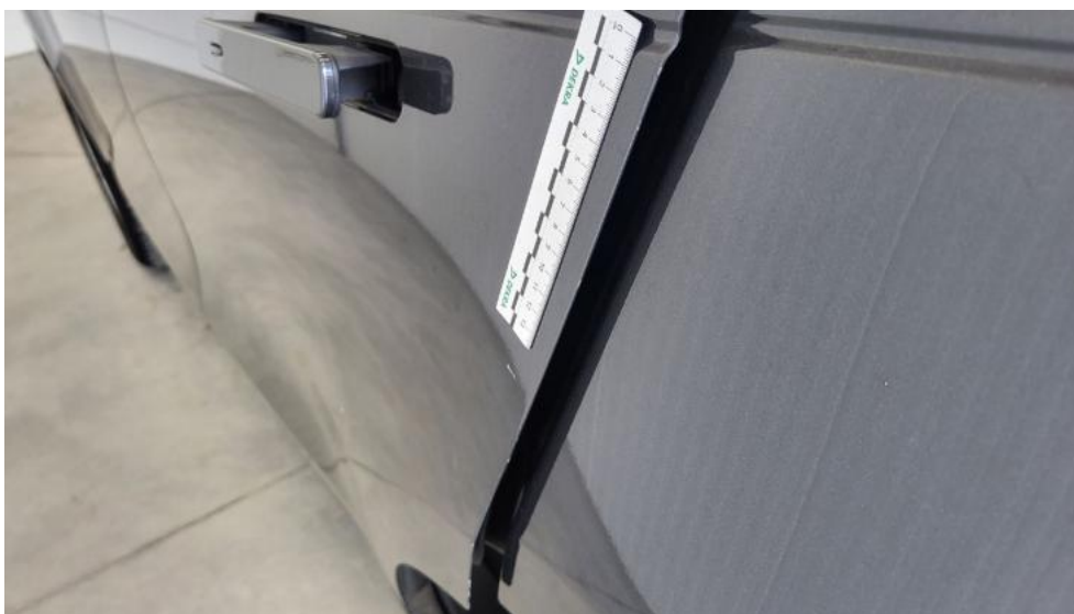
Photo 67. Drzwi tylne L - Rysa/odprysk 1
