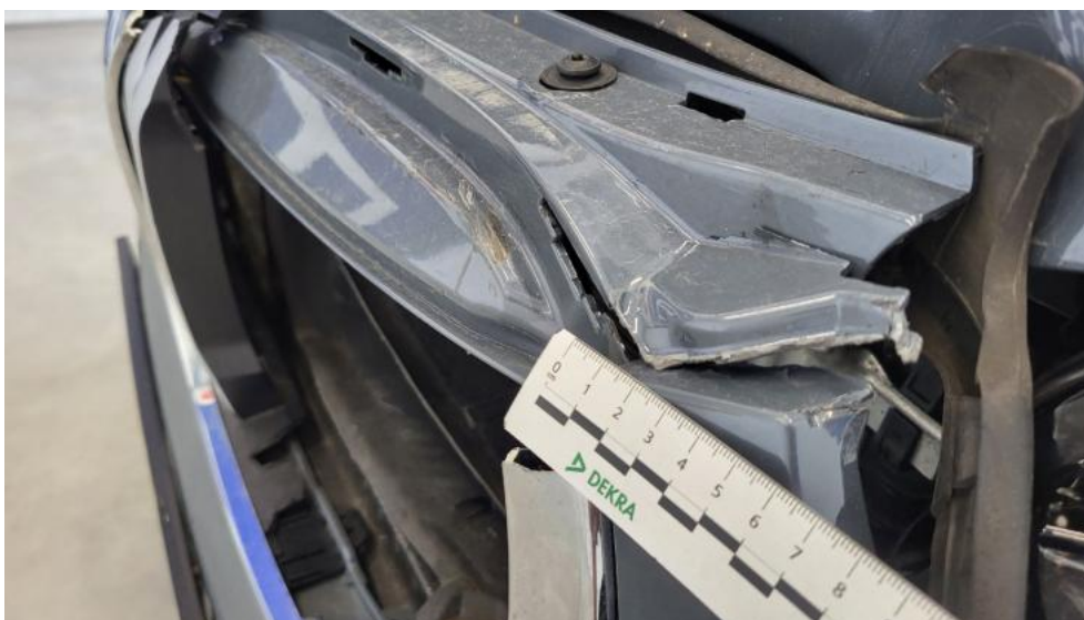
Fot. 57. Zderzak - Pęknięcie/rozerwanie 1
