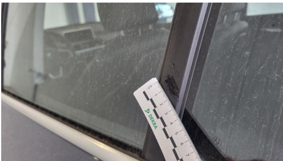
Fot. 78. Listwa drzwi tylnych L - Rysa/odprysk 1
