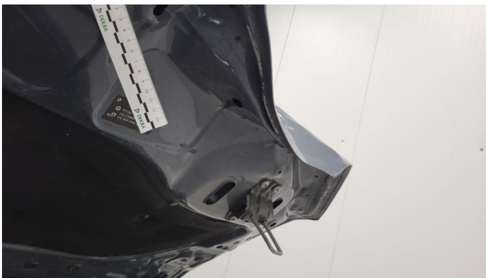
Fot. 51. Pokrywa komory silnika - Wgniecenie/odkształcenie 1
