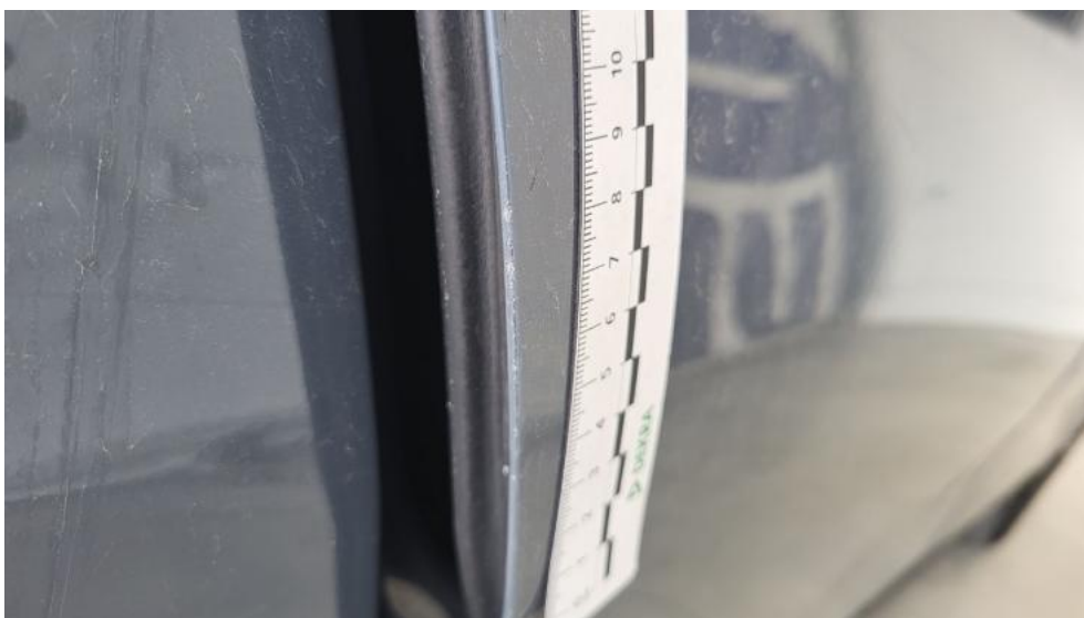
Fot. 64. Drzwi tylne P - Rysa/odprysk 1
