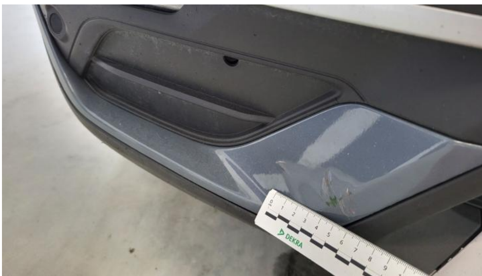
Fot. 55. Zderzak - Rysa/odprysk 1
