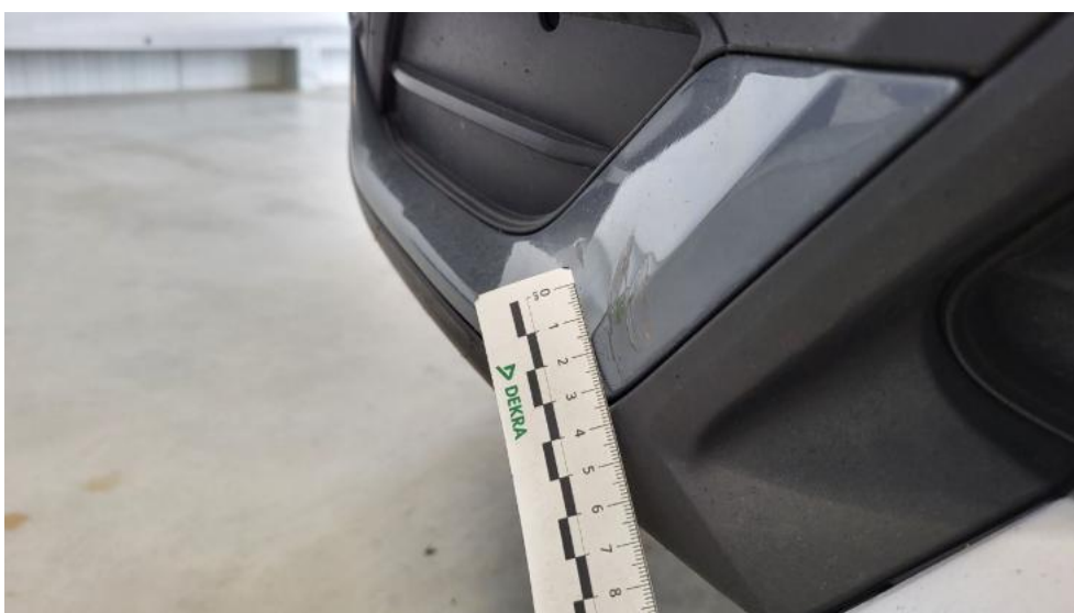
Fot. 56. Zderzak - Wgniecenie/odkształcenie 1
