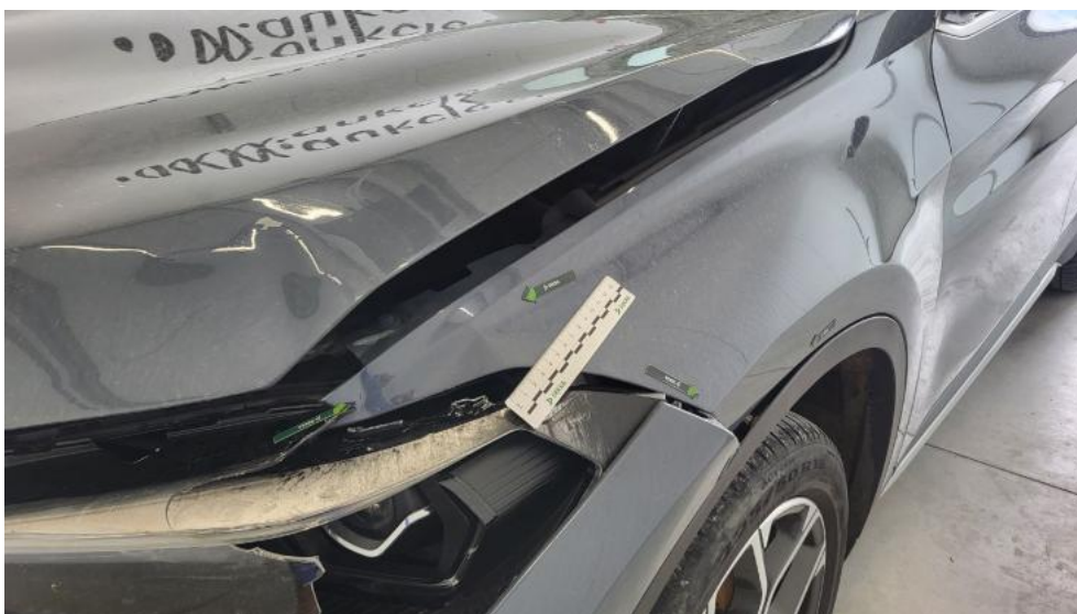
Fot. 82. Błotnik przedni L - Wgniecenie/odkształcenie 1
