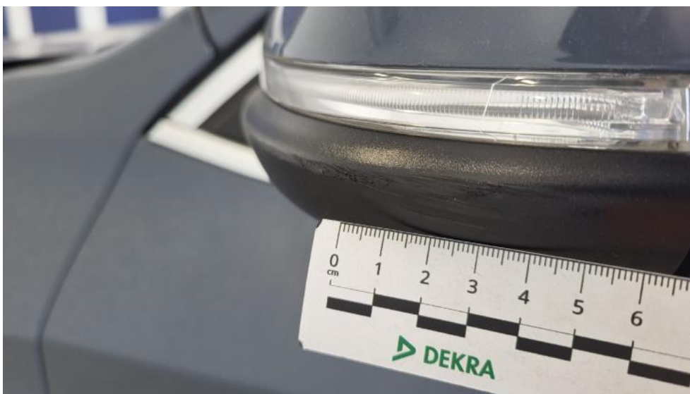
Fot. 79. Lusterko zew L - Rysa/odprysk 1
