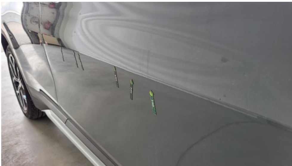
Fot. 63. Drzwi przednie P - Wgniecenie/odkształcenie 1
