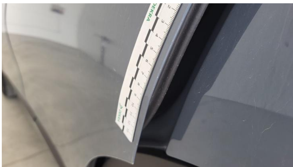
Fot. 76. Drzwi tylne L - Rysa/odprysk 1
