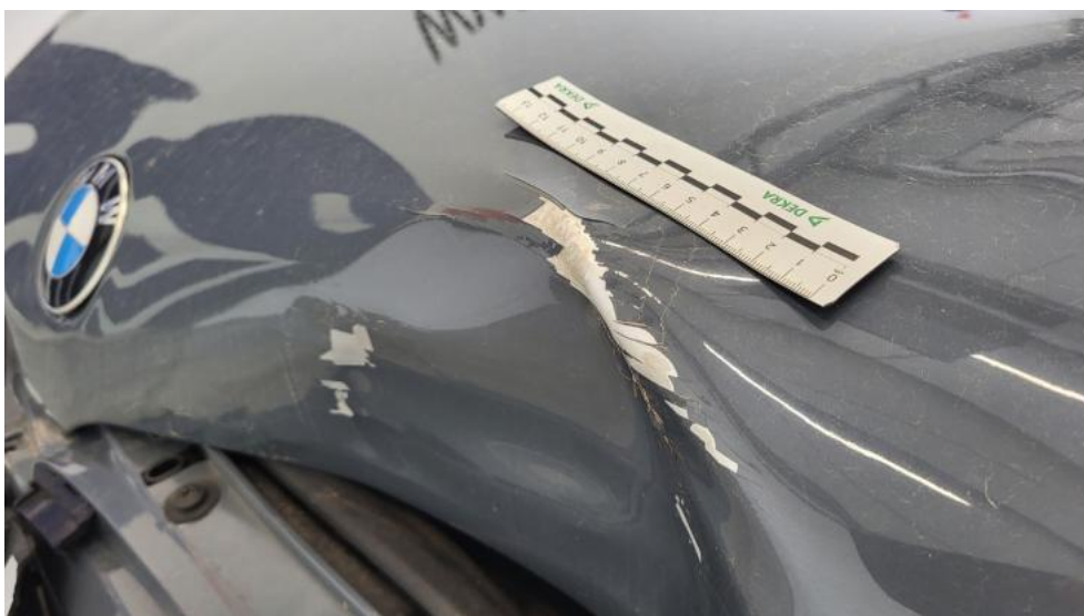
Fot. 54. Pokrywa komory silnika - Pęknięcie/rozerwanie 1
