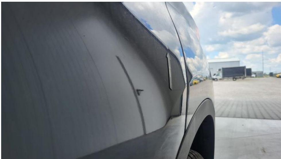
Fot. 77. Drzwi tylne L - Wgniecenie/odkształcenie 1
