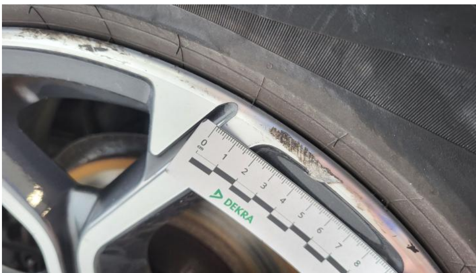
Fot. 67. Felga aluminiowa tylna P - Rysa/odprysk 1
