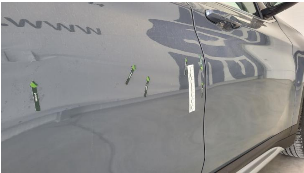
Fot. 65. Drzwi tylne P - Wgniecenie/odkształcenie 1
