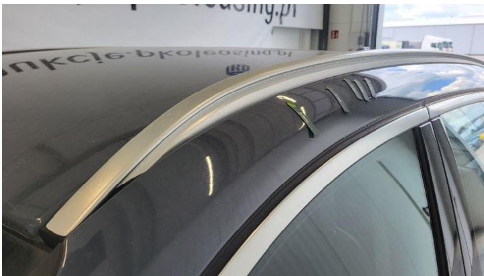
Fot. 80. Słupek przedni L - Wgniecenie/odkształcenie 1
