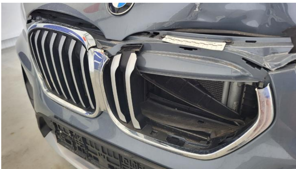
Fot. 48. Atrapa przednia - Pęknięcie/rozerwanie 1
