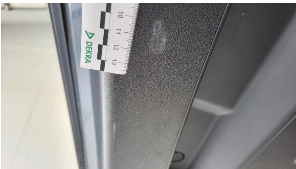
Fot. 96. Wykładzina pokrywy tylnej - Rysa/odprysk 1
