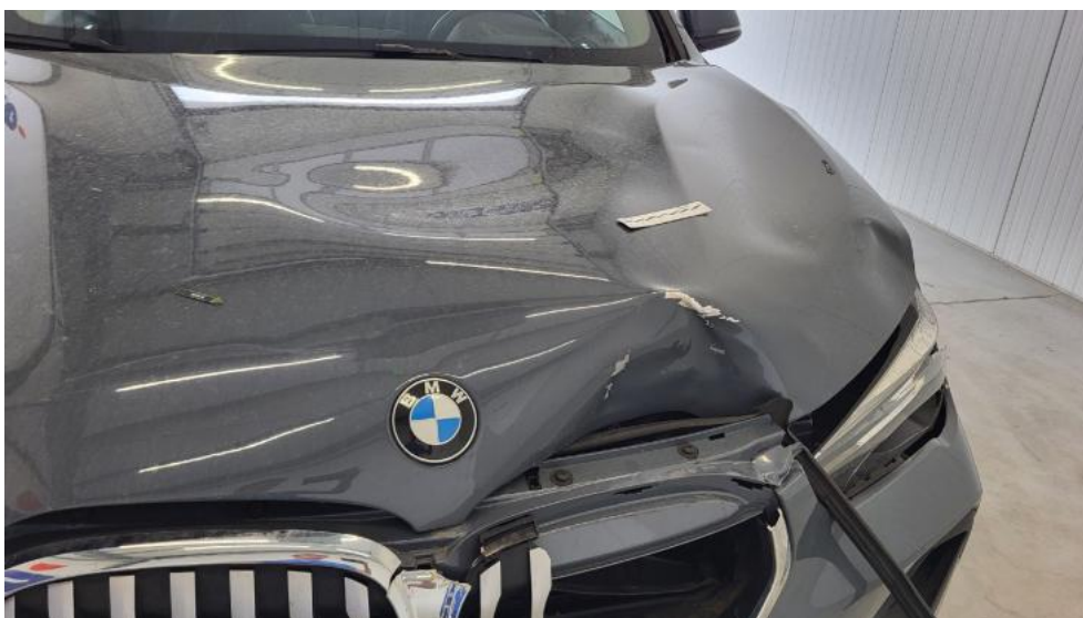
Fot. 52. Pokrywa komory silnika - Wgniecenie/odkształcenie 2
