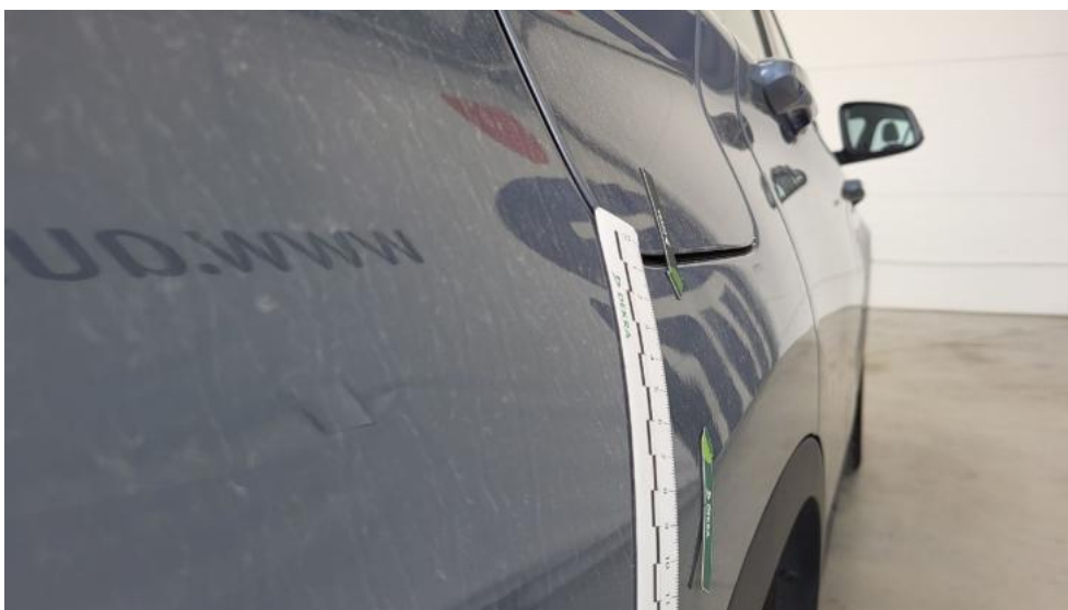
Fot. 66. Błotnik tylny P / Ściana boczna P - Wgniecenie/odkształcenie 1
