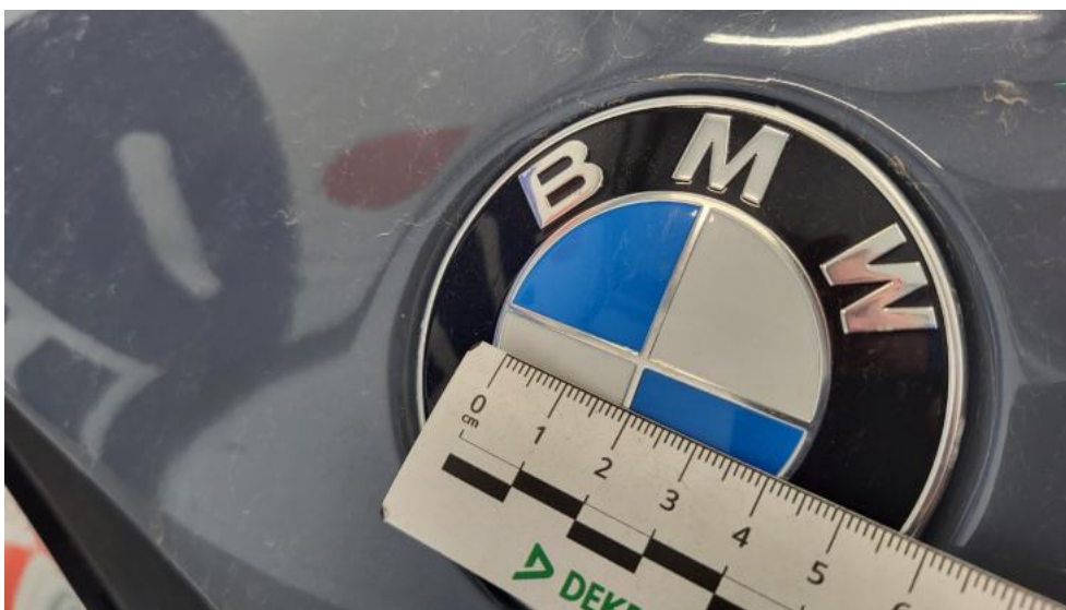
Fot. 49. Emblemat - Rysa/odprysk 1
