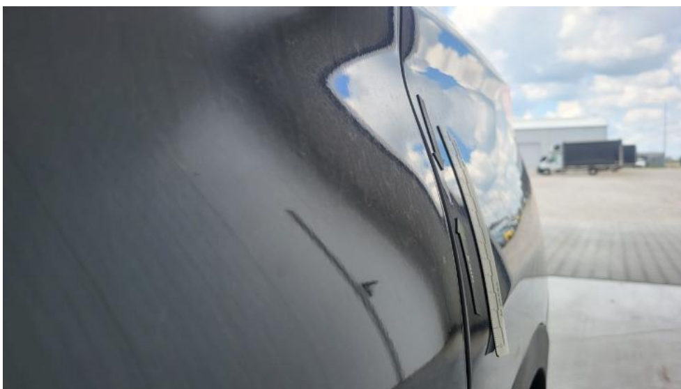
Fot. 72. Błotnik tylny L / Ściana boczna L - Wgniecenie/odkształcenie 2
