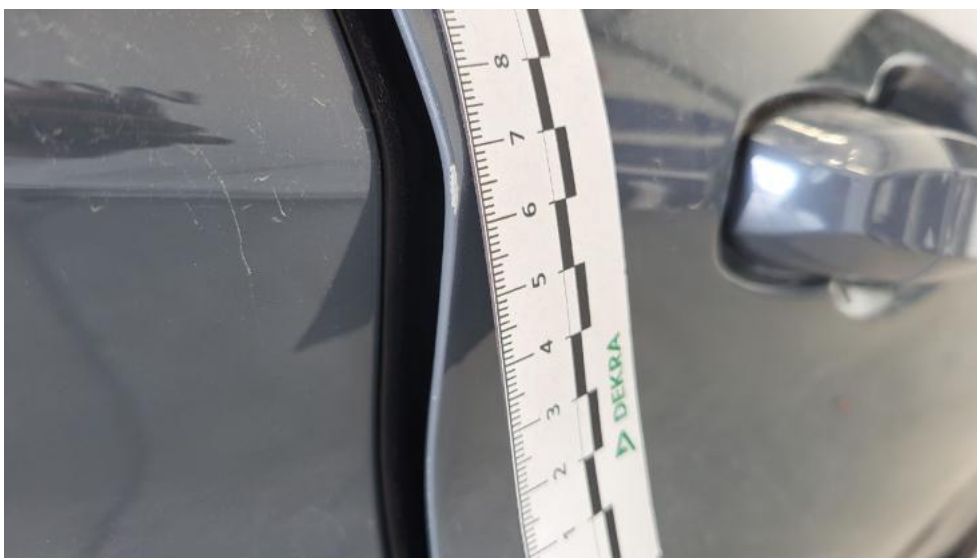
Fot. 62. Drzwi przednie P - Rysa/odprysk 1
