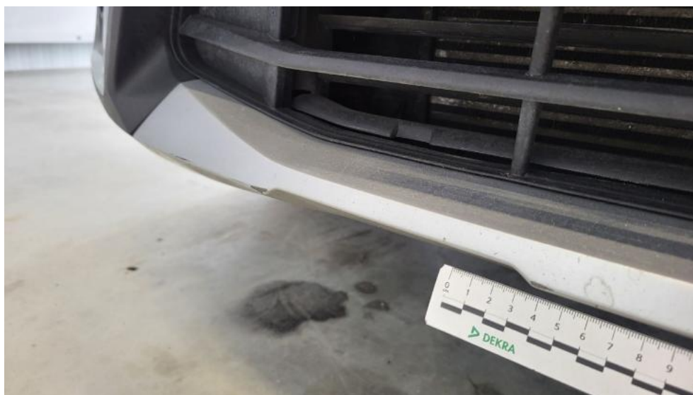
Fot. 59. Zderzak przedni cz dolna - Rysa/odprysk 1
