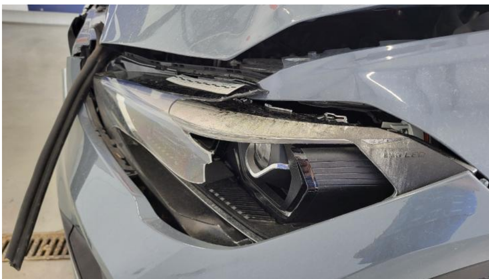
Fot. 83. Reflektor L - Pęknięcie/rozerwanie 1
