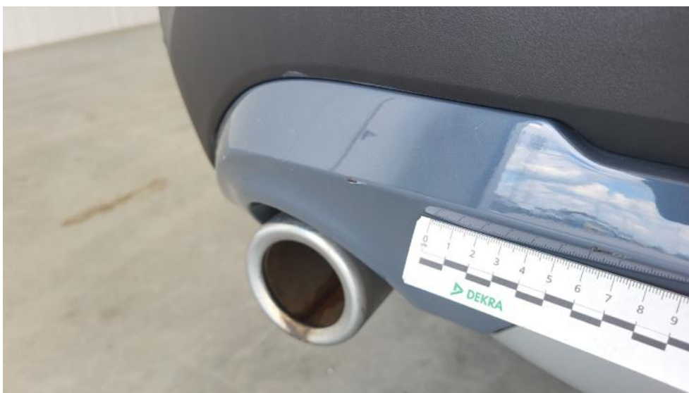
Fot. 68. Zderzak tylny cz dolna - Rysa/odprysk 1
