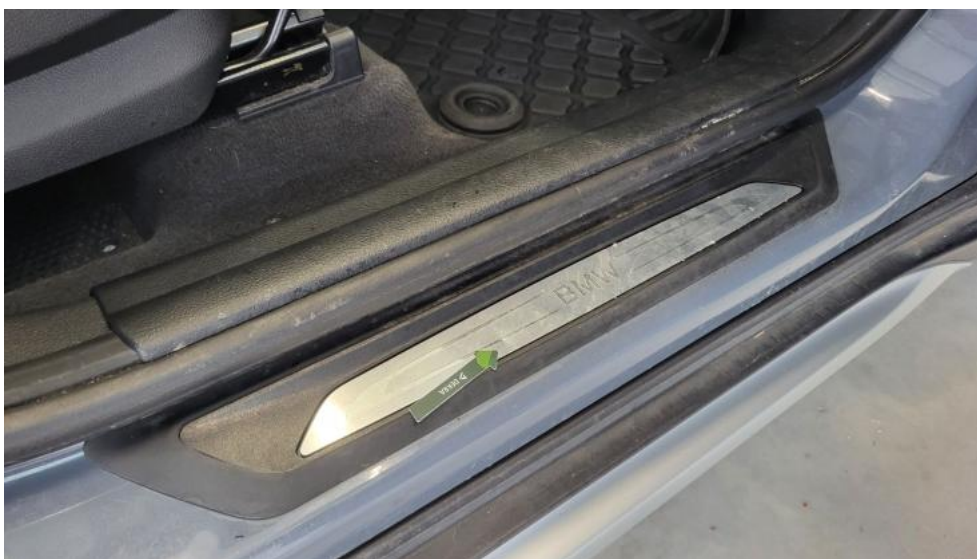
Fot. 89. Listwy progowe praw. - Wgniecenie/odkształcenie 1
