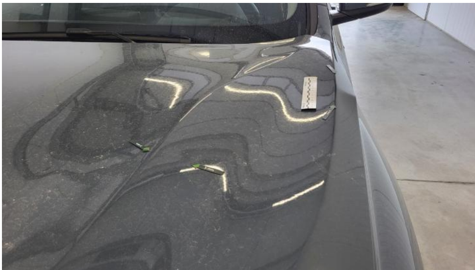
Fot. 53. Pokrywa komory silnika() - Wgniecenie/odkształcenie 3
