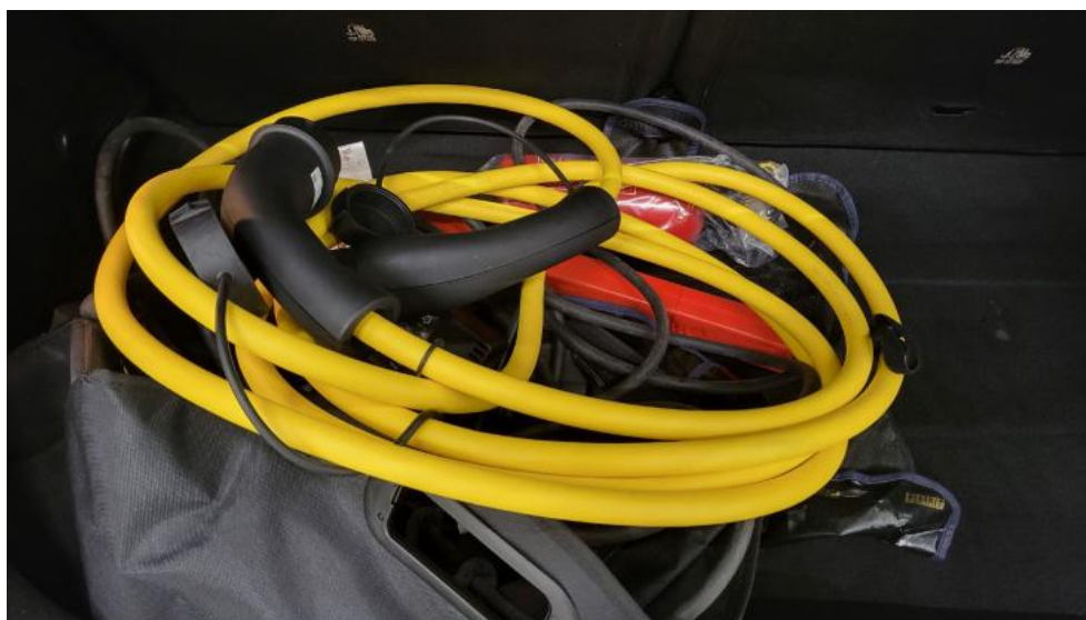
Fot. 34. Przewód ładowania baterii trakcyjnej
