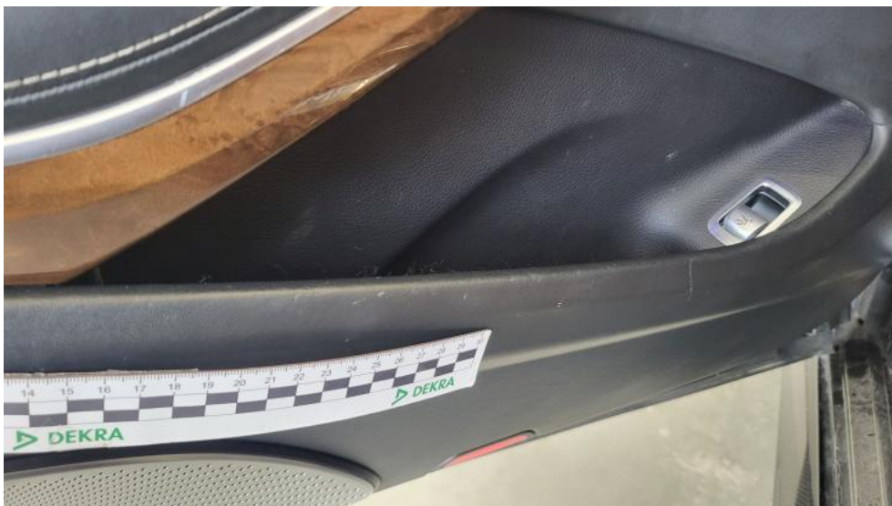
Photo 78. Tapicerka drzwi przednich L - Rysa/odprysk 1
