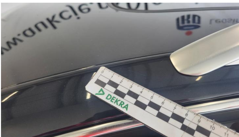
Photo 66. Słupki przedni L - Rysa/odprysk 1
