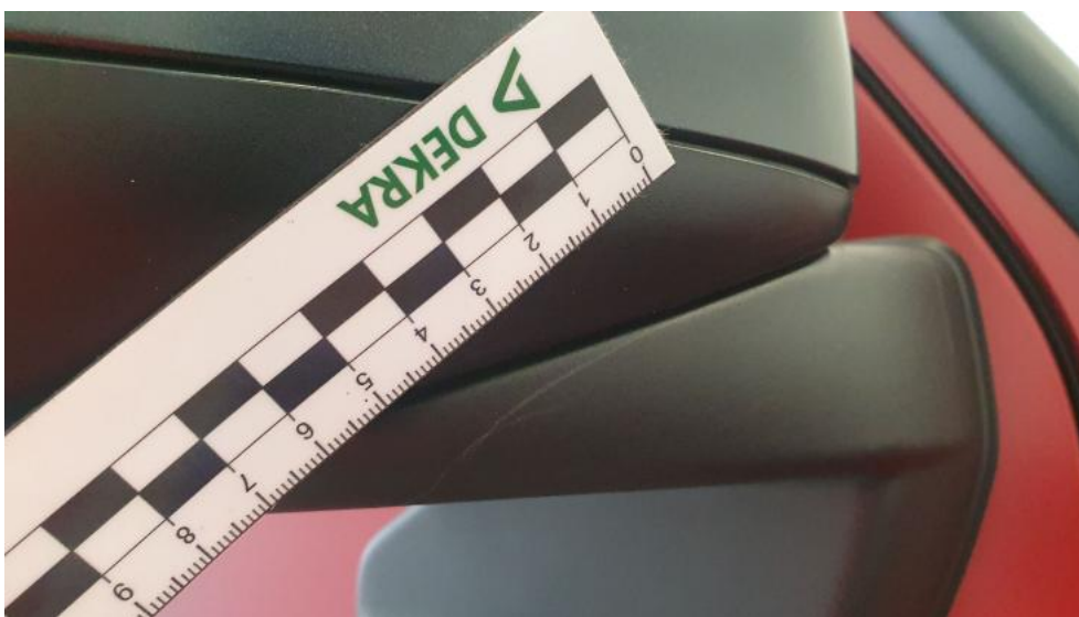
Fot. 63. Lusterko zew P - Rysa/odprysk 1
