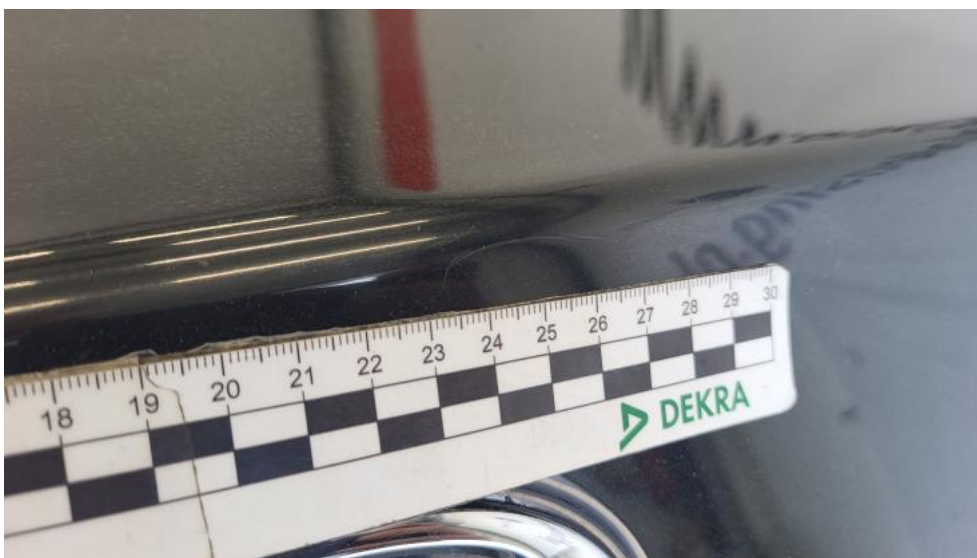
Photo 78. Pokrywy bagażnika - Rysa/odprysk 1
