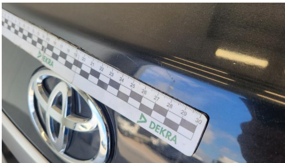
Photo 79. Pokrywy bagażnika - Rysa/odprysk 2
