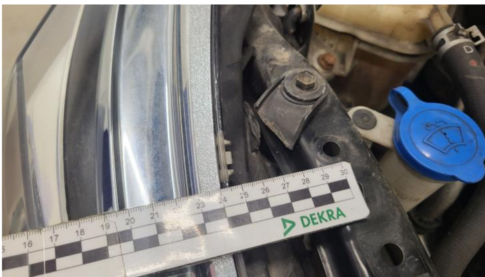
Photo 62. Reflektor P - Pęknięcie/rozerwanie 1
