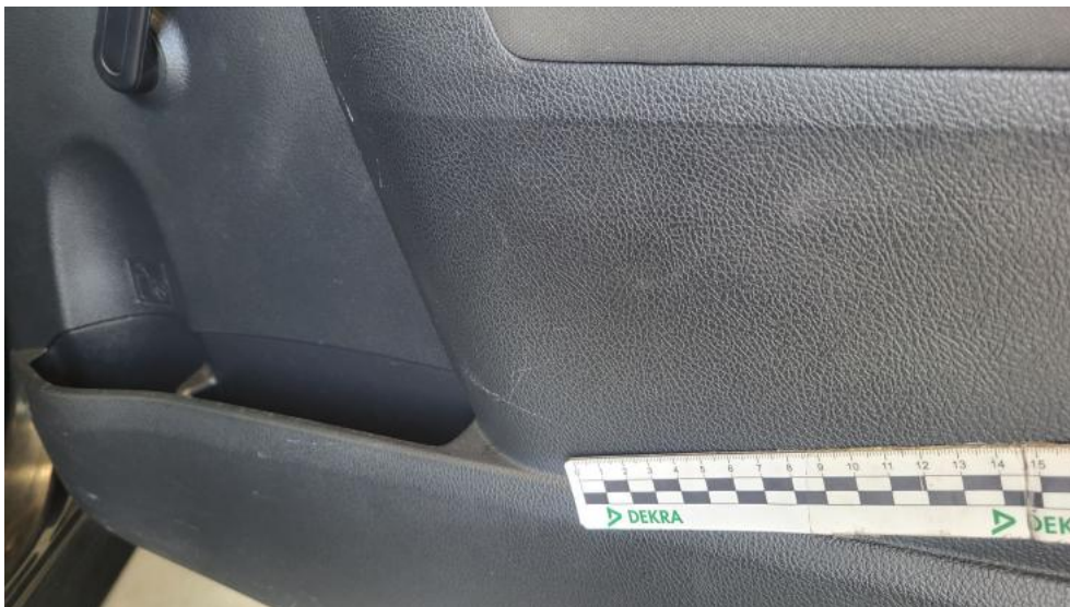
Photo 125. Tapicerka drzwi tylnych P - Rysa/odprysk 2
