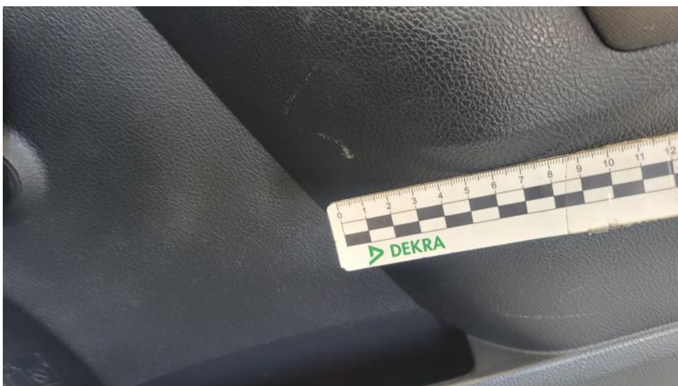
Photo 124. Tapicerka drzwi tylnych P - Rysa/odprysk 1
