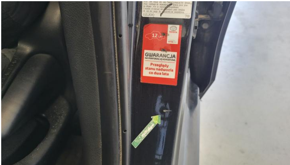
Photo 105. Słupek środkowy L - Wgniecenie/odkształcenie 1
