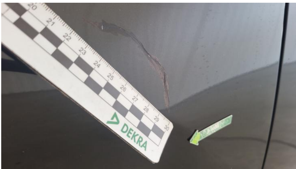
Photo 106. Błotnik przedni L - Rysa/odprysk 1
