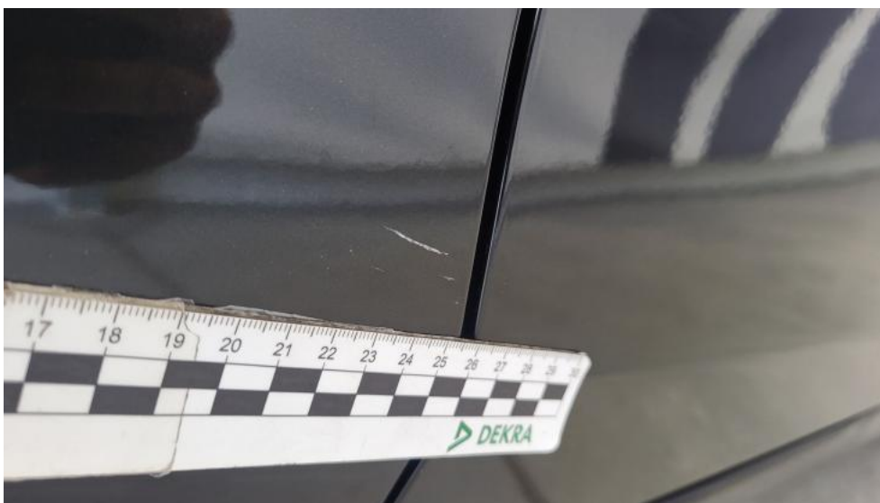
Photo 64. Drzwi tylne P - Rysa/odprysk 1
