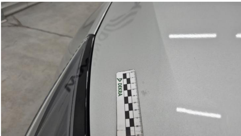
Fot. 38. Pokrywa komory silnika - Rysa/odprysk 1
