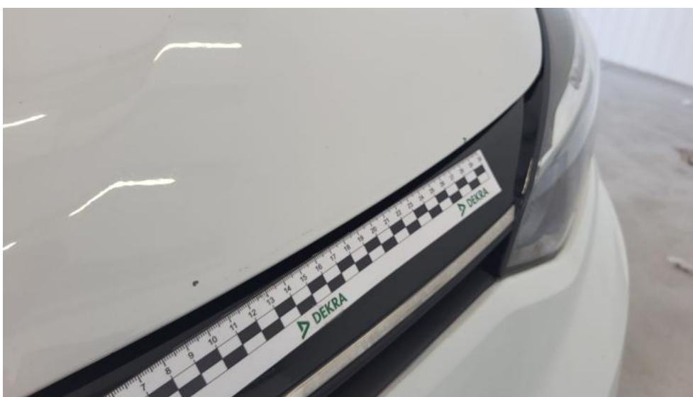
Fot. 34. Pokrywa komory silnika - Rysa/odprysk 1
