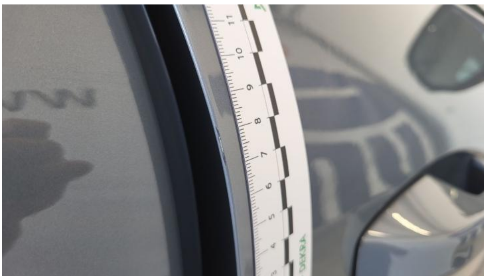
Photo 46. Drzwi przednie P - Rysa/odprysk 1
