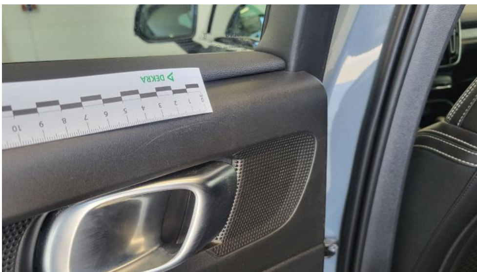
Photo 64. Tapicerka drzwi tylnych L - Rysa/odprysk 1
