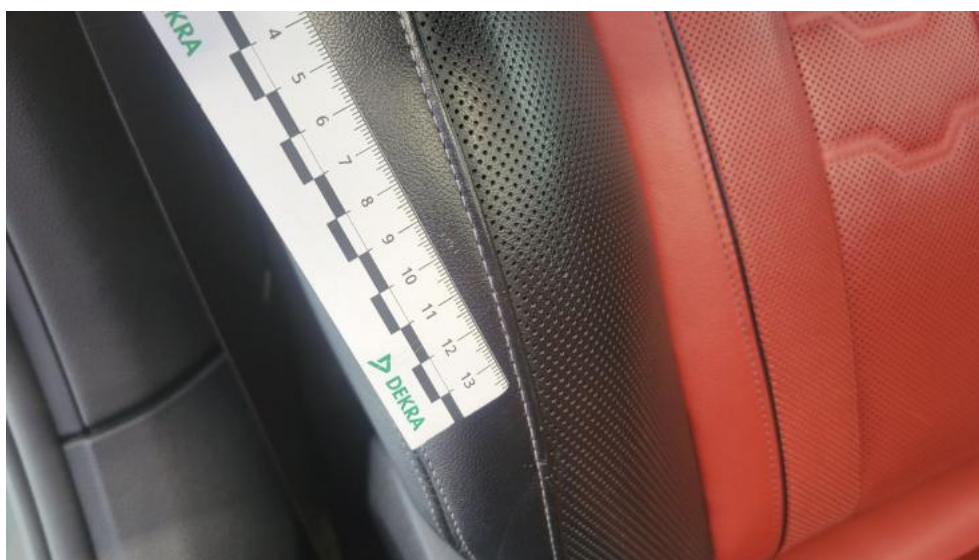
Fot. 72. Fotel prz. praw. - Rysa/odprysk 1
