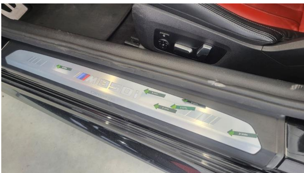
Fot. 74. Listwy progowe lew. - Wgniecenie/odkształcenie 1
