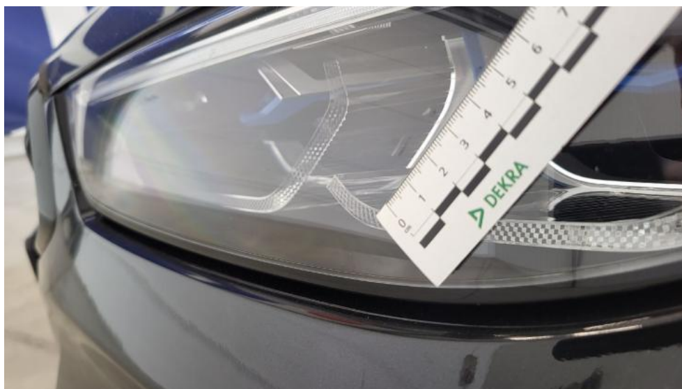
Fot. 68. Reflektor L - Rysa/odprysk 1
