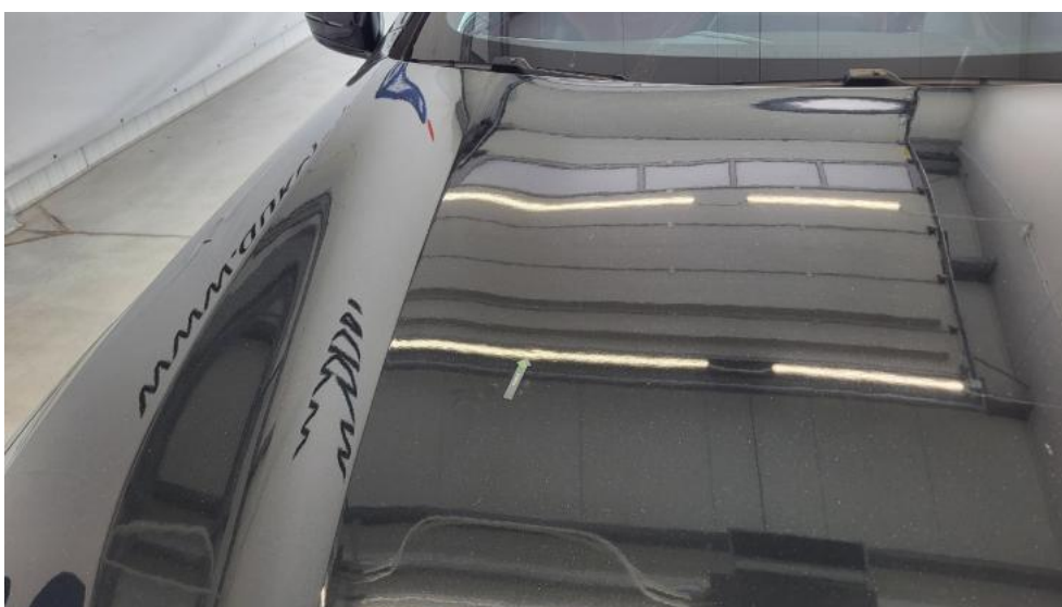
Fot. 48. Pokrywa komory silnika - Wgniecenie/odkształcenie 1
