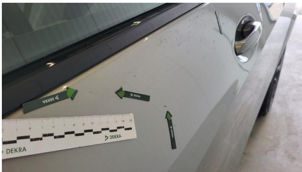
Photo 63. Drzwi przed L - Wgniecenie/odkształcenie 1
