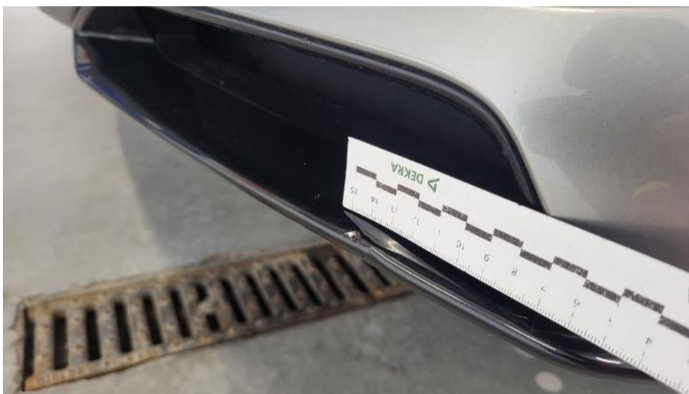
Photo 49. Zderzak przedni cz L - Wgniecenie/odkształcenie 1
