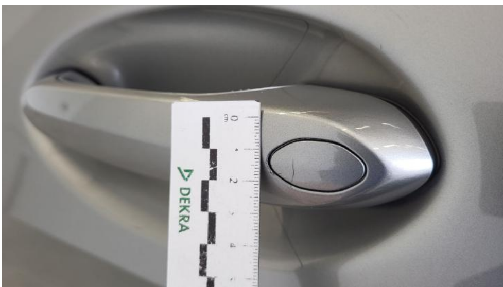
Photo 68. Klamka drzwi prz L - Rysa/odprysk 1
