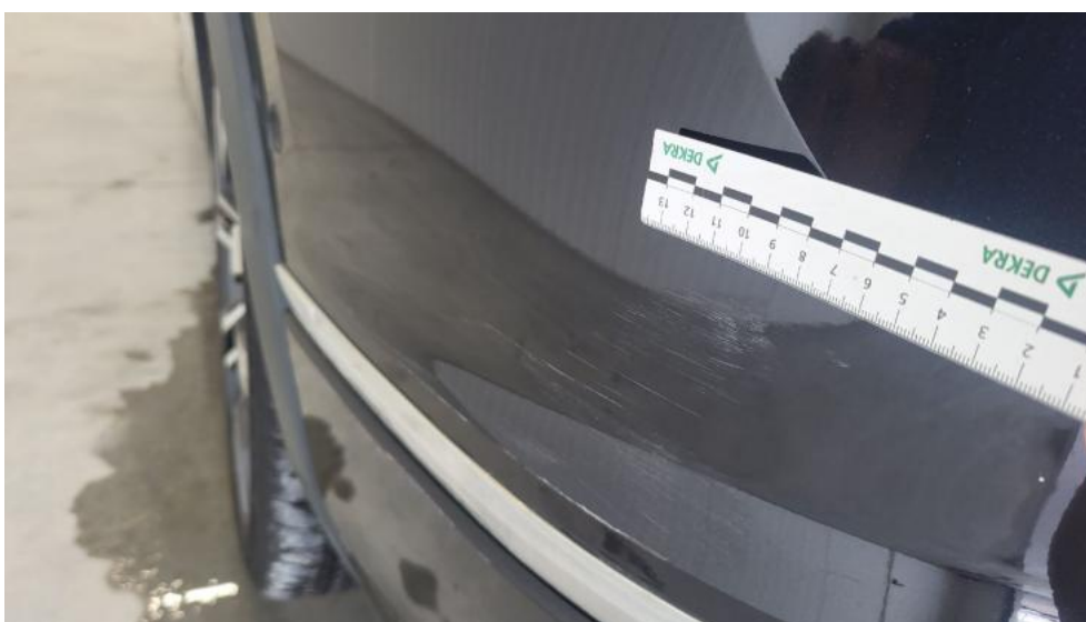
Fot. 72. Zderzak tylny - Rysa/odprysk 2
