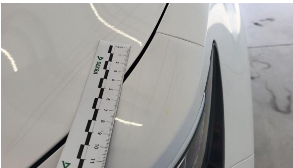
Fot. 53. Zderzak() - Rysa/odprysk 3
