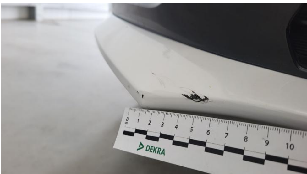
Fot. 54. Zderzak - Wgniecenie/odkształcenie 1
