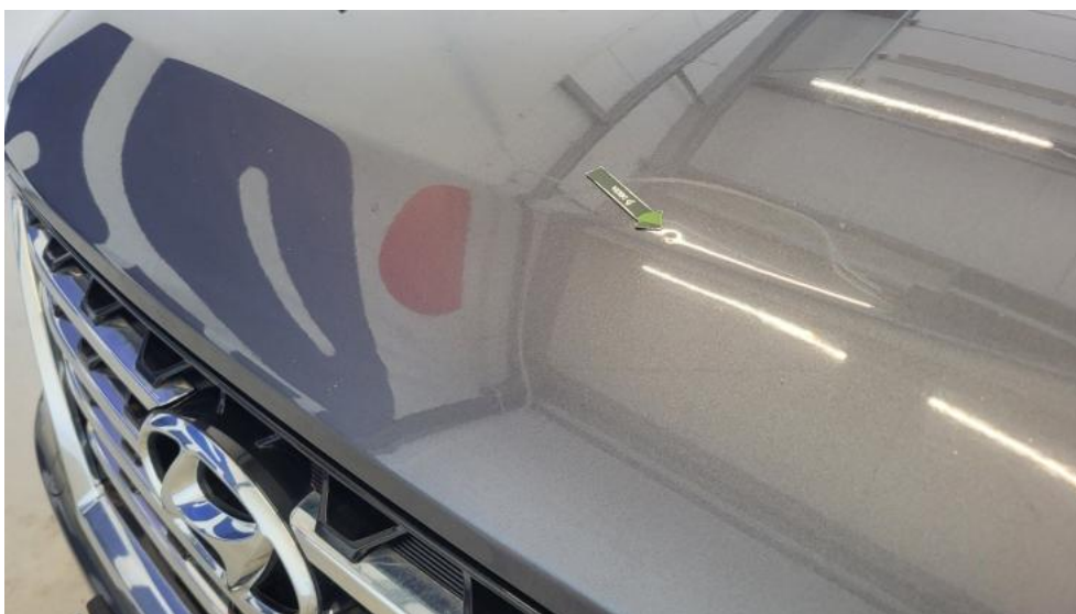
Fot. 44. Pokrywa komory silnika - Wgniecenie/odkształcenie 1
