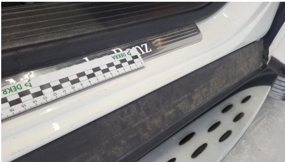
Fot. 55. Próg P - Rysa/odprysk 1
