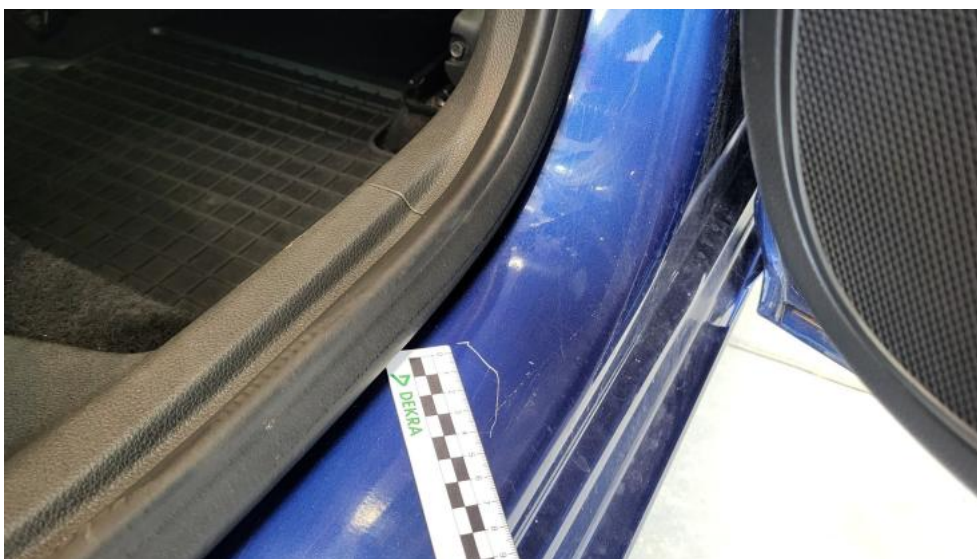
Fot. 47. Próg P - Rysa/odprysk 1
