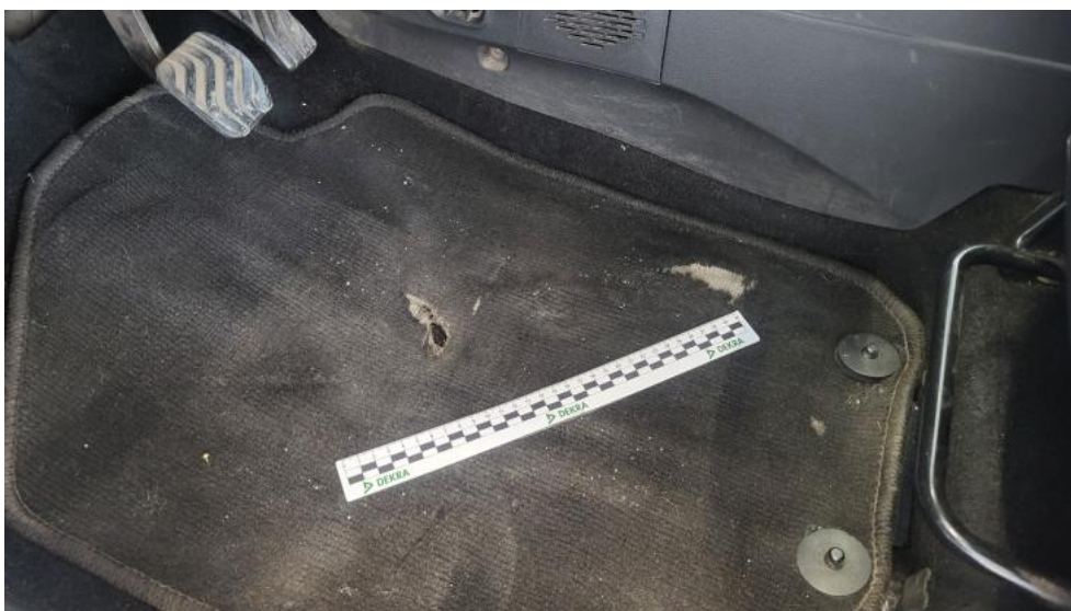
Fot. 74. Dywanik prze L - Pęknięcie/rozerwanie 1
