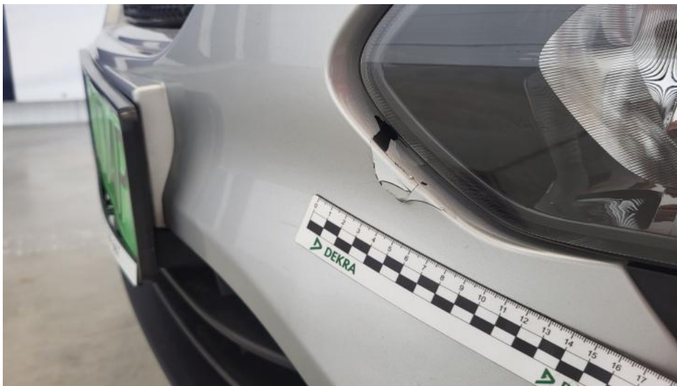
Fot. 39. Zderzak - Pęknięcie/rozerwanie 1
