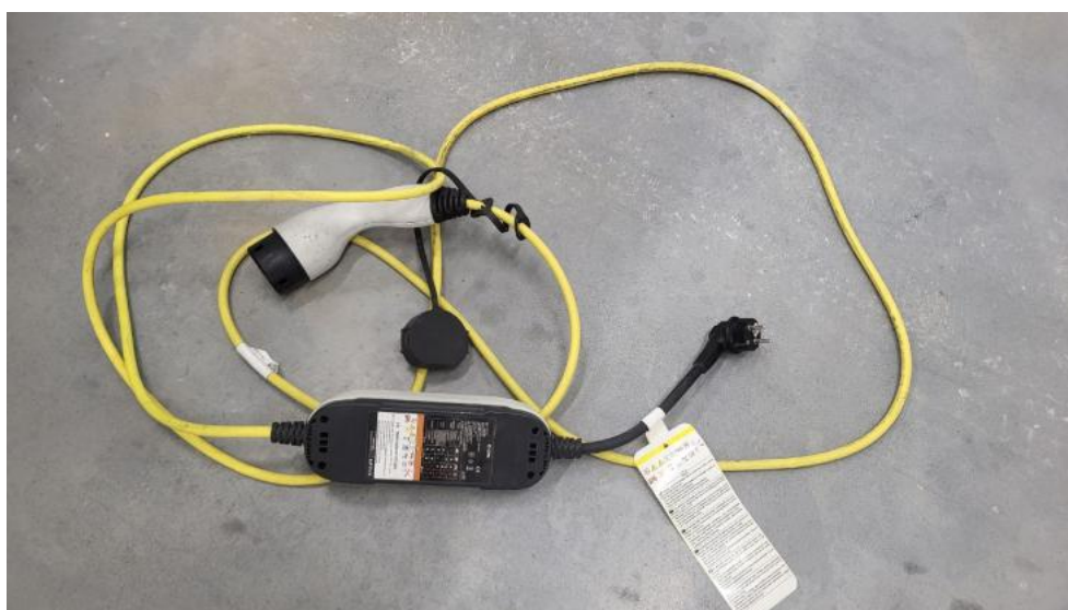
Fot. 30. Przewód ładowania baterii trakcyjnej
