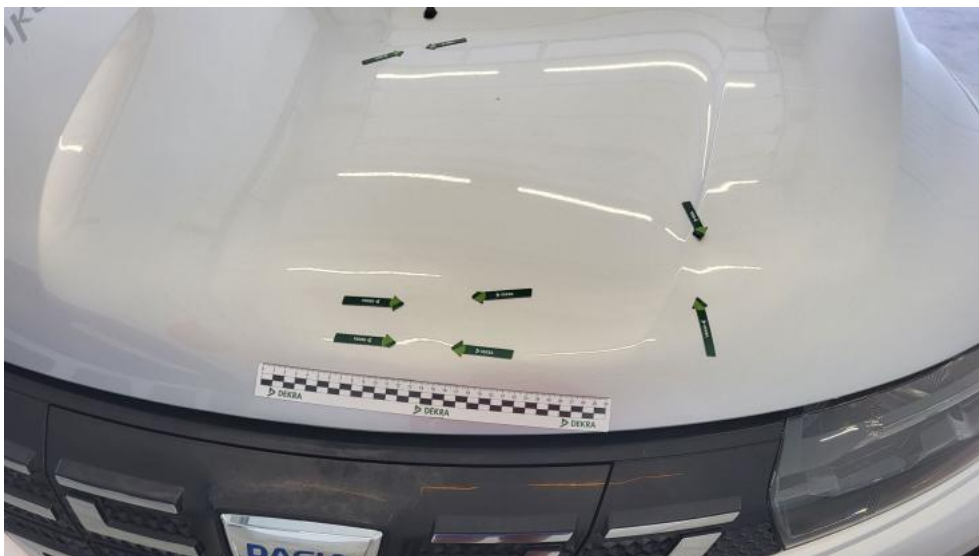
Fot. 38. Pokrywa komory silnika - Wgniecenie/odkształcenie 1
