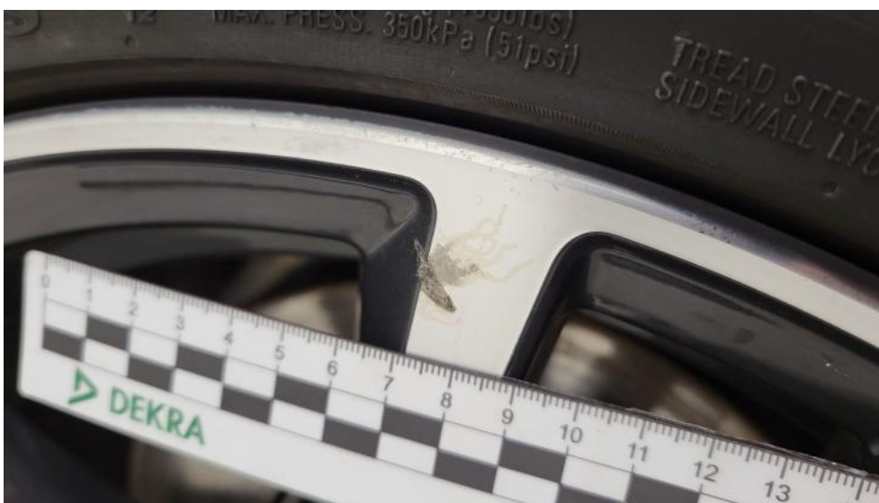
Fot. 50. Felga Aluminiowa przednia L - Rysa/odprysk 1
