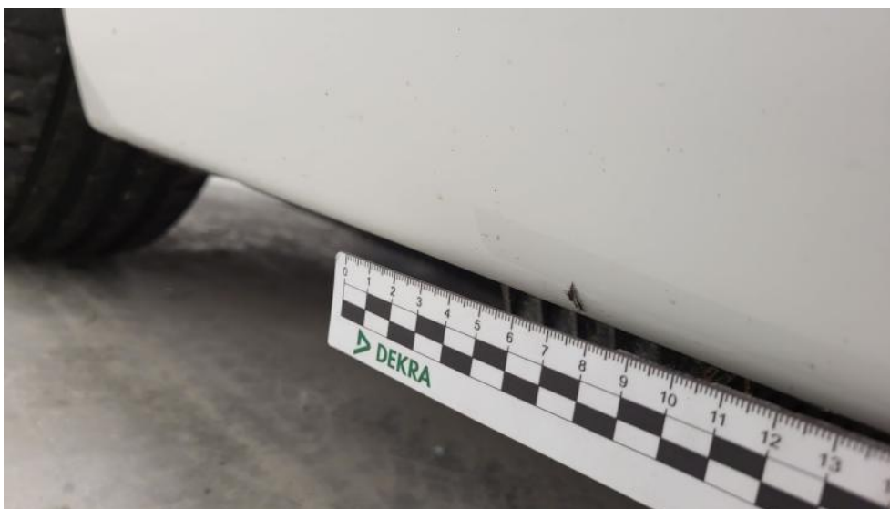
Fot. 49. Próg L - Rysa/odprysk 1
