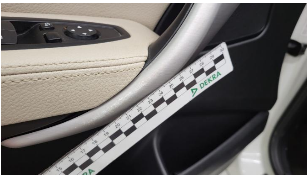
Fot. 52. Uchwyt drzwi prze L - Rysa/odprysk 1
