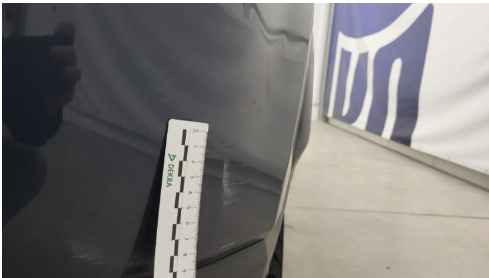
Fot. 57. Zderzak tylny - Wgniecenie/odkształcenie 1
