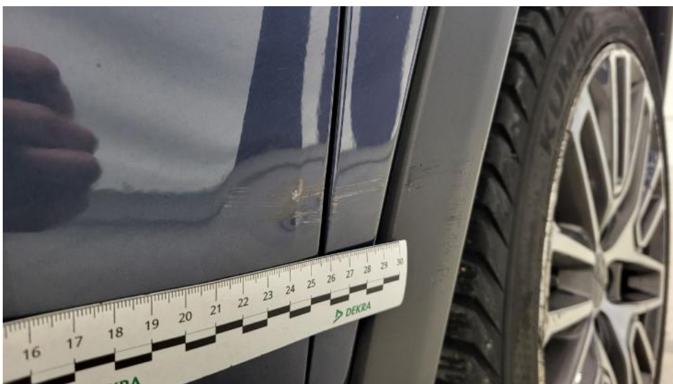
Fot. 48. Drzwi przednie P - Rysa/odprysk 1
