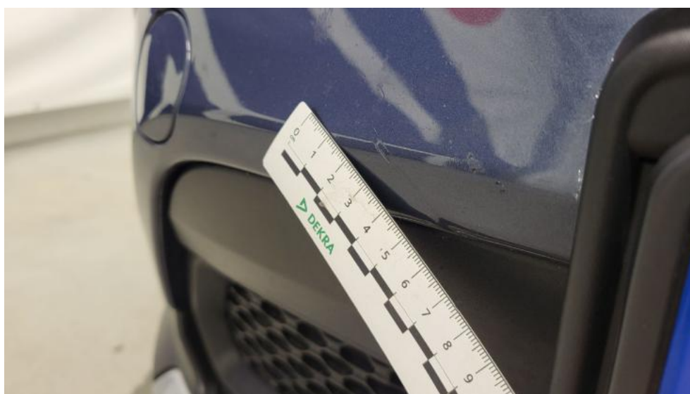
Fot. 44. Zderzak - Wgniecenie/odkształcenie 1
