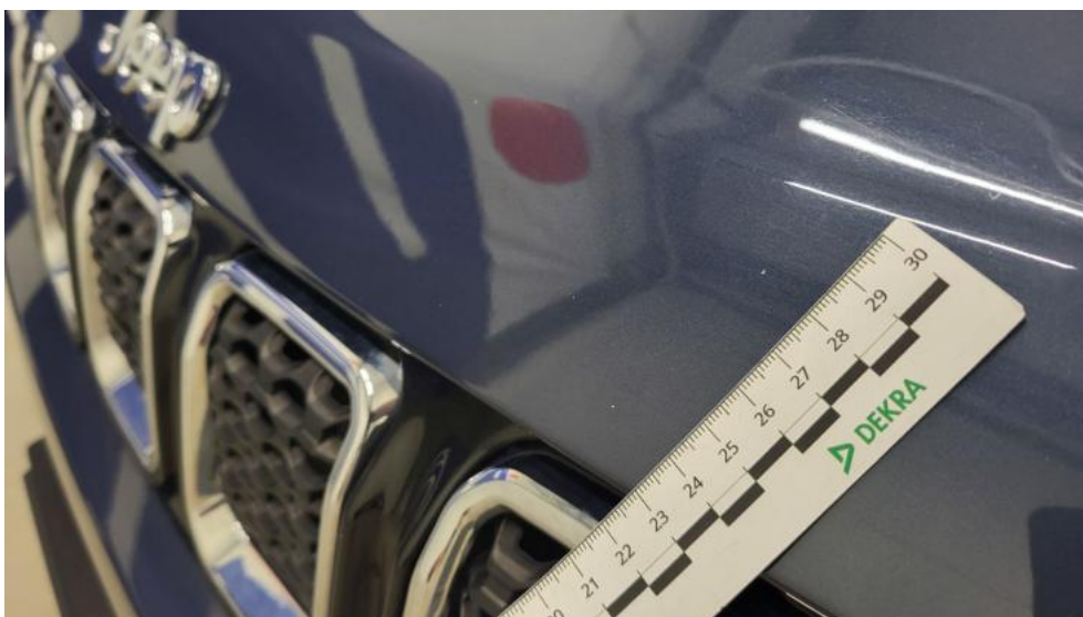
Fot. 42. Pokrywa komory silnika - Rysa/odprysk 1
