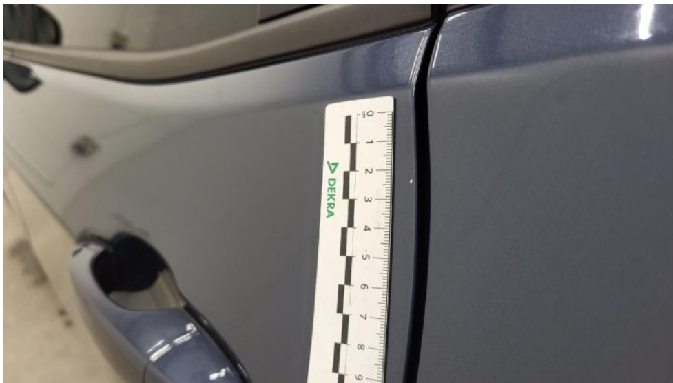
Fot. 65. Drzwi tylne L - Rysa/odprysk 1
