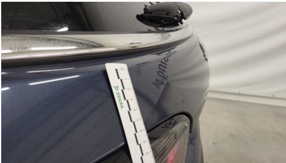
Fot. 53. Pokrywy bagażnika - Wgniecenie/odkształcenie 1
