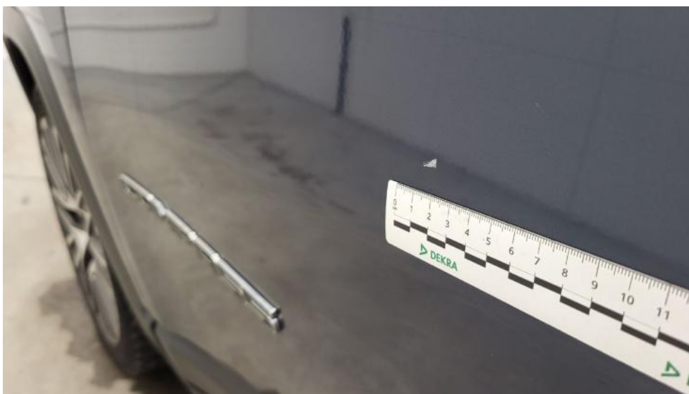
Fot. 63. Drzwi przed L - Rysa/odprysk 2
