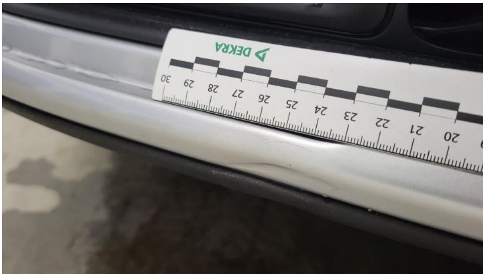
Fot. 41. Listwa śr zderzaka przedniego - Pęknięcie/rozerwanie 1
