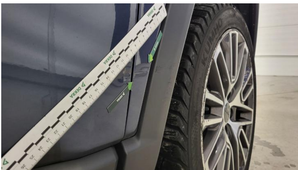
Fot. 46. Błotnik przedni P - Wgniecenie/odkształcenie 1
