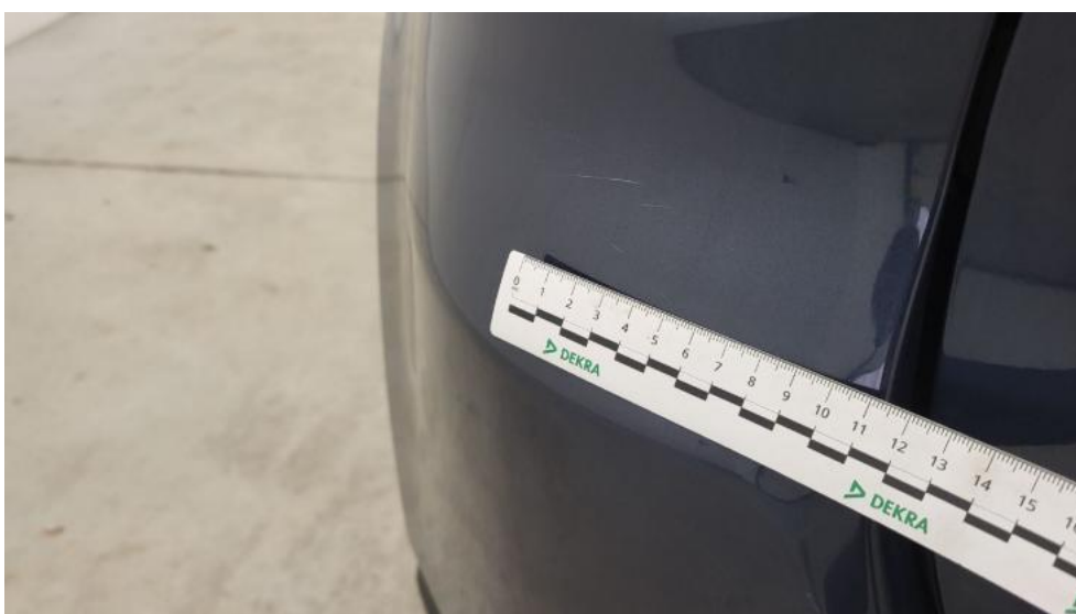
Fot. 56. Zderzak tylny() - Rysa/odprysk 3
