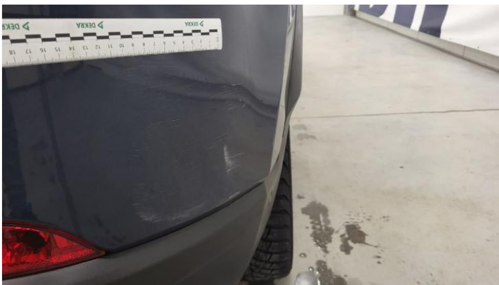
Fot. 54. Zderzak tylny - Rysa/odprysk 1
