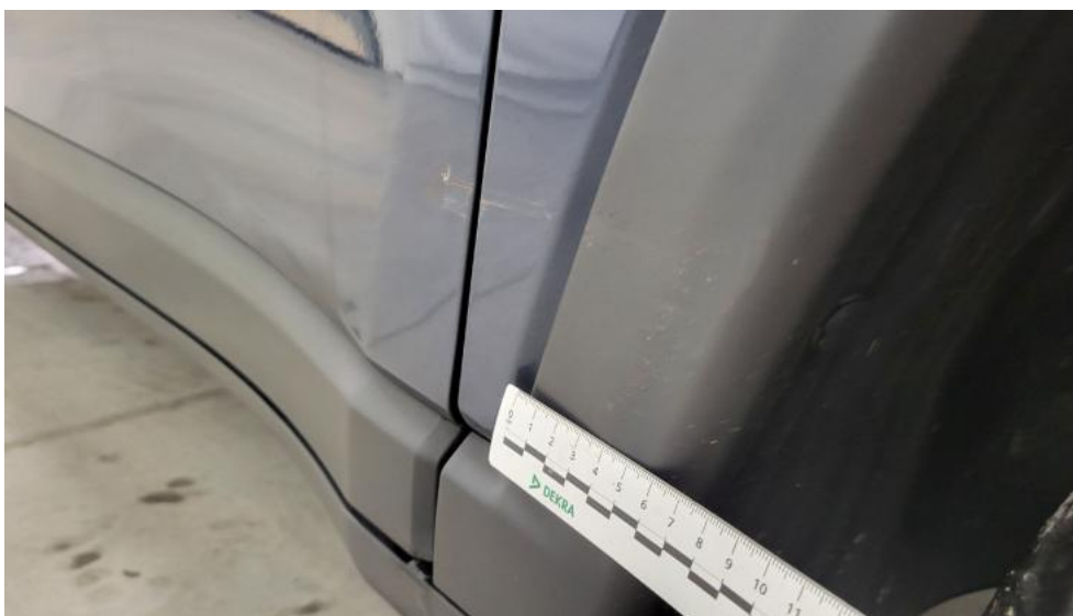
Fot. 47. Listwa błotnika przedniego P - Rysa/odprysk 1
