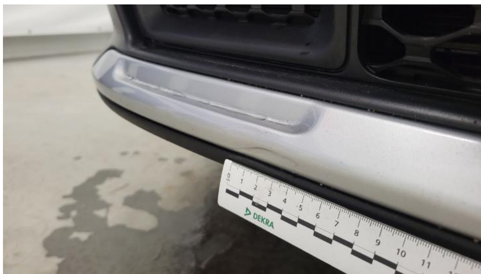
Fot. 40. Listwa śr zderzaka przedniego - Wgniecenie/odkształcenie 1
