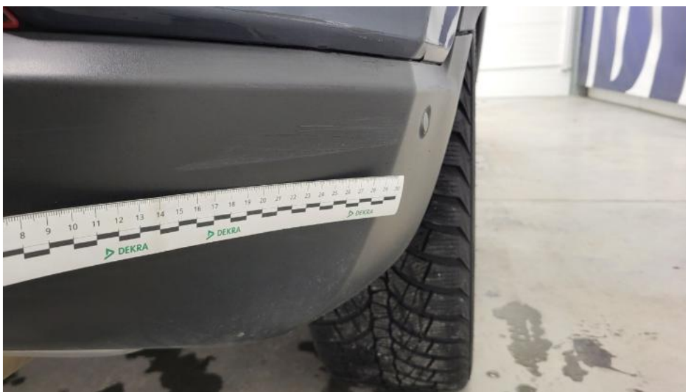
Fot. 59. Zderzak tylny cz dolna - Rysa/odprysk 1
