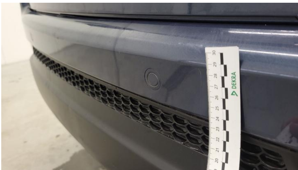
Fot. 55. Zderzak tylny - Rysa/odprysk 2
