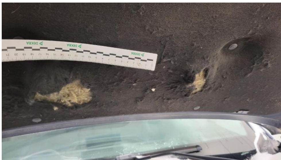
Fot. 43. Wykładzina pokrywy komory silnika - Pęknięcie/rozerwanie 1
