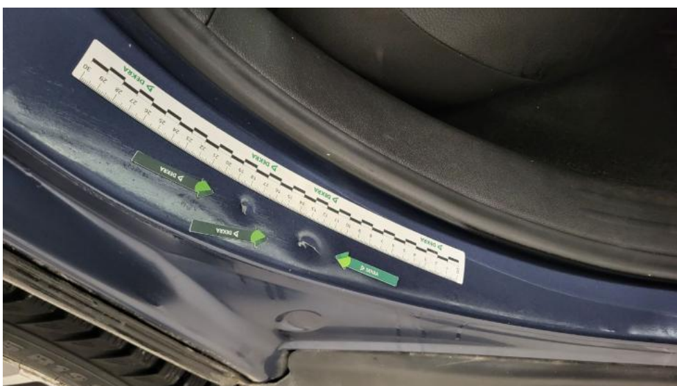
Fot. 52. Błotnik tylny P / Ściana boczna P - Wgniecenie/odkształcenie 1
