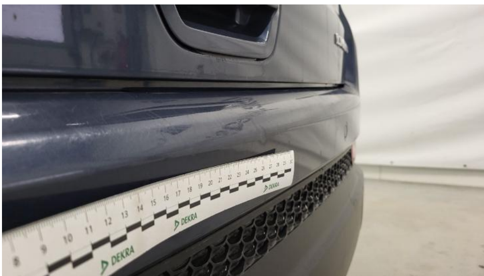
Fot. 58. Zderzak tylny - Wgniecenie/odkształcenie 2
