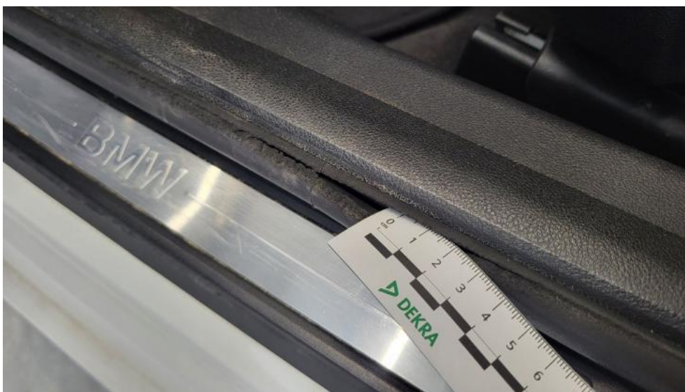
Photo 67. Uszczelka drzwi przednich L - Pęknięcie/rozerwanie 1
