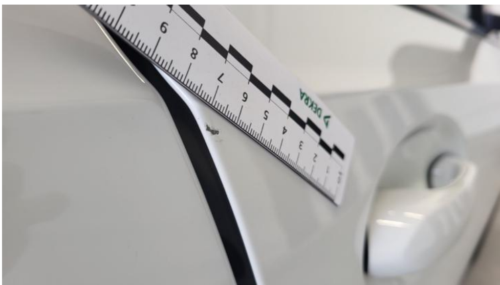
Photo 42. Drzwi przednie P - Rysa/odprysk 1
