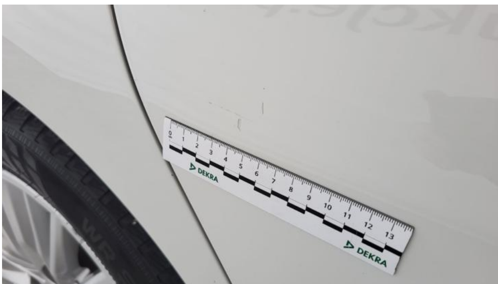
Photo 44. Drzwi tylne P - Rysa/odprysk 1
