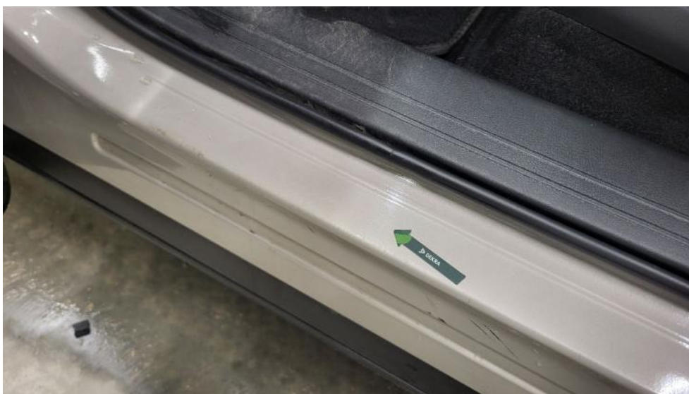
Photo 56. Próg L - Wgniecenie/odkształcenie 1
