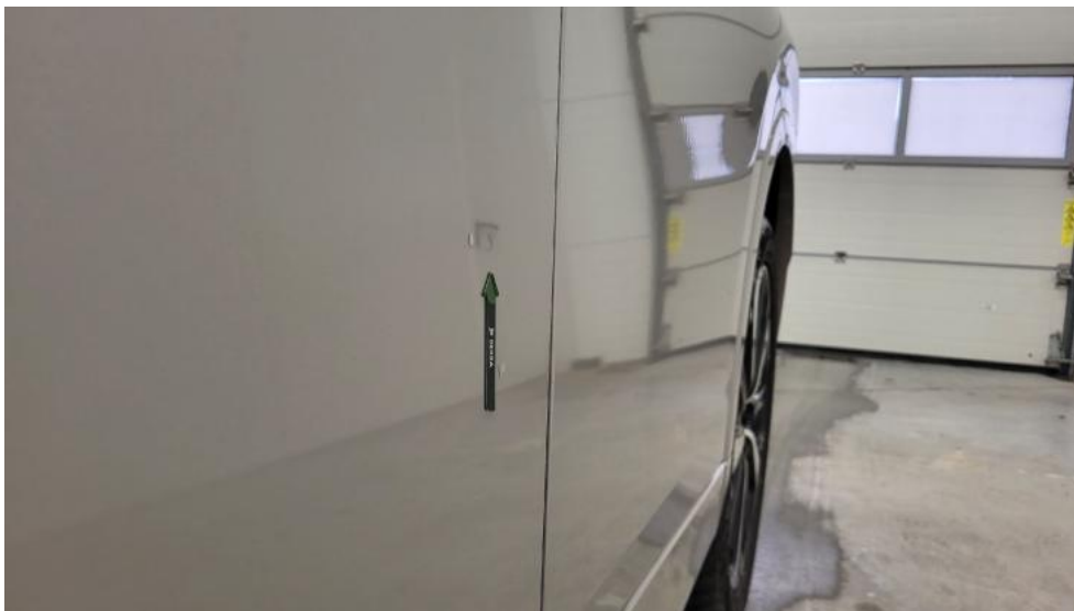
Photo 53. Drzwi przed L - Wgniecenie/odkształcenie 1
