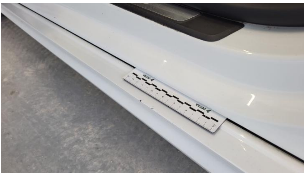
Fot. 68. Próg L - Rysa/odprysk 1
