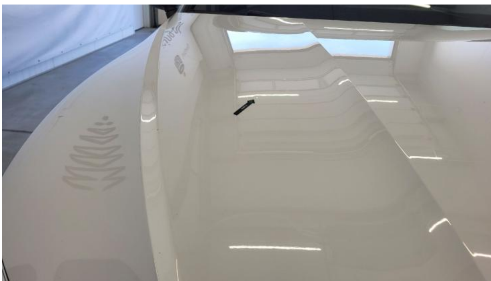
Fot. 41. Pokrywa komory silnika - Wgniecenie/odkształcenie 1
