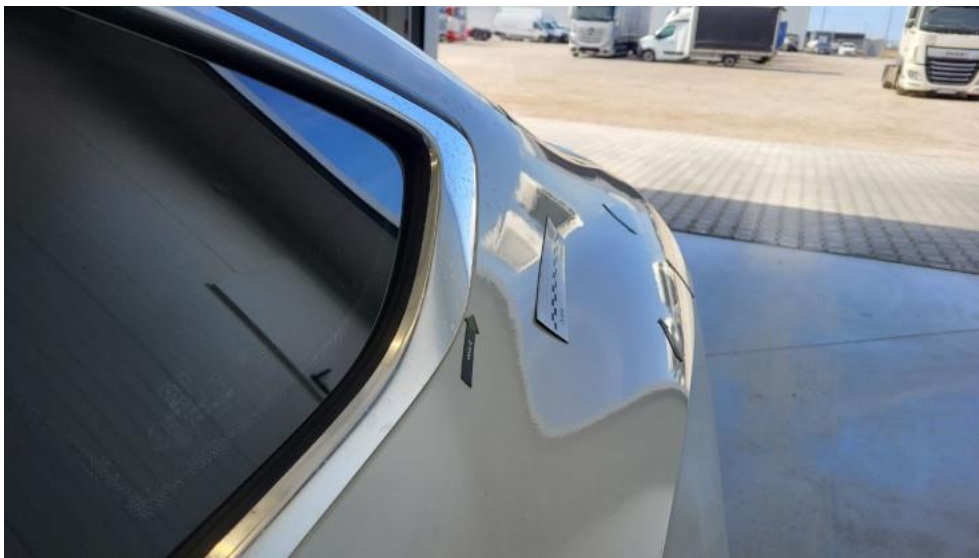
Fot. 61. Błotnik tylny L / Ściana boczna L - Wgniecenie/odkształcenie 1
