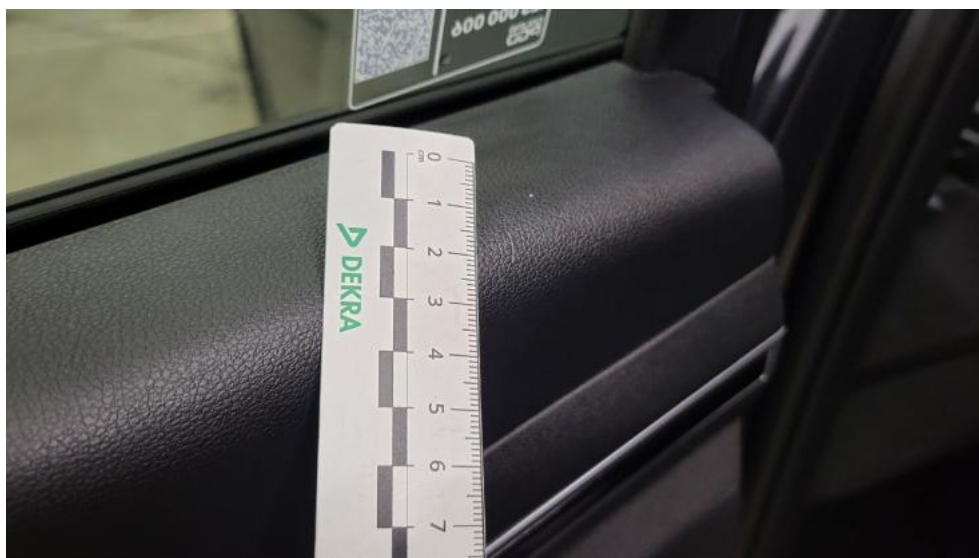
Photo 60. Tapicerka drzwi tylnych L - Rysa/odprysk 1
