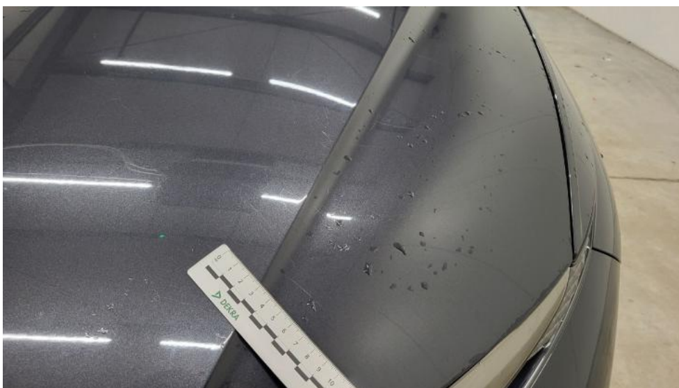
Photo 38. Pokrywa komory silnika - Rysa/odprysk 1
