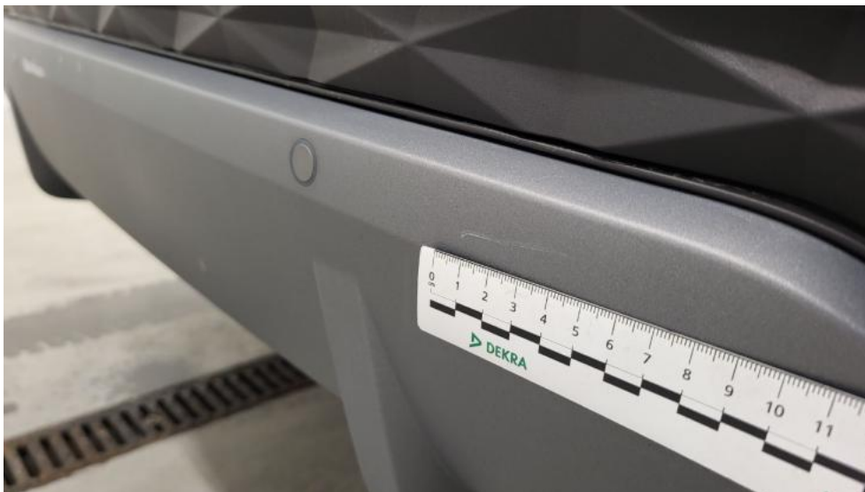
Photo 49. Zderzak tylny - Rysa/odprysk 1
