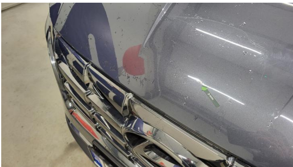
Photo 39. Pokrywa komory silnika - Wgniecenie/odkształcenie 1
