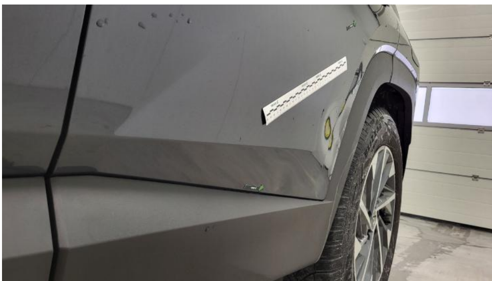
Photo 55. Drzwi tylne L - Wgniecenie/odkształcenie 1
