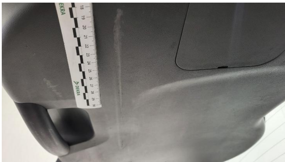
Photo 64. Wykładzina pokrywy tylnej - Rysa/odprysk 1
