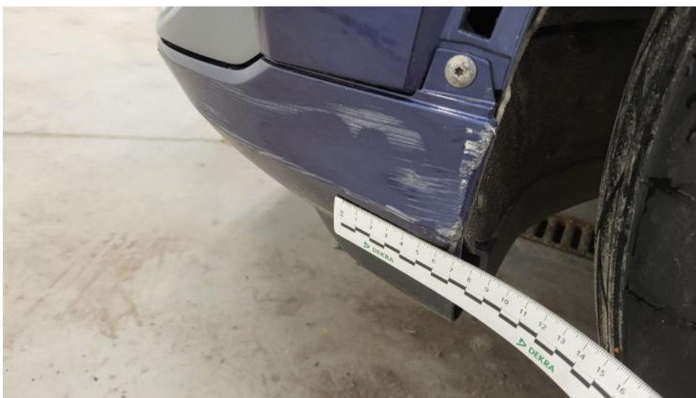
Photo 65. Zderzak przedni cz dolna - Wgniecenie/odkształcenie 1
