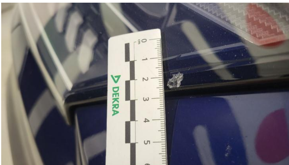
Photo 68. Reflektor P - Pęknięcie/rozerwanie 1
