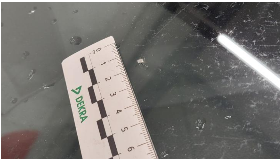
Photo 61. Szyba czołowa - Pęknięcie/rozerwanie 1
