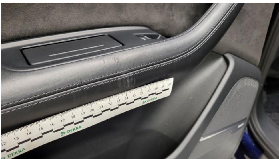
Photo 90. Tapicerka drzwi tylnych L - Rysa/odprysk 1
