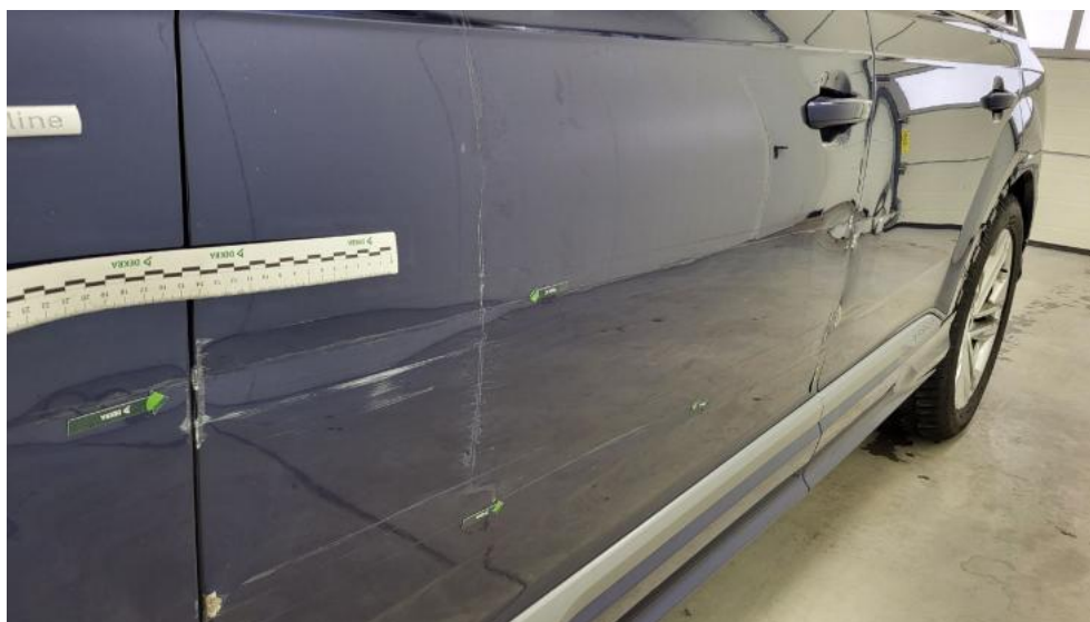
Photo 81. Drzwi przed L - Wgniecenie/odkształcenie 1
