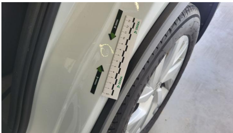
Photo 68. Błotnik tylny L / Ściana boczna L - Wgniecenie/odkształcenie 1
