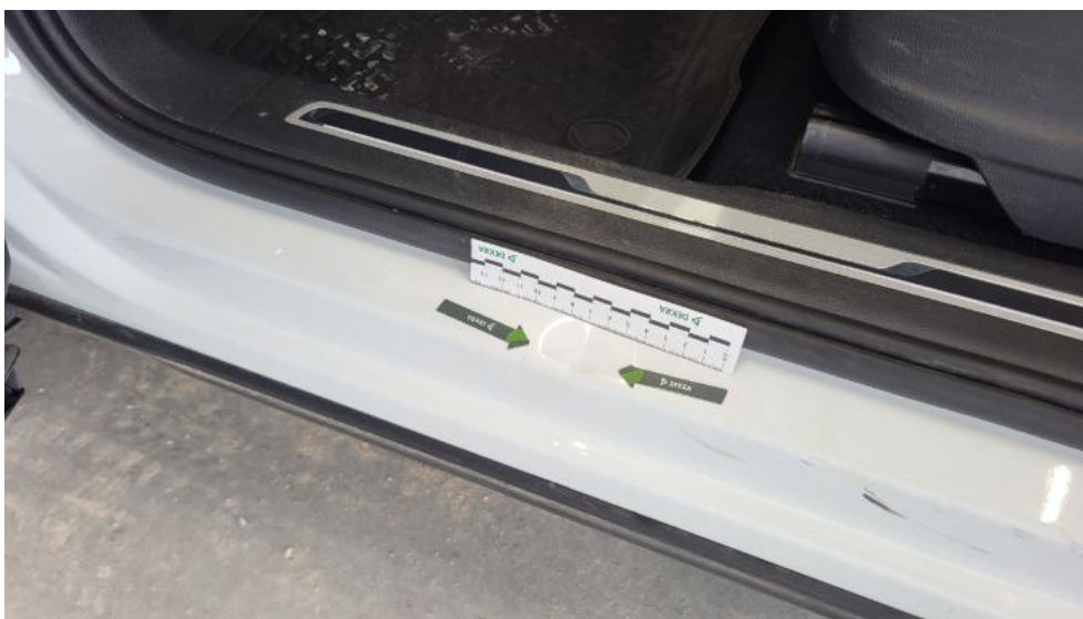
Photo 75. Próg L - Wgniecenie/odkształcenie 1
