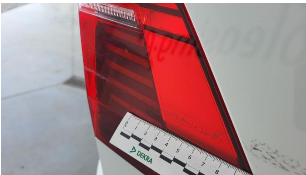
Photo 60. Lampa tylna zew P - Rysa/odprysk 1
