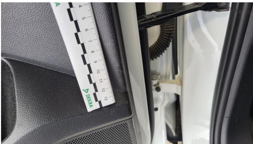
Photo 81. Tapicerka drzwi tylnych L - Rysa/odprysk 1
