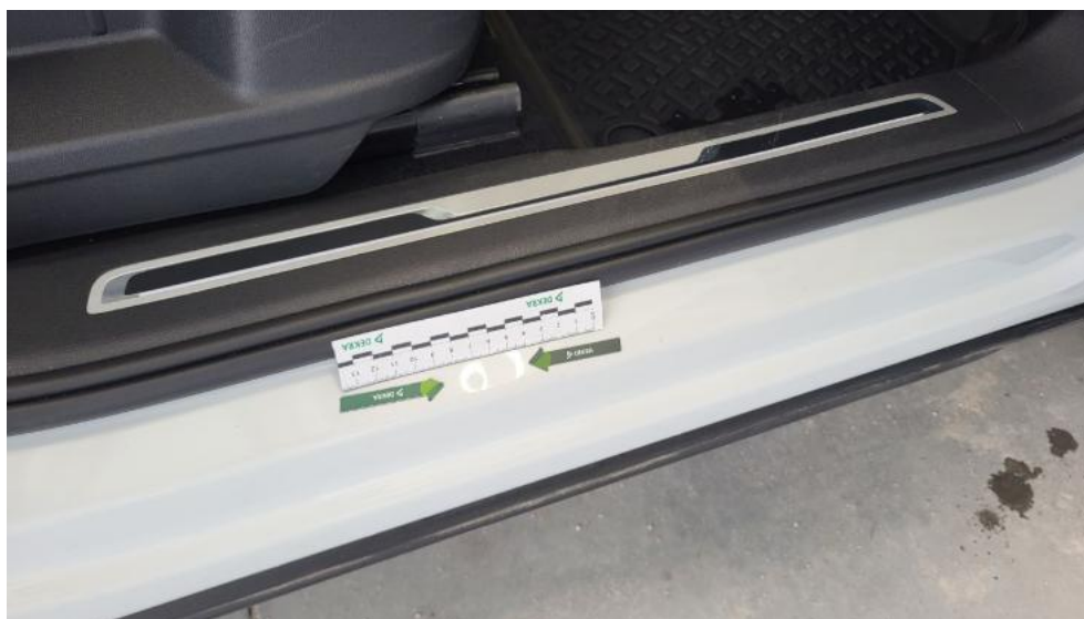
Photo 57. Próg P - Wgniecenie/odkształcenie 1
