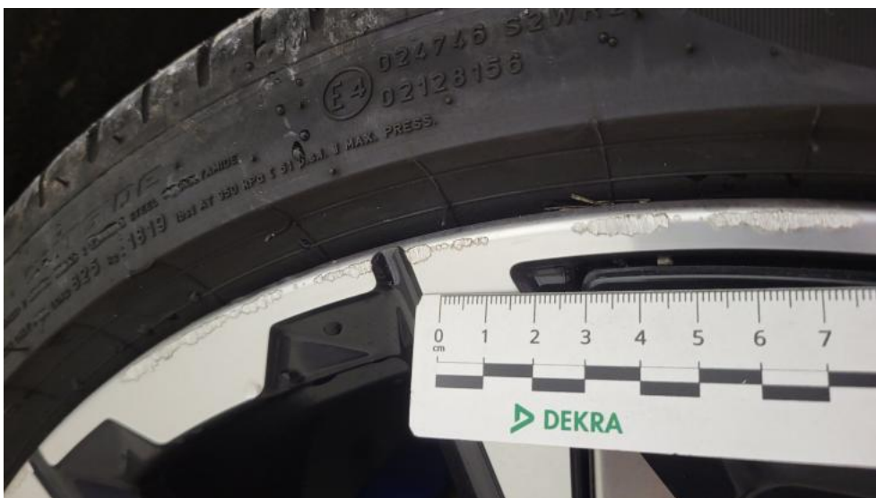
Photo 54. Felga aluminiowa przednia P - Rysa/odprysk 1
