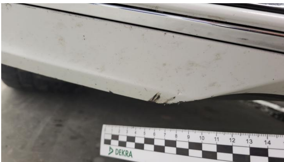
Fot. 66. Spoiler zderzaka przedniego() - Rysa/odprysk 3
