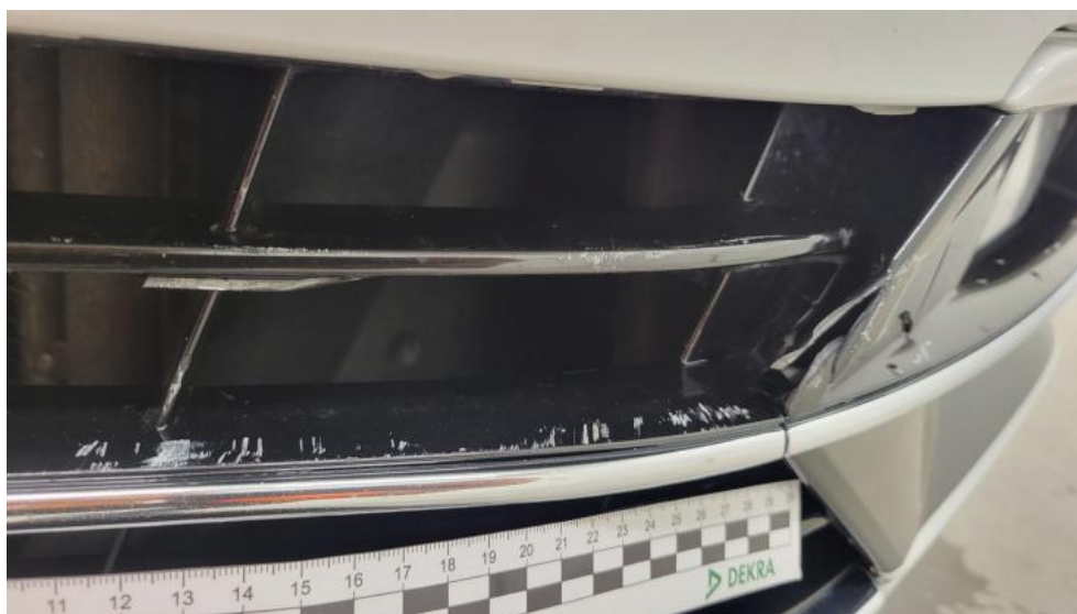
Fot. 54. Kratka zderzaka prz. - Rysa/odprysk 1
