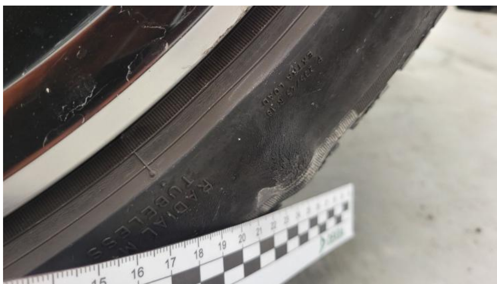
Fot. 80. Opona przednia P - Wgniecenie/odkształcenie 1
