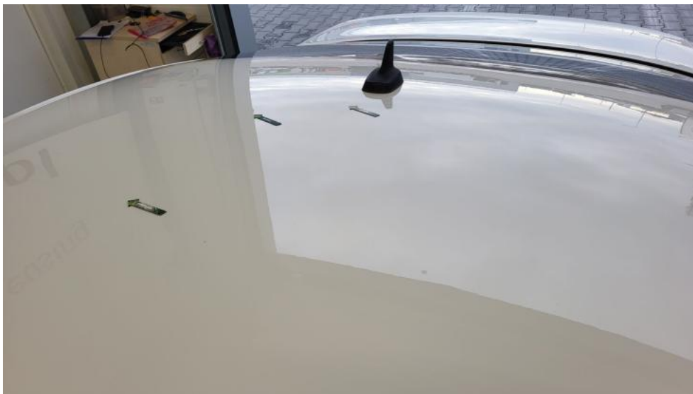
Fot. 87. Dach - Wgniecenie/odkształcenie 1
