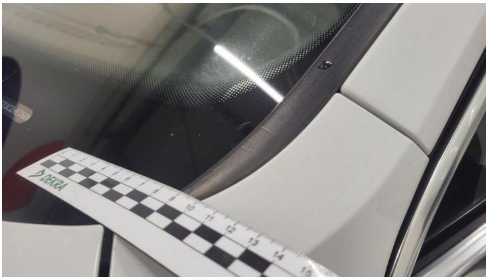
Fot. 77. Uszczelka/listwa szyby czołowej - Wgniecenie/odkształcenie 2
