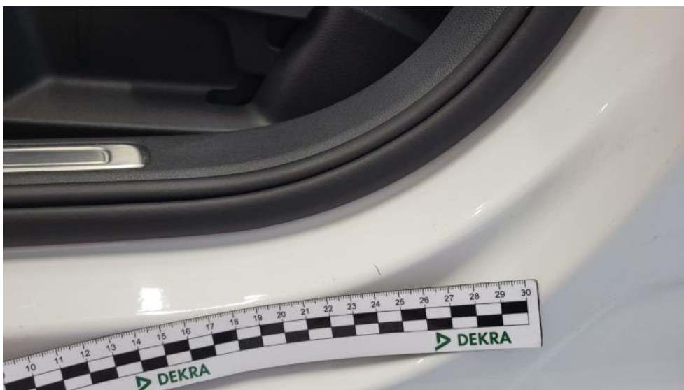
Fot. 90. Próg L - Rysa/odprysk 1
