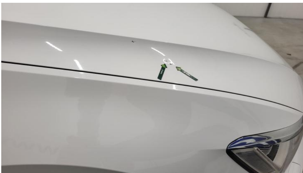
Fot. 61. Pokrywa komory silnika - Wgniecenie/odkształcenie 1
