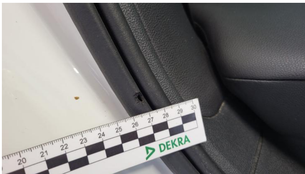
Fot. 97. Uszczelka drzwi tylnych P - Pęknięcie/rozerwanie 1
