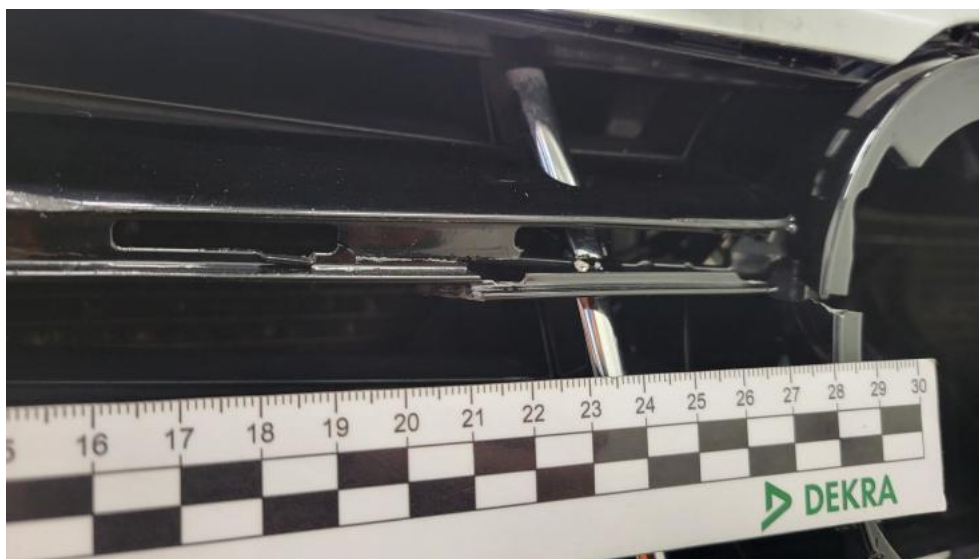
Fot. 51. Atrapa przednia - Pęknięcie/rozerwanie 2
