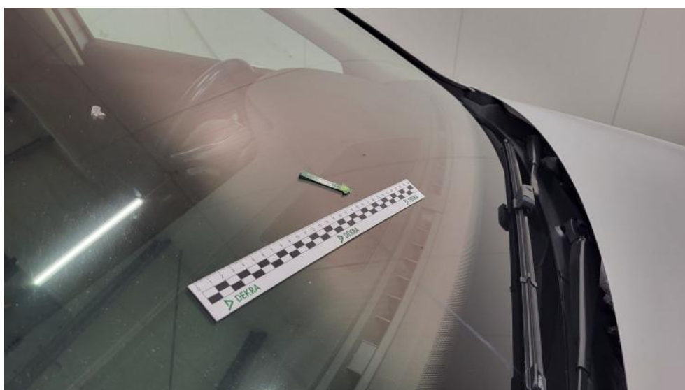
Fot. 74. Szyba czołowa() - Rysa/odprysk 3
