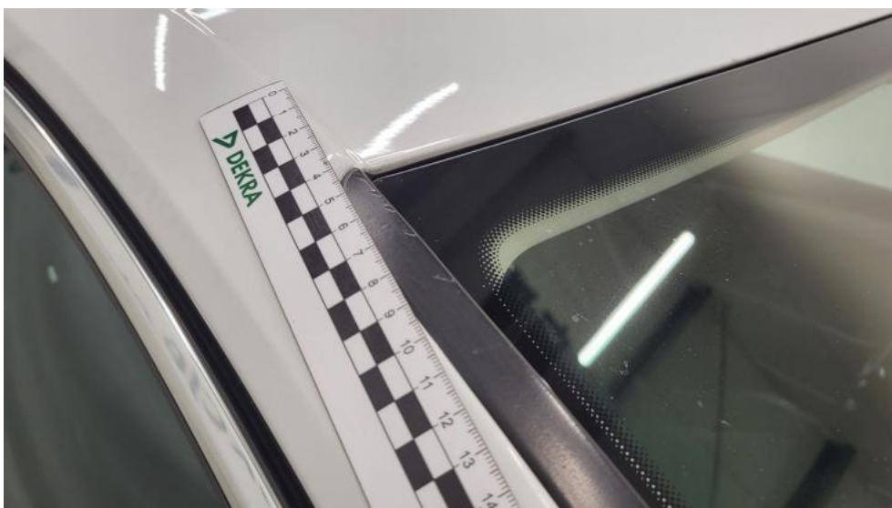
Fot. 78. Uszczelka/listwa szyby czołowej() - Wgniecenie/odkształcenie 3
