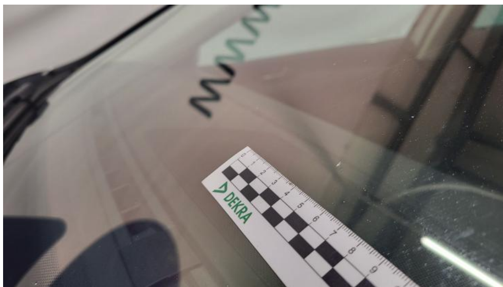
Fot. 73. Szyba czołowa - Rysa/odprysk 2
