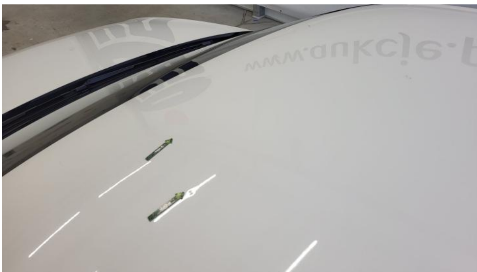
Fot. 88. Dach - Wgniecenie/odkształcenie 2
