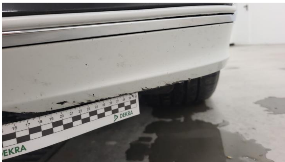
Fot. 64. Spoiler zderzaka przedniego - Rysa/odprysk 1
