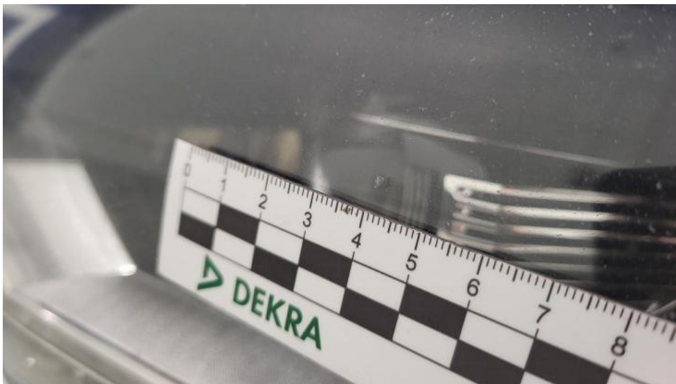
Fot. 91. Reflektor L - Rysa/odprysk 1
