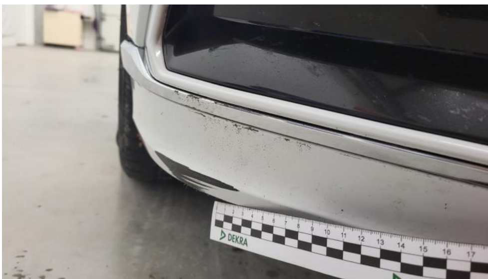
Fot. 65. Spoiler zderzaka przedniego - Rysa/odprysk 2
