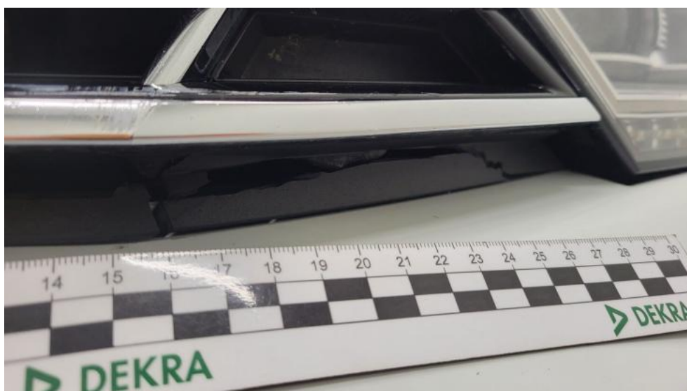
Fot. 52. Atrapa przednia() - Pęknięcie/rozerwanie 3
