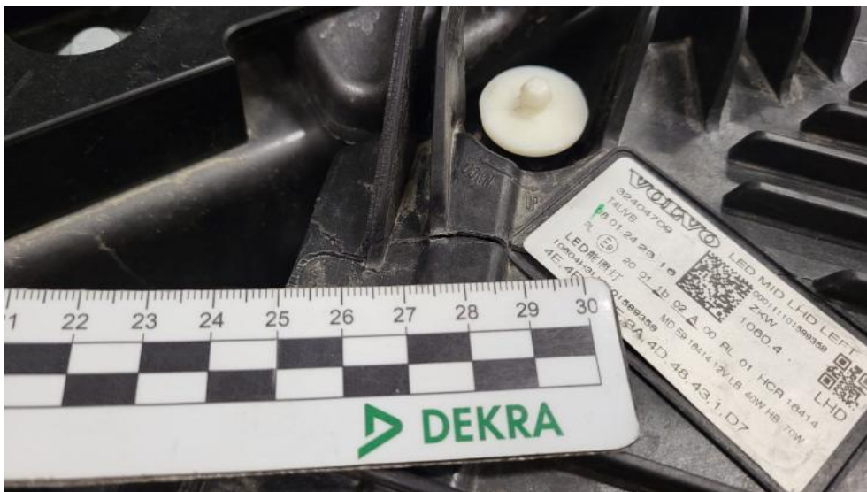
Photo 56. Reflektor L - Pęknięcie/rozerwanie 2
