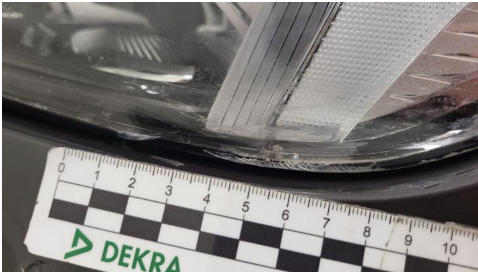
Photo 55. Reflektor L - Pęknięcie/rozerwanie 1
