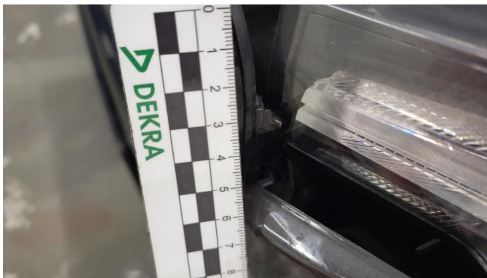
Photo 57. Reflektor L() - Pęknięcie/rozerwanie 3
