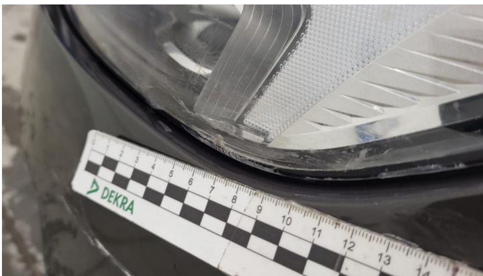
Photo 54. Reflektor L - Rysa/odprysk 1
