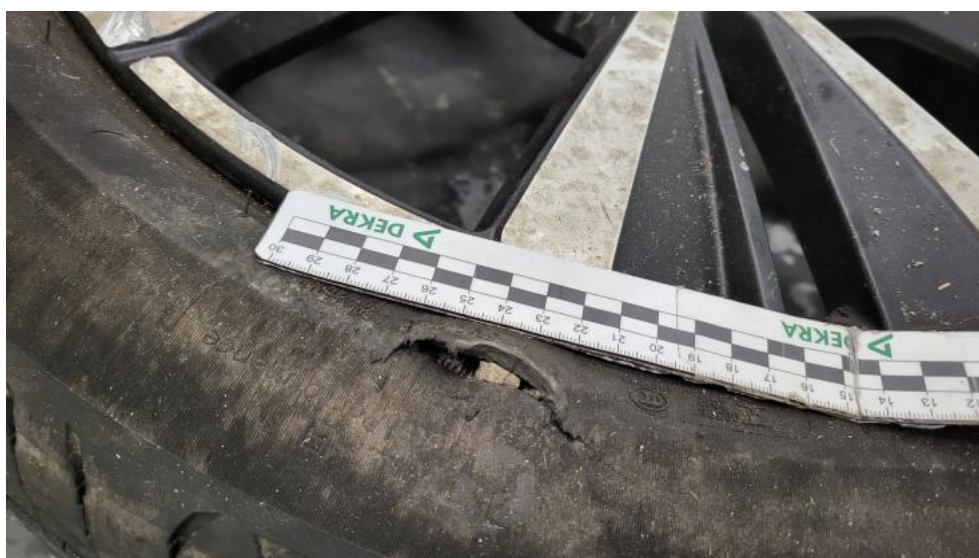
Photo 48. Opona przednia P - Pęknięcie/rozerwanie 1
