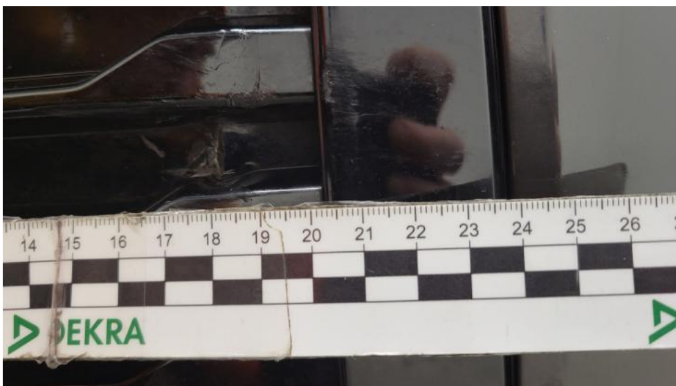
Photo 40. Kratka/zaślepka halogenu L - Pęknięcie/rozerwanie 1
