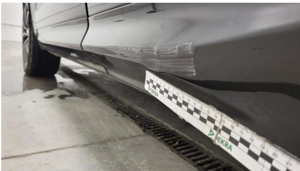
Photo 53. Listwa drzwi tylnych L - Wgniecenie/odkształcenie 1
