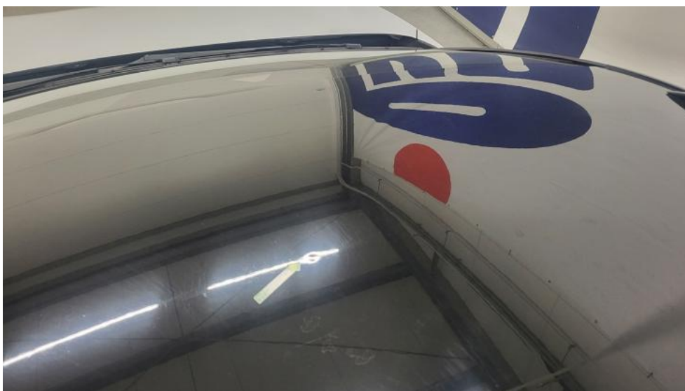
Fot. 54. Dach - Wgniecenie/odkształcenie 2
