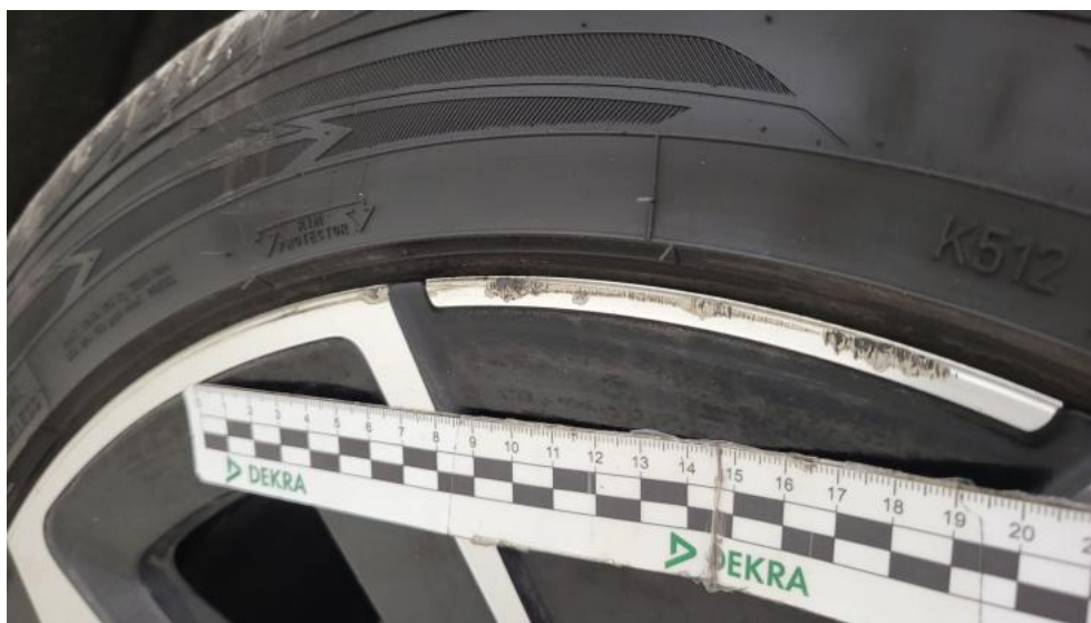
Fot. 51. Felga aluminiowa tylna P - Rysa/odprysk 1
