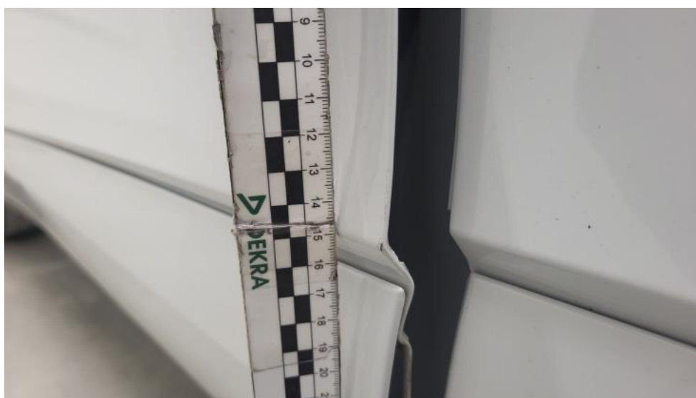
Fot. 56. Drzwi przed L - Rysa/odprysk 1
