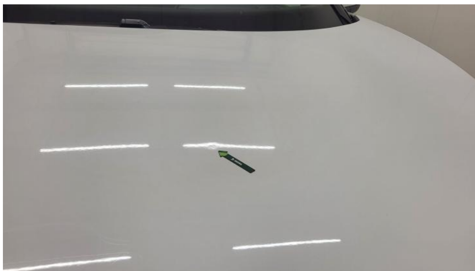
Fot. 43. Pokrywa komory silnika - Wgniecenie/odkształcenie 1
