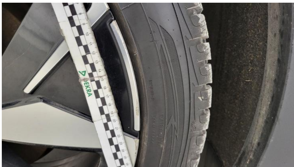
Fot. 52. Felga aluminiowa tylna P - Rysa/odprysk 2
