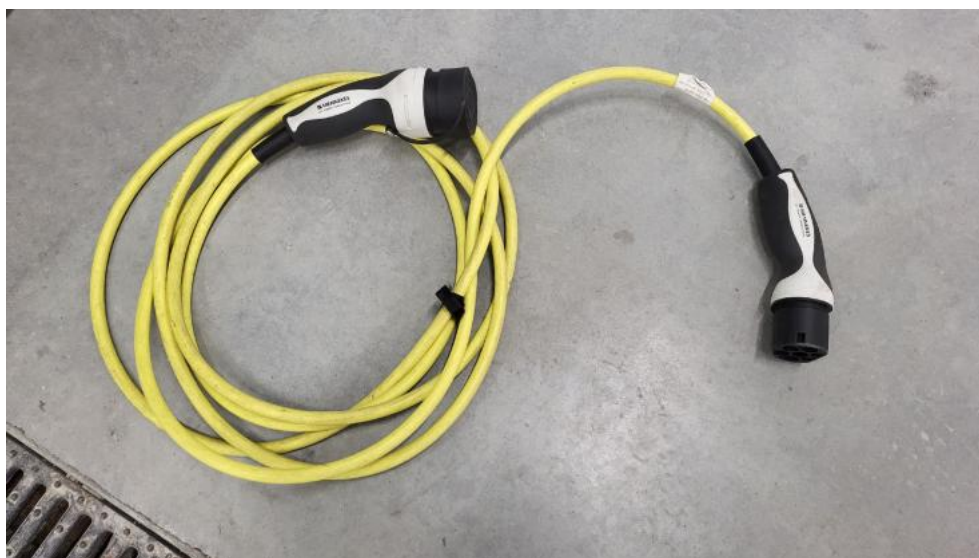
Fot. 34. Przewód ładowania baterii trakcyjnej
