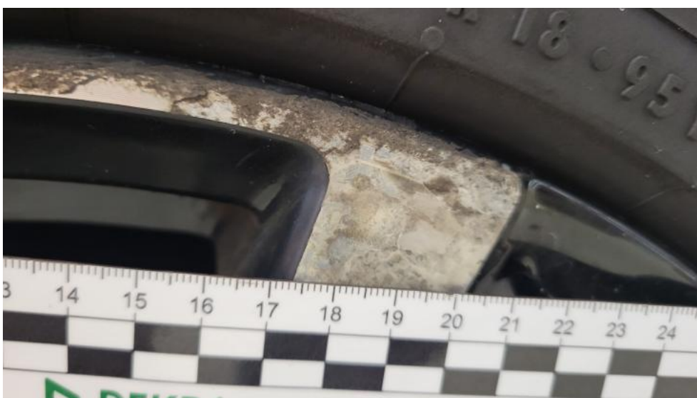
Fot. 62. Felga aluminiowa przednia P - Rysa/odprysk 1
