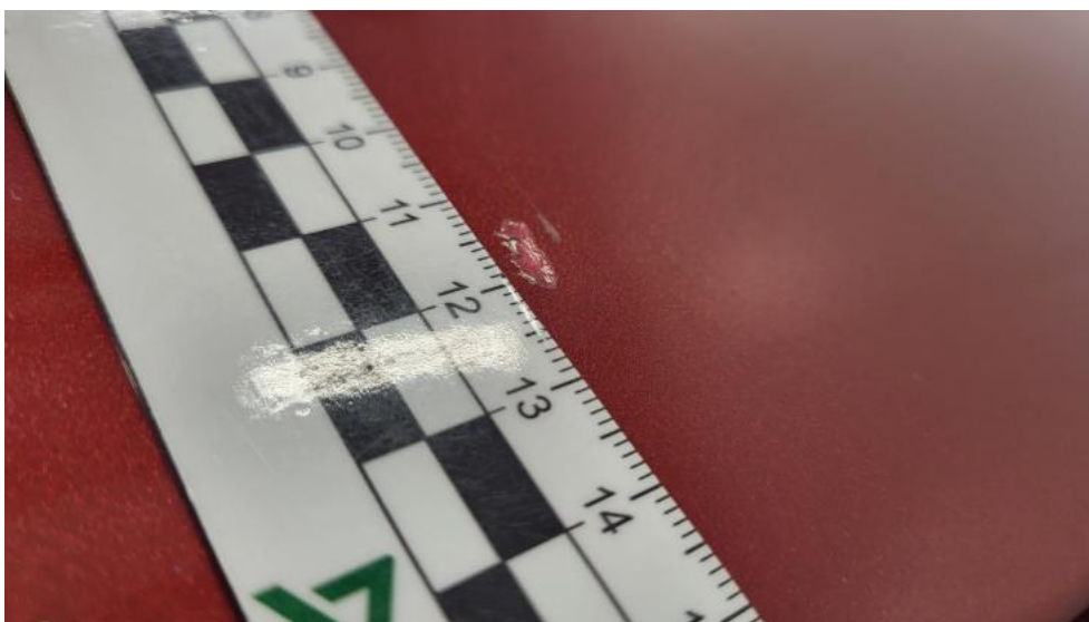
Fot. 48. Pokrywa komory silnika - Rysa/odprysk 2
