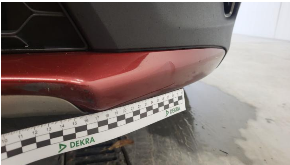
Fot. 59. Zderzak - Wgniecenie/odkształcenie 1
