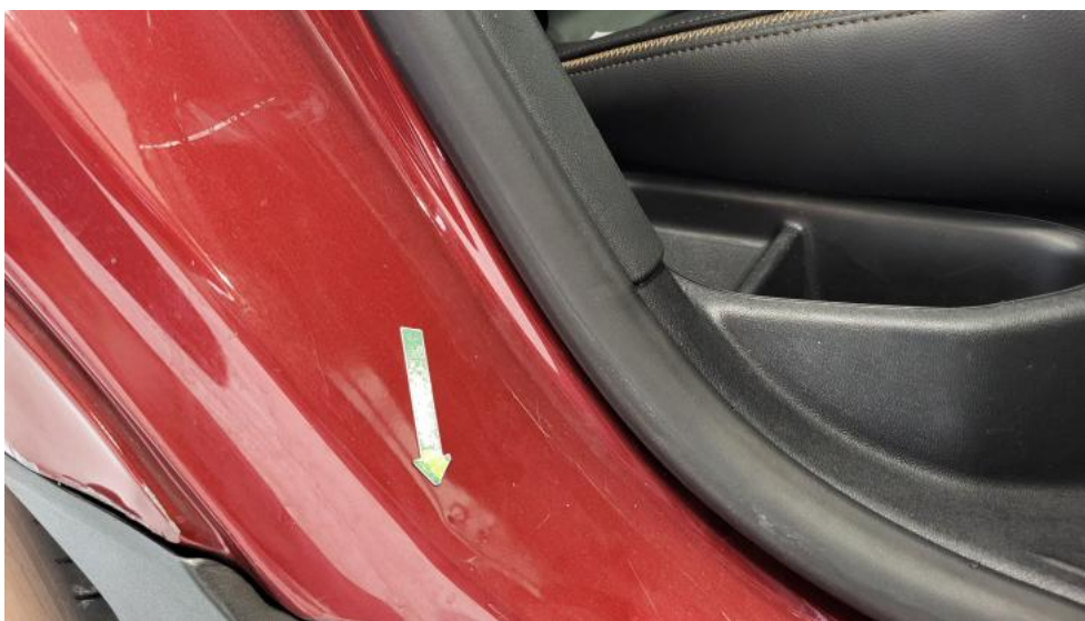
Fot. 79. Błotnik tylny P / Ściana boczna P - Wgniecenie/odkształcenie 2
