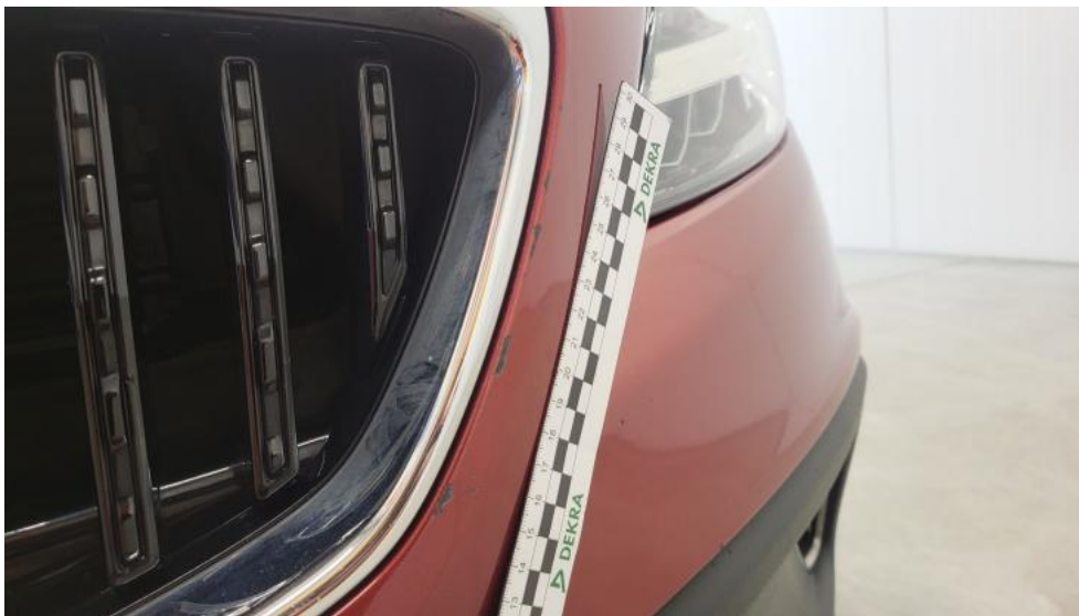
Fot. 57. Zderzak - Rysa/odprysk 2
