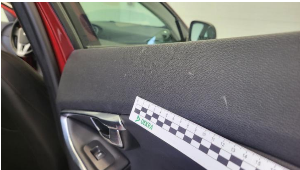
Fot. 131. Tapicerka drzwi tylnych P - Rysa/odprysk 1
