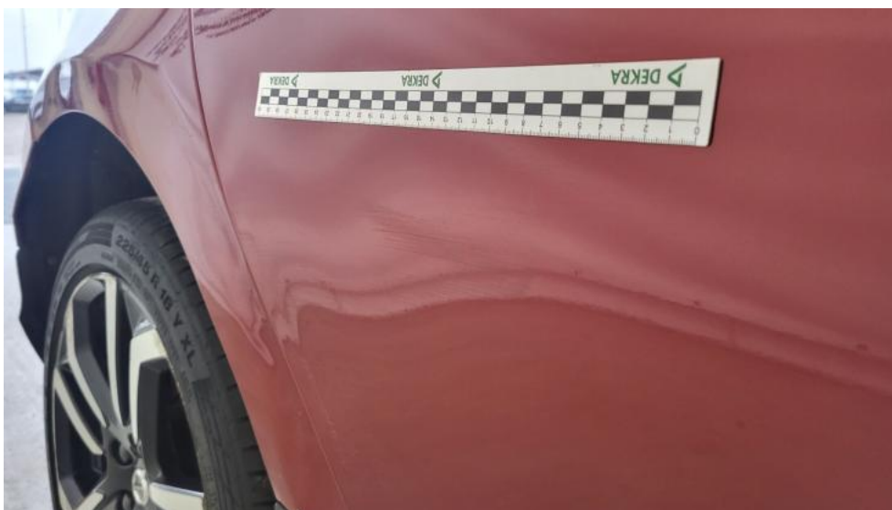
Fot. 69. Drzwi tylne P - Rysa/odprysk 2
