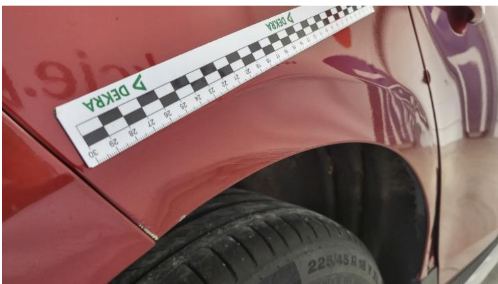
Fot. 76. Błotnik tylny P / Ściana boczna P - Rysa/odprysk 2
