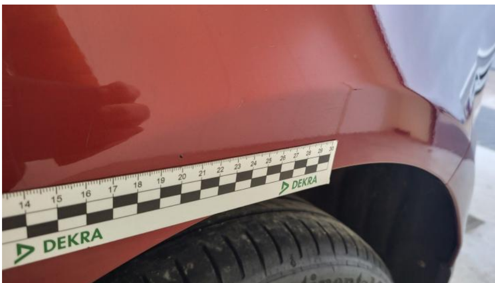
Fot. 98. Błotnik tylny L / Ściana boczna L - Rysa/odprysk 1
