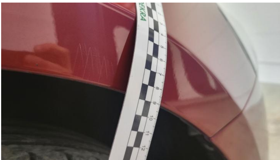
Fot. 61. Błotnik przedni P - Rysa/odprysk 1
