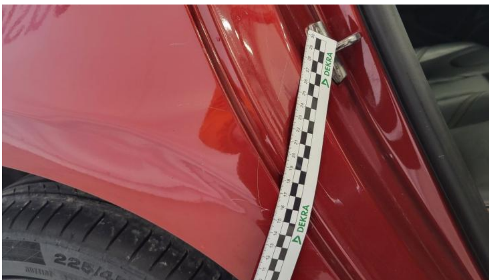
Fot. 75. Błotnik tylny P / Ściana boczna P - Rysa/odprysk 1
