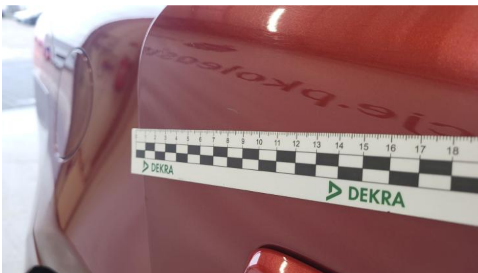
Fot. 70. Drzwi tylne P() - Rysa/odprysk 3
