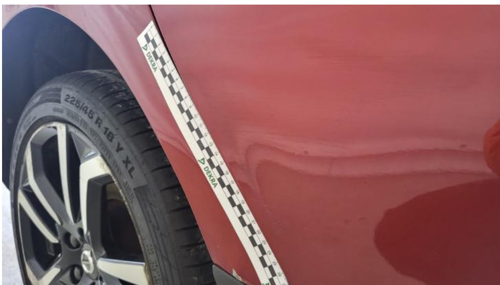
Fot. 68. Drzwi tylne P - Rysa/odprysk 1
