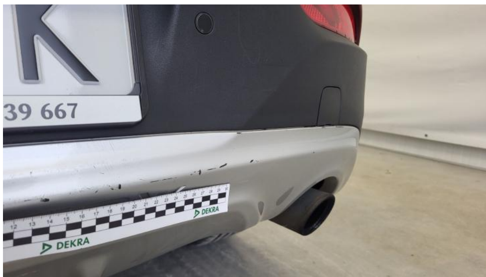
Fot. 87. Spojler zderzaka tylnego - Rysa/odprysk 1
