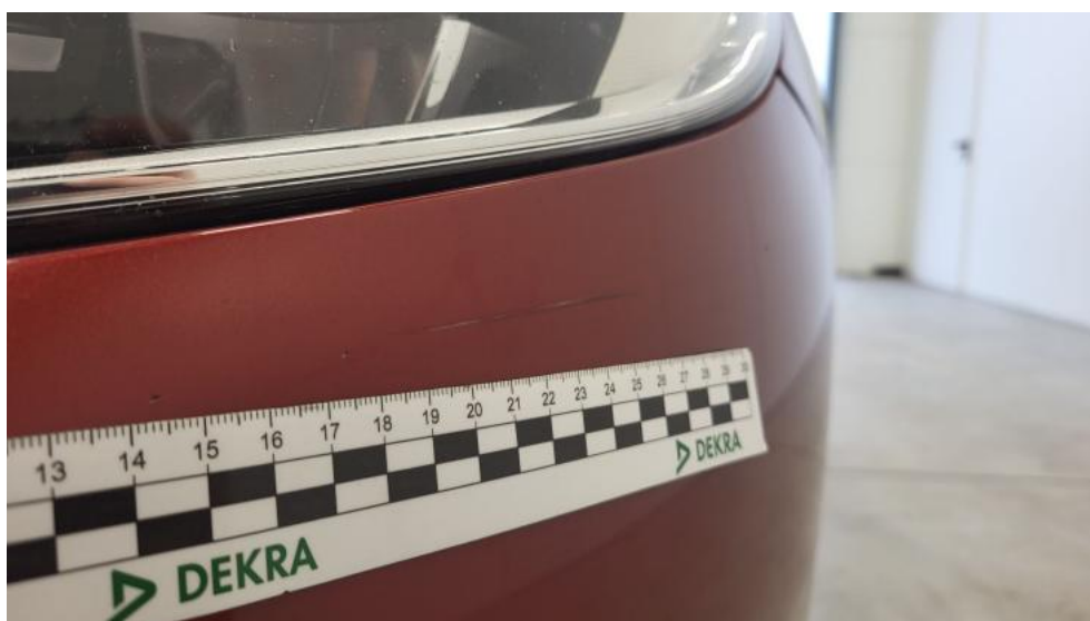
Fot. 56. Zderzak - Rysa/odprysk 1
