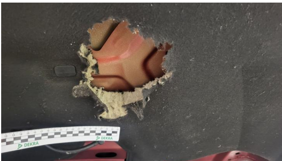
Fot. 54. Wykładzina pokrywy komory silnika - Pęknięcie/rozerwanie 1
