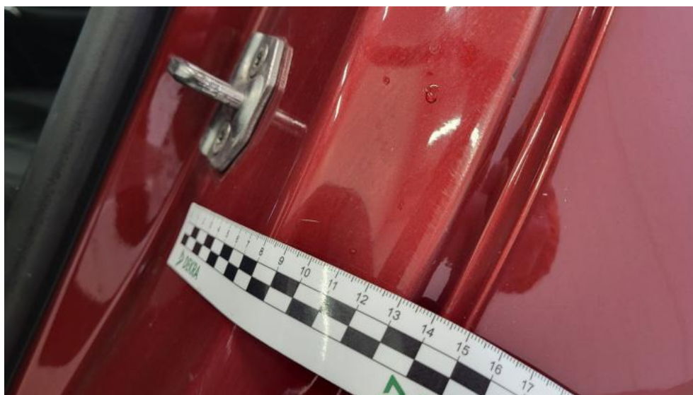
Fot. 99. Błotnik tylny L / Ściana boczna L - Rysa/odprysk 2
