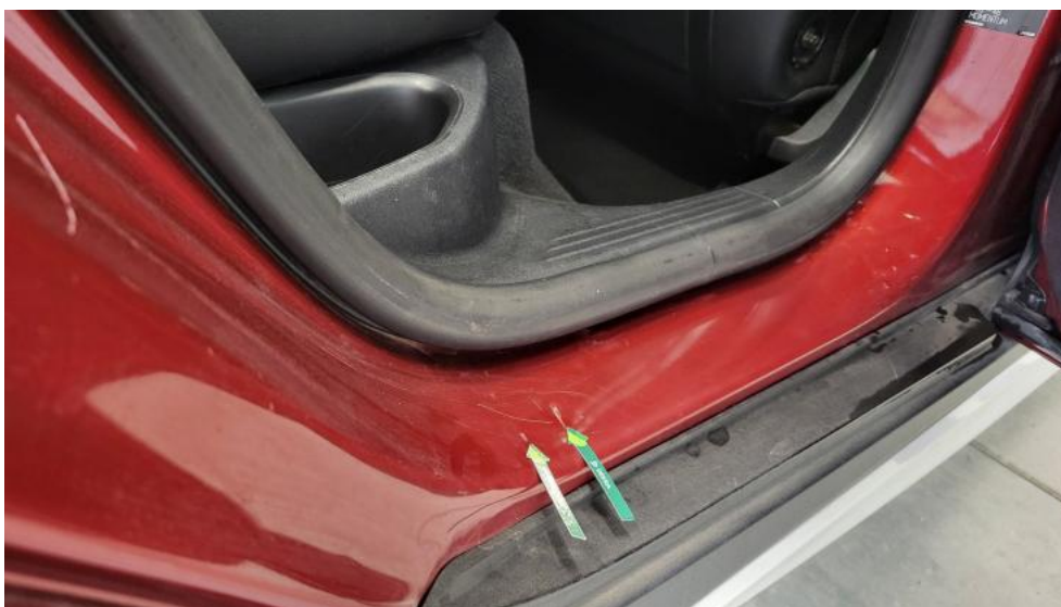
Fot. 73. Próg P - Wgniecenie/odkształcenie 1
