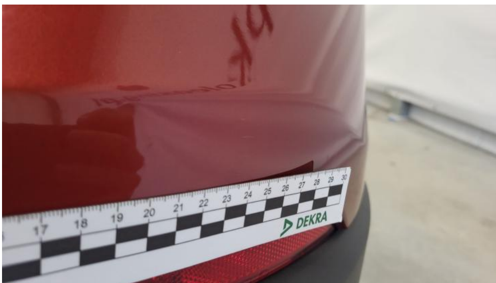
Fot. 92. Zderzak tylny - Rysa/odprysk 2
