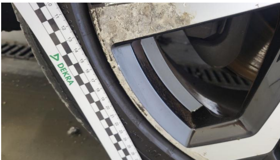
Fot. 121. Felga Aluminiowa przednia L - Rysa/odprysk 2
