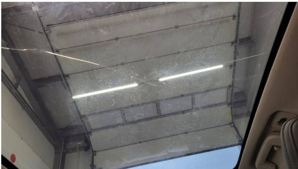
Fot. 97. Szyberdach() - Pęknięcie/rozerwanie 3
