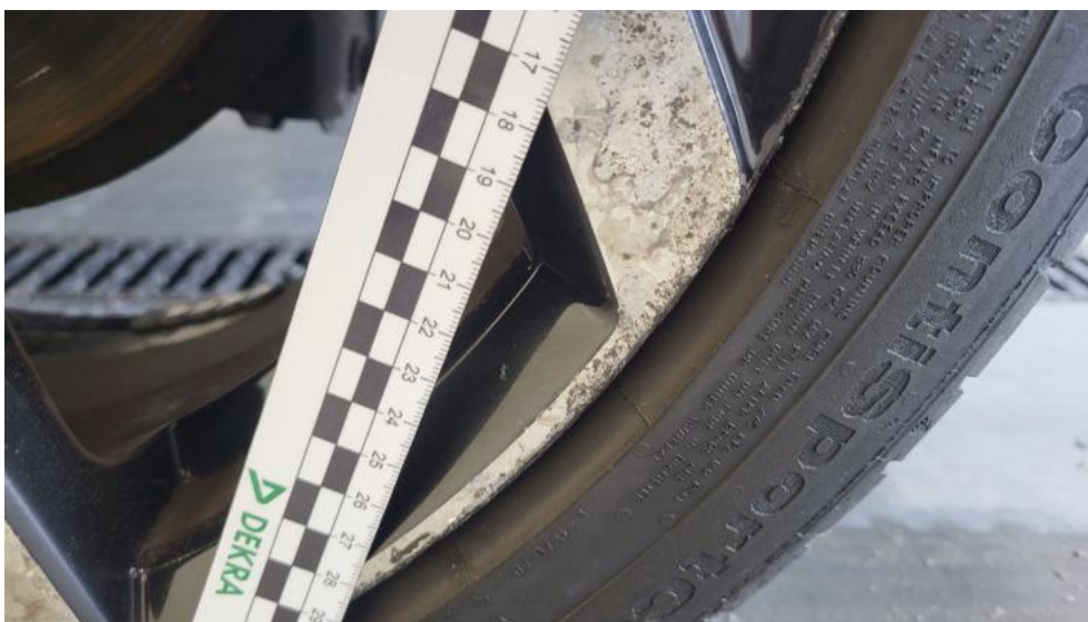
Fot. 105. Felga aluminiowa tylna L - Rysa/odprysk 2
