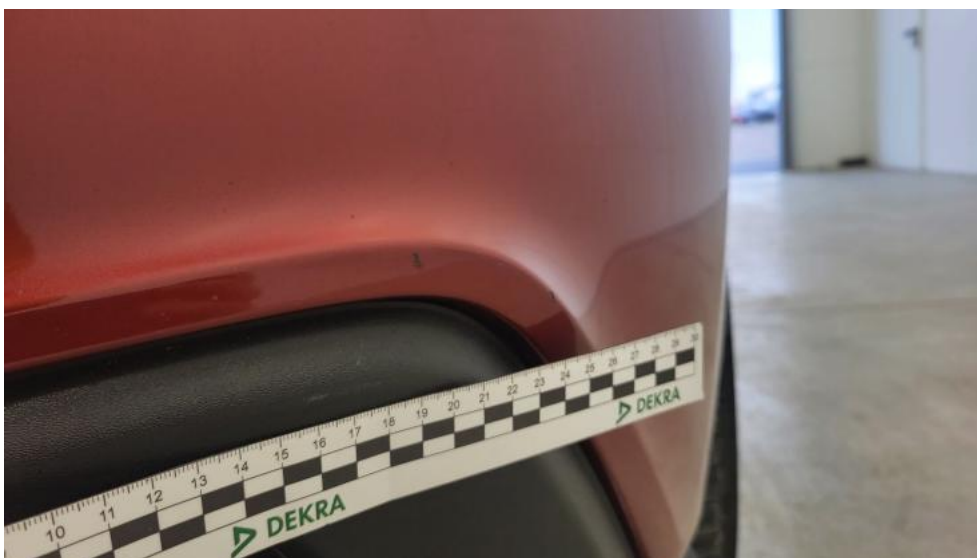
Fot. 58. Zderzak() - Rysa/odprysk 3
