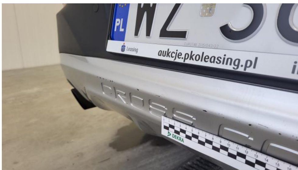
Fot. 88. Spojler zderzaka tylnego - Rysa/odprysk 2
