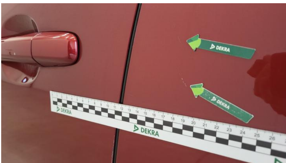
Fot. 114. Drzwi tylne L - Rysa/odprysk 2
