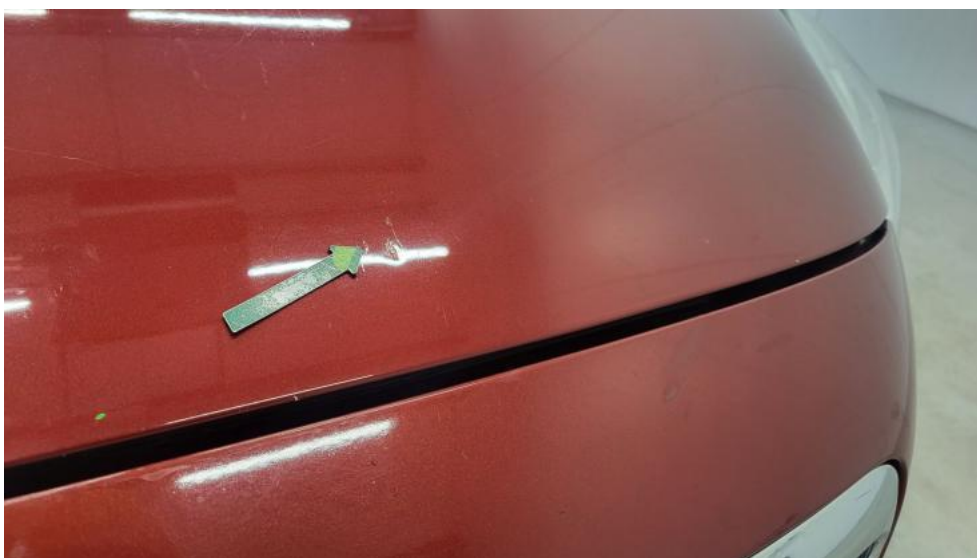
Fot. 50. Pokrywa komory silnika - Wgniecenie/odkształcenie 1
