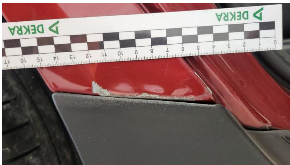
Fot. 77. Błotnik tylny P / Ściana boczna P() - Rysa/odprysk 3
