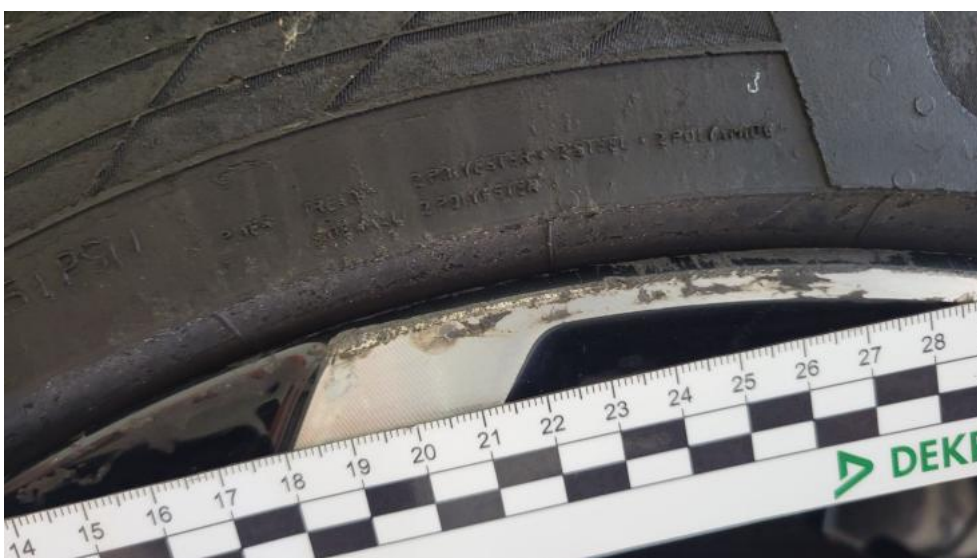
Fot. 106. Felga aluminiowa tylna L() - Rysa/odprysk 3
