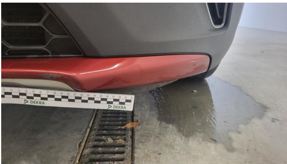
Fot. 60. Zderzak - Wgniecenie/odkształcenie 2
