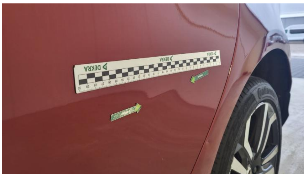
Fot. 116. Drzwi tylne L - Wgniecenie/odkształcenie 1
