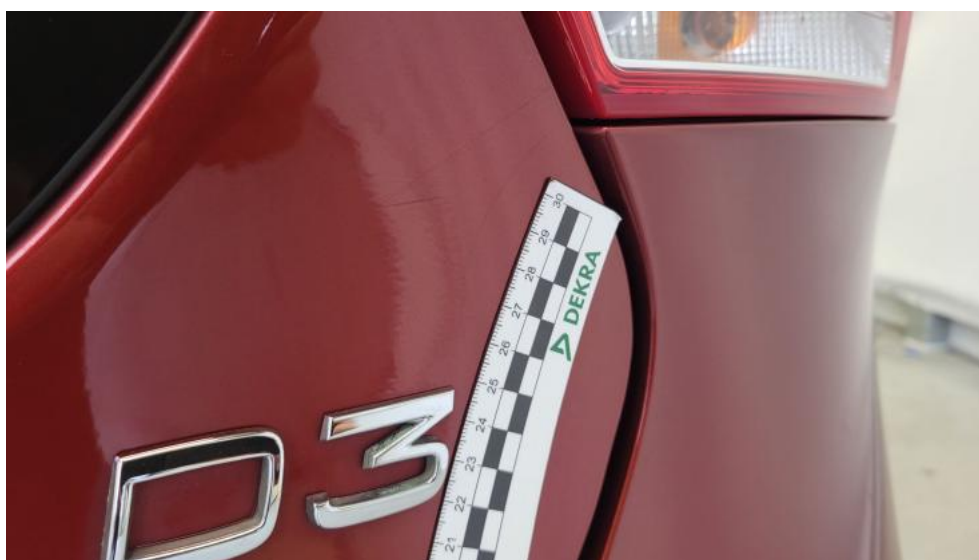
Fot. 84. Pokrywy bagażnika - Rysa/odprysk 1
