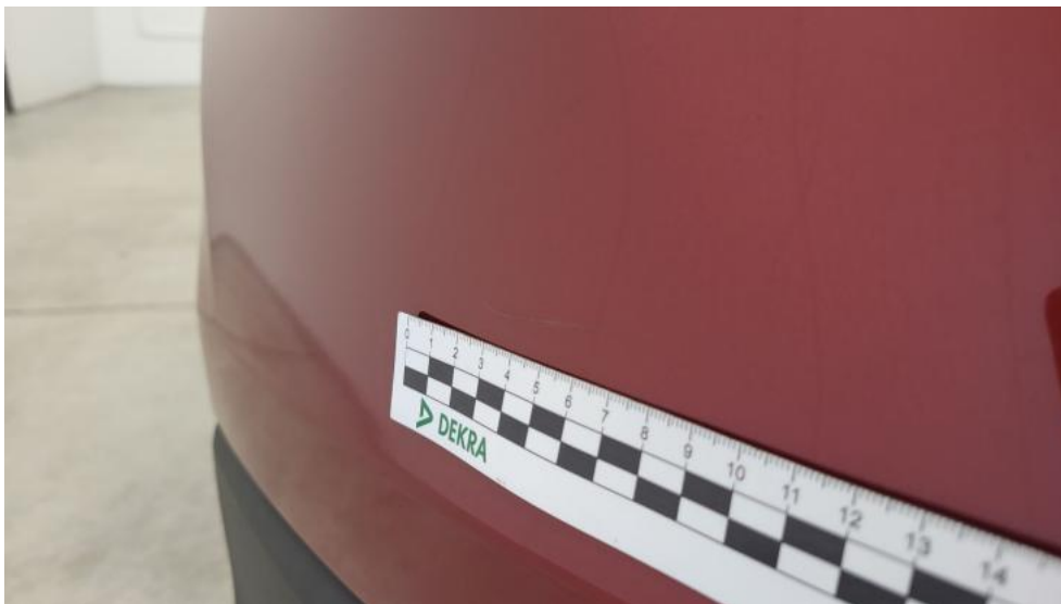
Fot. 93. Zderzak tylny() - Rysa/odprysk 3
