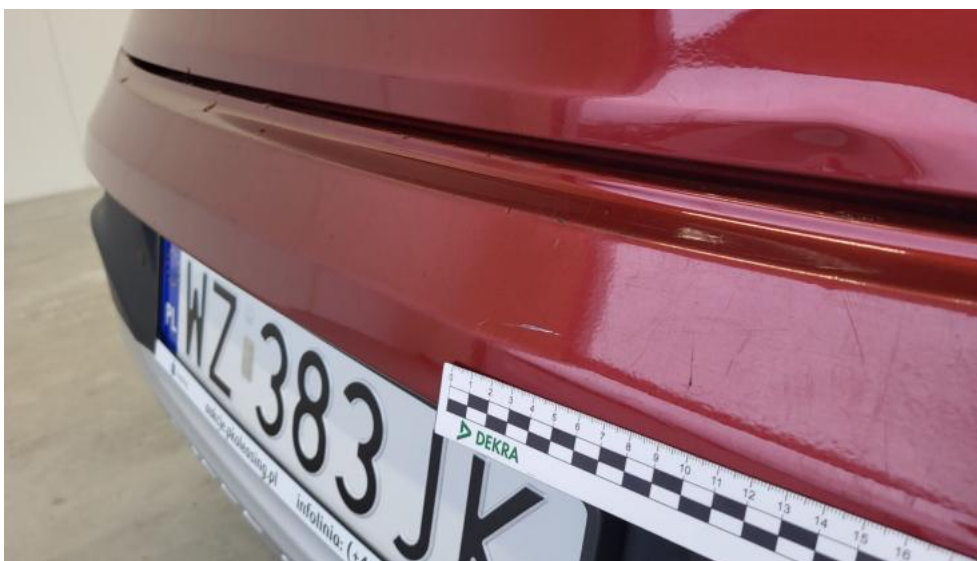
Fot. 91. Zderzak tylny - Rysa/odprysk 1
