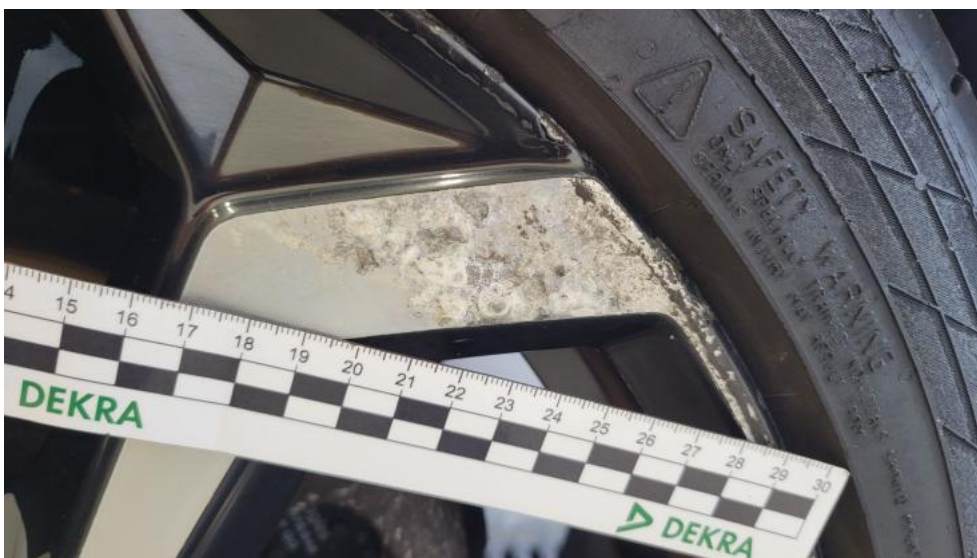
Fot. 104. Felga aluminiowa tylna L - Rysa/odprysk 1
