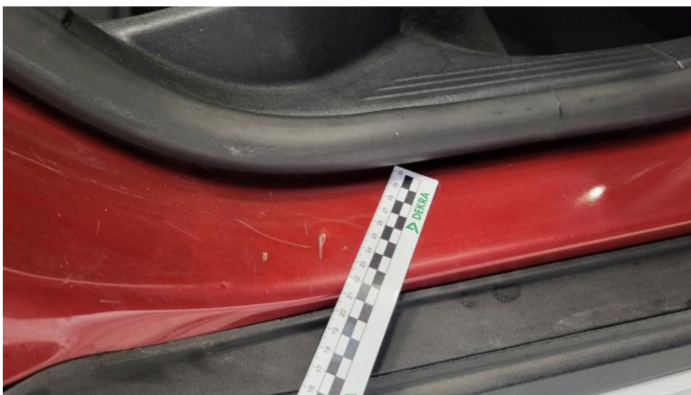
Fot. 72. Próg P - Rysa/odprysk 1
