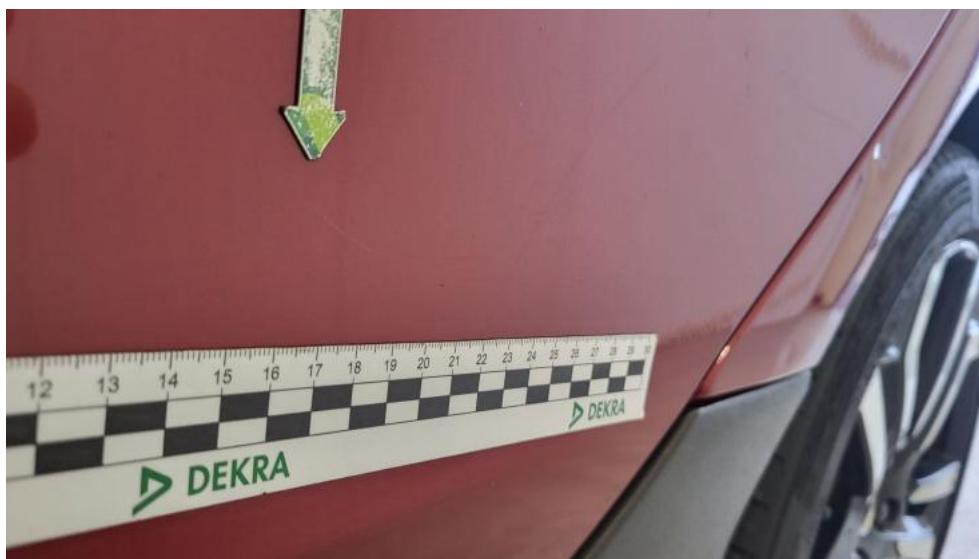
Fot. 115. Drzwi tylne L() - Rysa/odprysk 3
