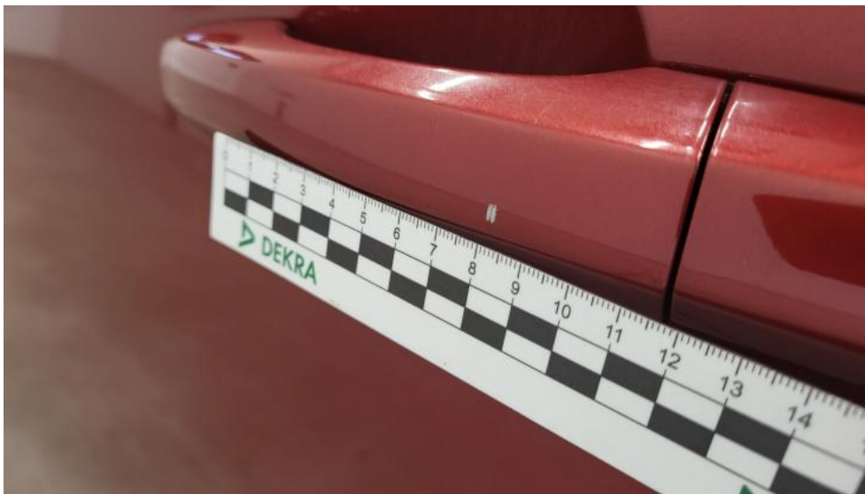
Fot. 117. Klamka drzwi prz L - Rysa/odprysk 1
