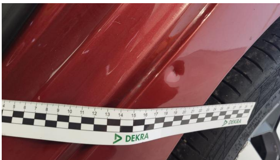
Fot. 100. Błotnik tylny L / Ściana boczna L() - Rysa/odprysk 3
