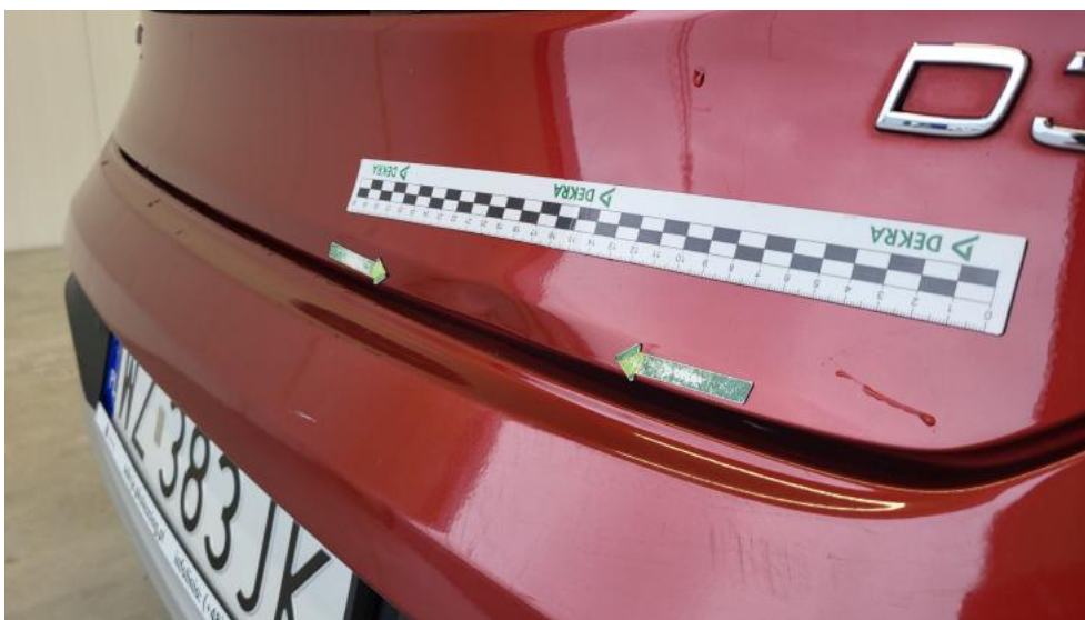
Fot. 86. Pokrywy bagażnika - Wgniecenie/odkształcenie 1
