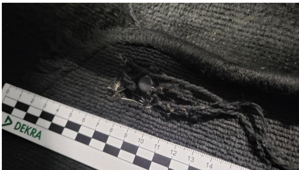
Fot. 140. Dywanik prze L - Pęknięcie/rozerwanie 1
