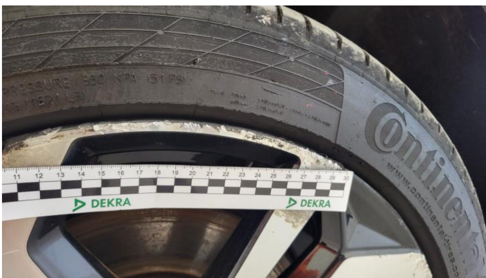
Fot. 120. Felga Aluminiowa przednia L - Rysa/odprysk 1
