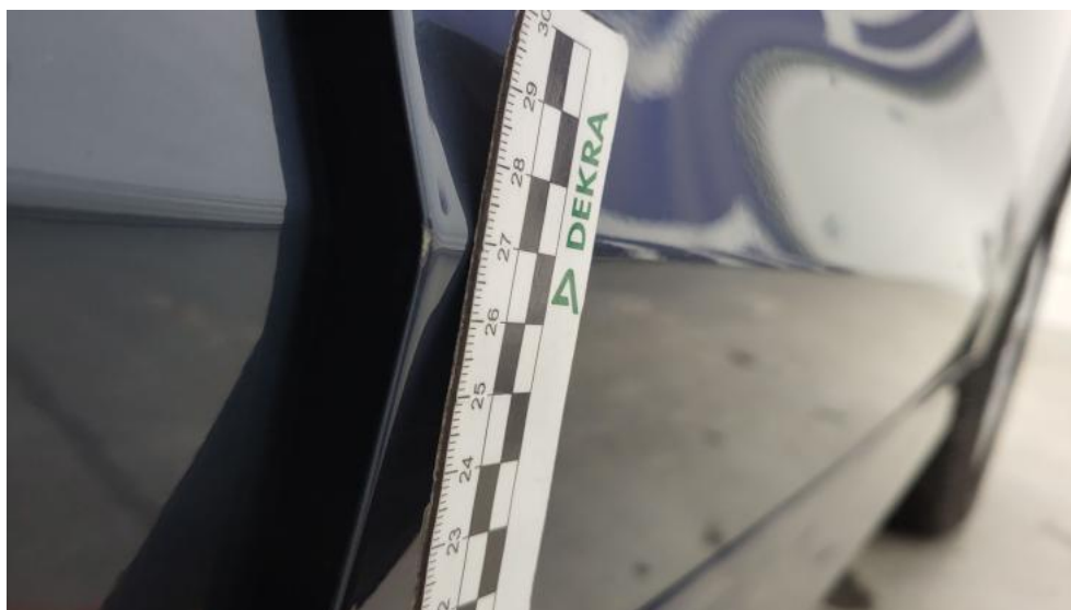
Fot. 56. Drzwi przednie P - Rysa/odprysk 1
