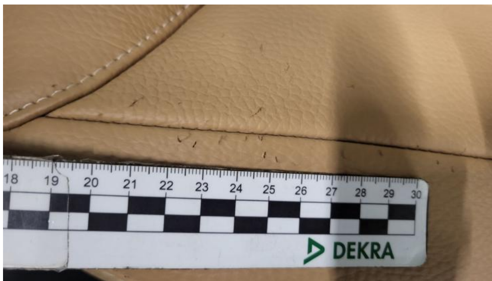
Fot. 67. Kanapa tyl. - Pęknięcie/rozerwanie 1
