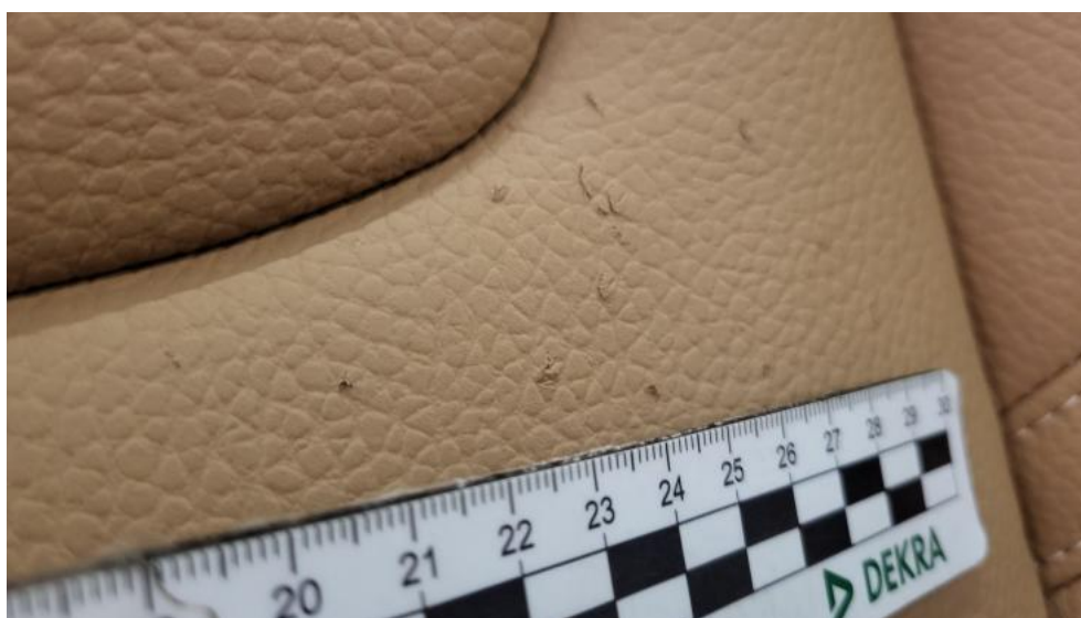
Fot. 68. Kanapa tyl. - Pęknięcie/rozerwanie 2
