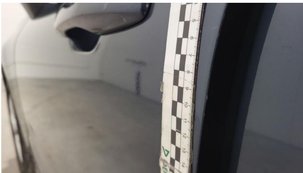
Fot. 62. Drzwi przed L - Rysa/odprysk 2
