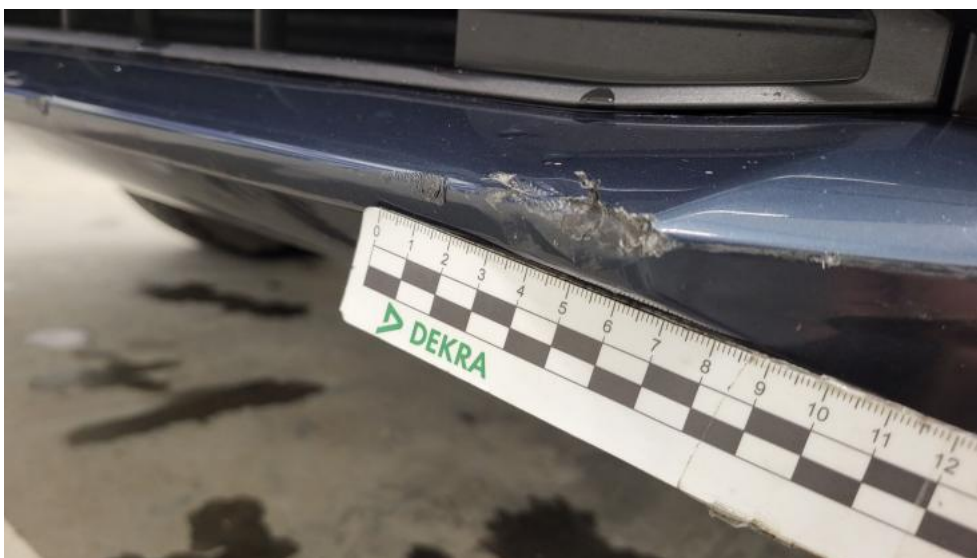
Fot. 54. Zderzak przedni cz dolna - Pęknięcie/rozerwanie 1
