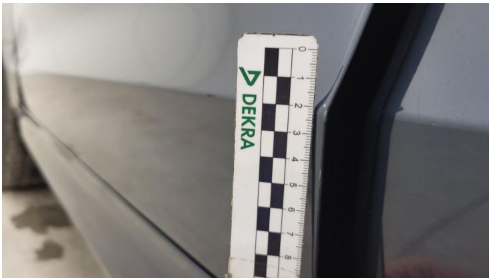
Fot. 61. Drzwi przed L - Rysa/odprysk 1
