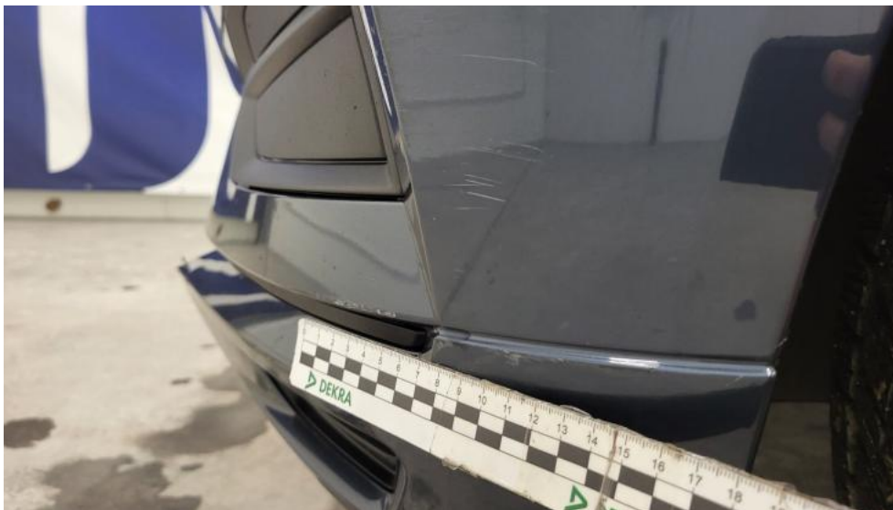
Fot. 45. Zderzak - Rysa/odprysk 1
