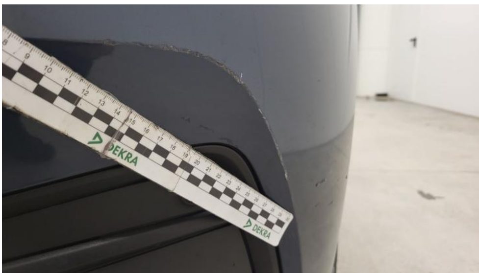
Fot. 46. Zderzak - Rysa/odprysk 2
