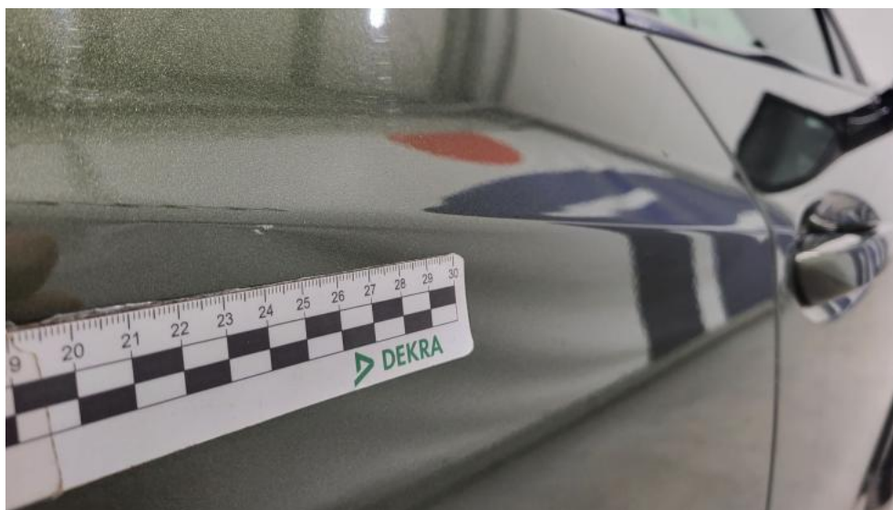
Photo 47. Drzwi tylne P - Rysa/odprysk 1
