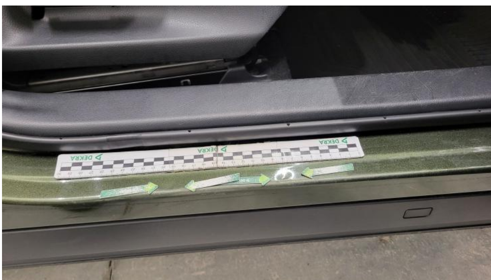
Photo 50. Próg P - Wgniecenie/odkształcenie 1
