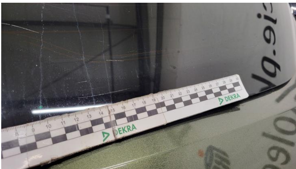
Photo 55. Szyba tylna - Rysa/odprysk 1
