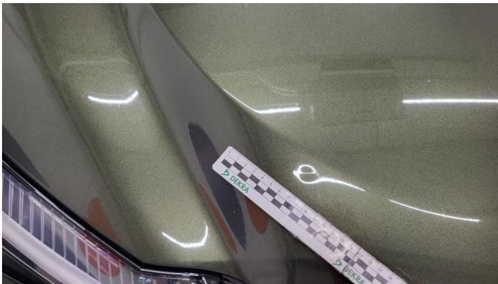
Photo 53. Pokrywy przód - Wgniecenie/odkształcenie 1
