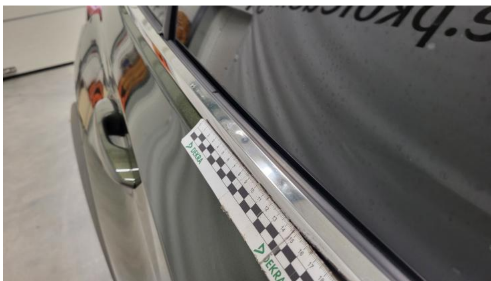
Photo 48. Listwa drzwi tylnych P - Wgniecenie/odkształcenie 1
