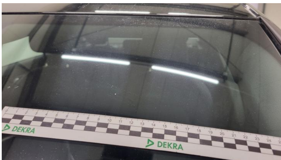
Fot. 50. Szyba czołowa - Rysa/odprysk 1
