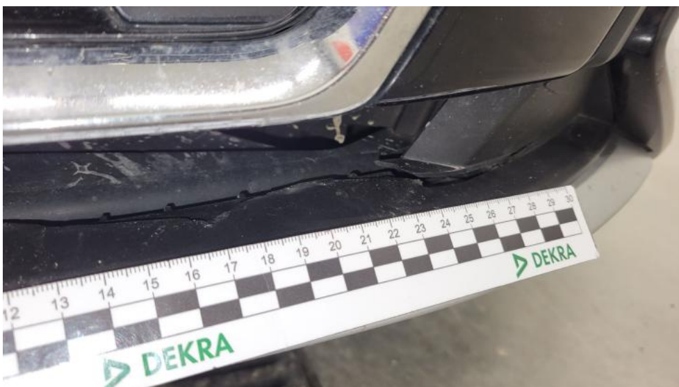
Fot. 44. Kratka zderzaka prz. - Pęknięcie/rozerwanie 1
