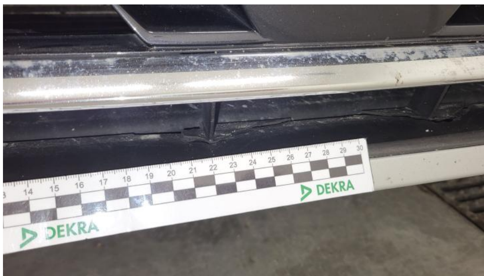
Fot. 46. Krata zderzaka prz.(.) - Pęknięcie/rozerwanie 3
