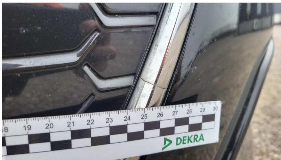
Fot. 41. Atrapa przednia - Pęknięcie/rozerwanie 1
