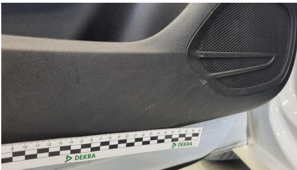
Photo 64. Tapicerka drzwi przednich L - Rysa/odprysk 2
