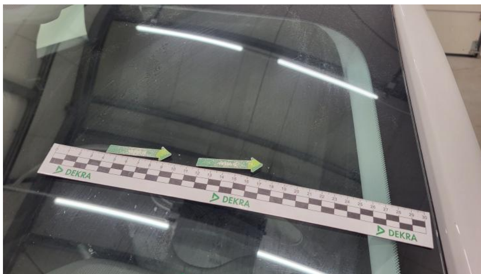
Photo 42. Szyba czołowa - Rysa/odprysk 1
