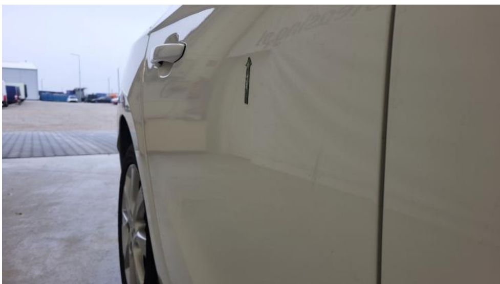
Photo 50. Drzwi tylne P - Wgniecenie/odkształcenie 1
