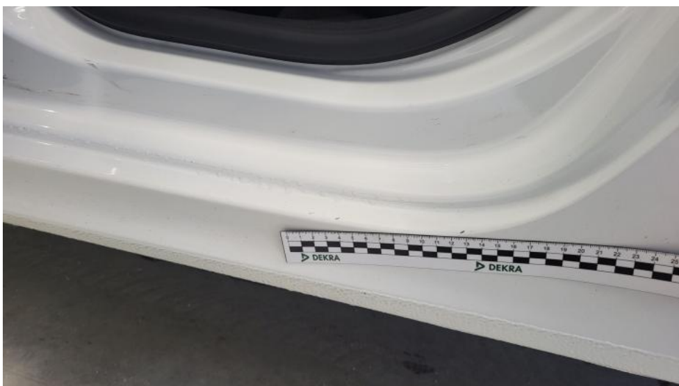
Photo 58. Próg L - Rysa/odprysk 1
