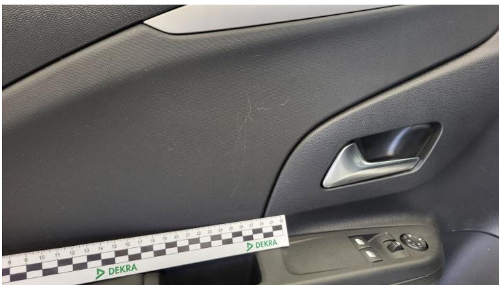
Photo 63. Tapicerka drzwi przednich L - Rysa/odprysk 1
