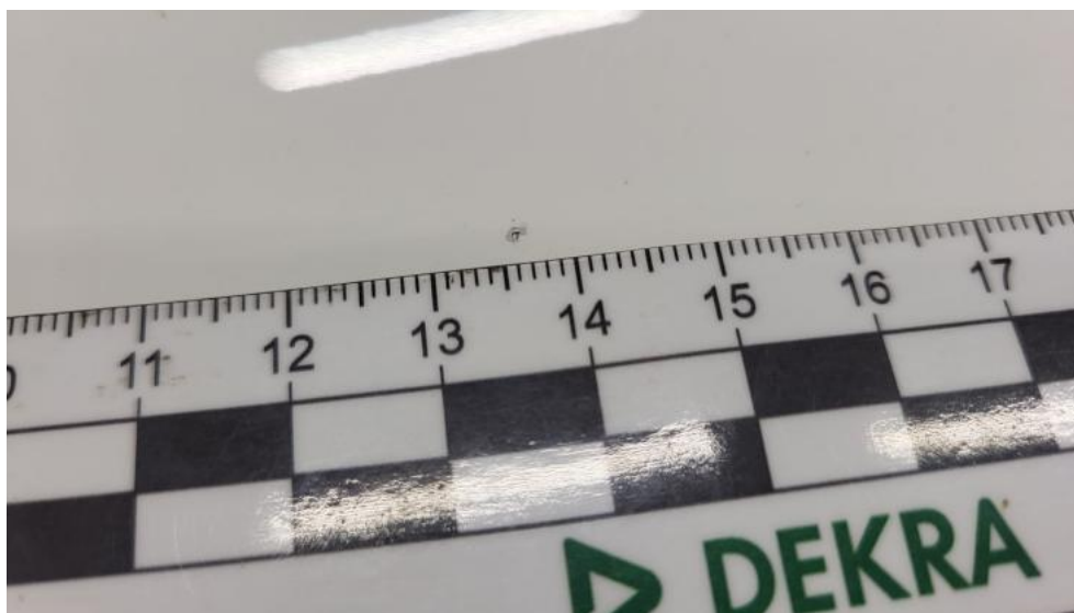
Photo 41. Pokrywa komory silnika() - Rysa/odprysk 3
