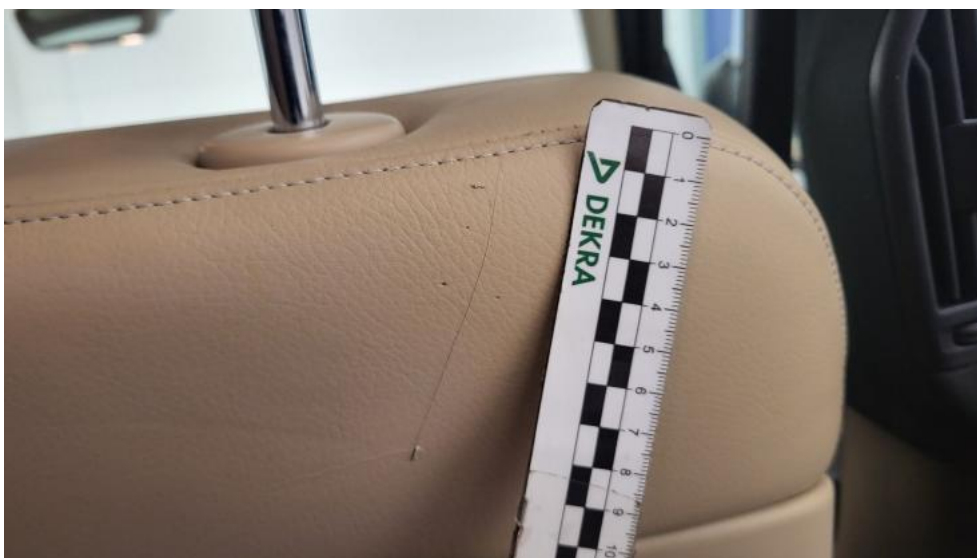
Photo 82. Fotel prz. praw. - Rysa/odprysk 1
