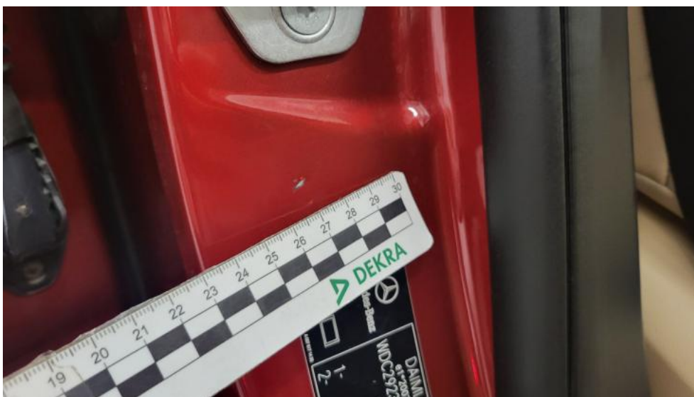
Photo 55. Słupek środkowy P - Rysa/odprysk 1
