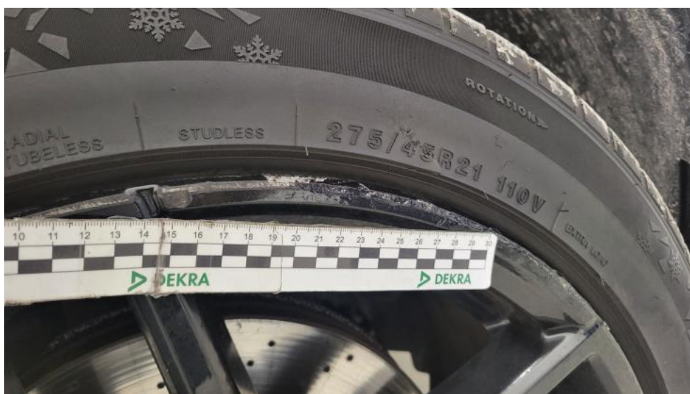
Photo 46. Felga aluminiowa przednia P - Rysa/odprysk 2
