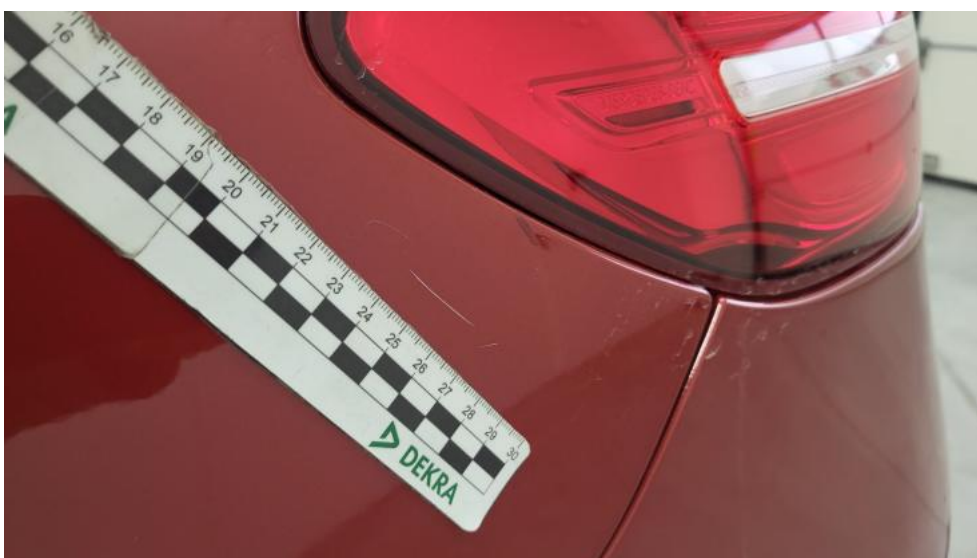
Photo 66. Błotnik tylny L / Ściana boczna L - Rysa/odprysk 2
