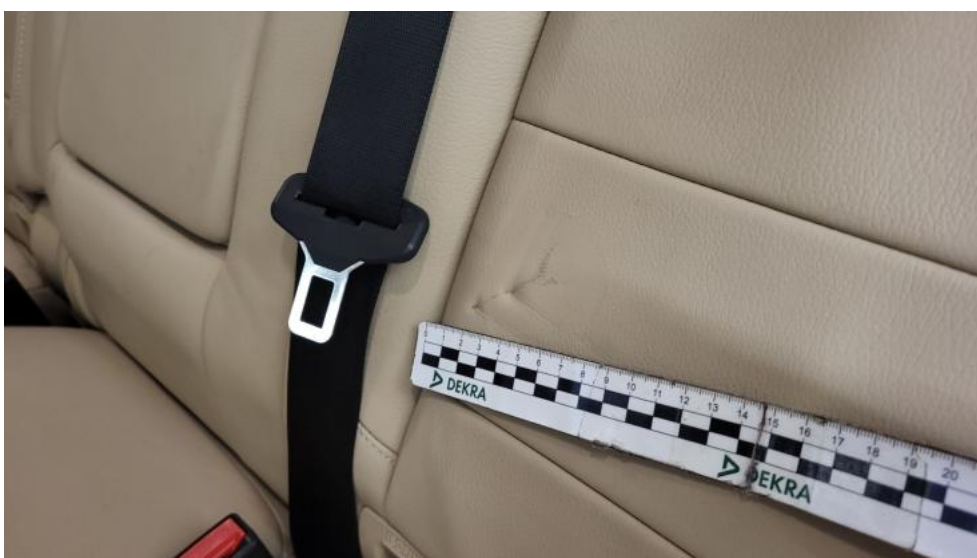
Photo 86. Kanapa tyl. - Wgniecenie/odkształcenie 1
