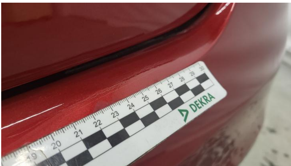
Photo 63. Zderzak tylny - Pęknięcie/rozerwanie 2
