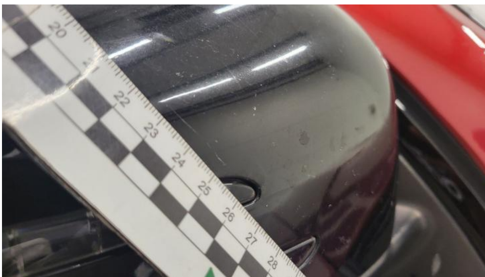
Photo 54. Lusterko zew P - Rysa/odprysk 1
