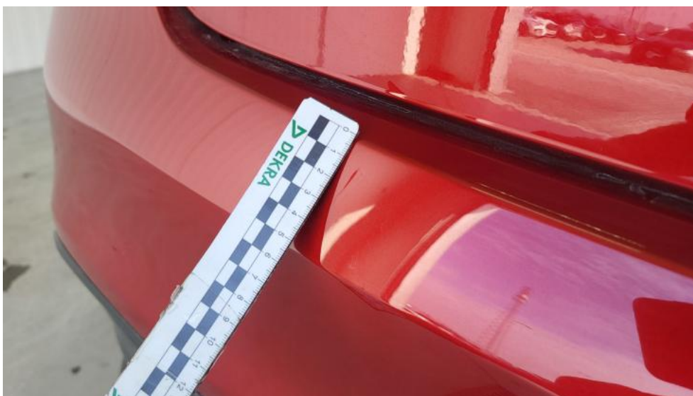
Photo 61. Zderzak tylny - Wgniecenie/odkształcenie 2
