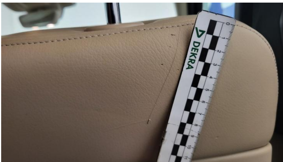
Photo 83. Fotel prz. praw. - Pęknięcie/rozerwanie 1
