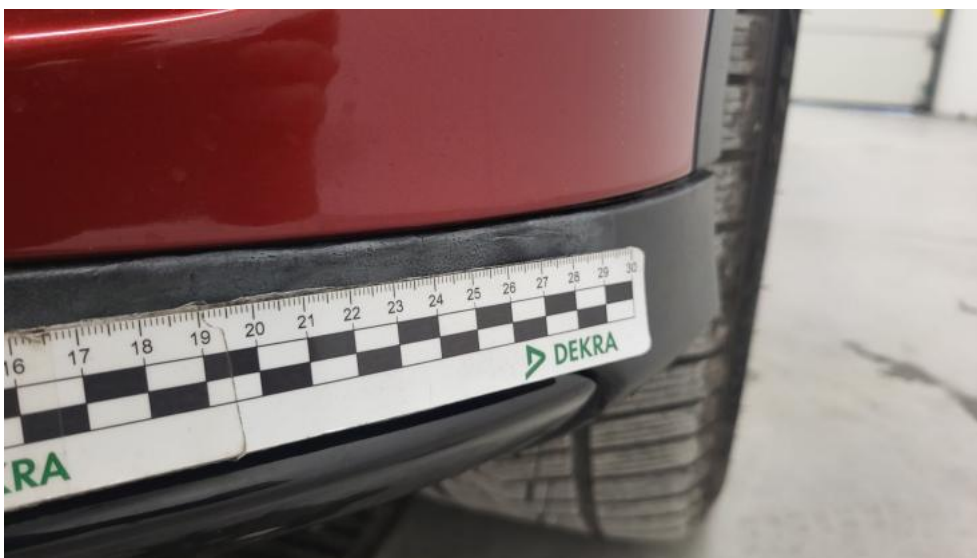
Photo 44. Zderzak przedni cz dolna - Rysa/odprysk 1
